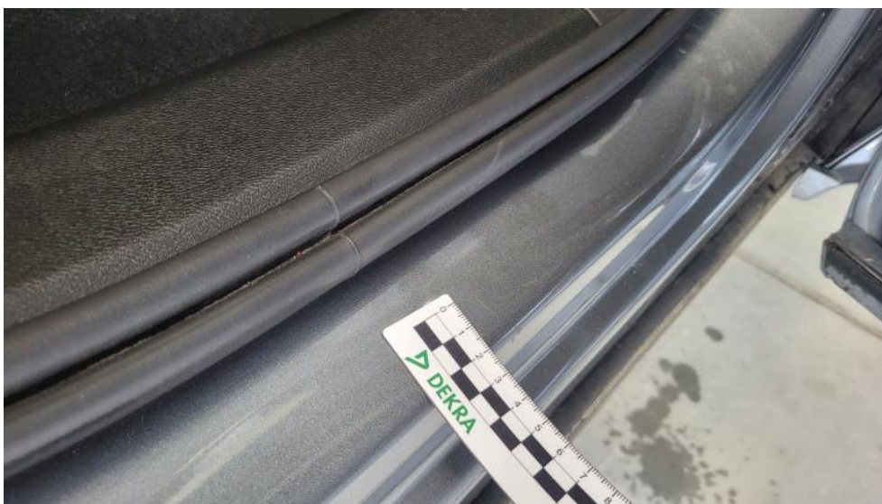
Fot. 48. Próg P - Rysa/odprysk 1
