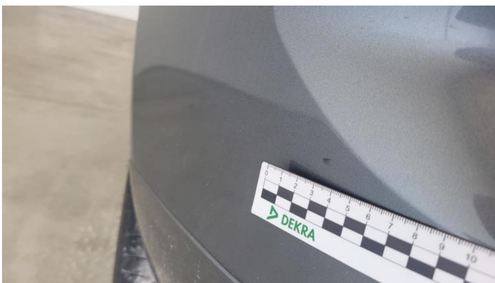
Fot. 52. Zderzak tylny - Rysa/odprysk 2
