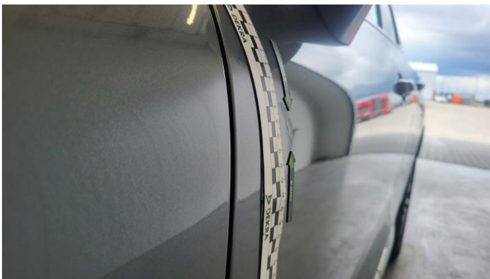
Fot. 56. Drzwi przed L - Wgniecenie/odkształcenie 1
