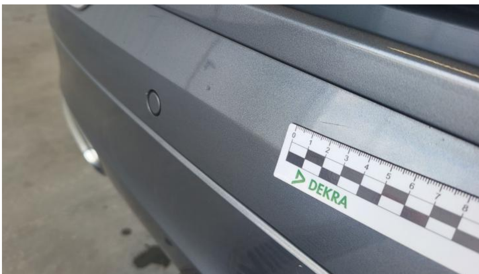
Fot. 51. Zderzak tylny - Rysa/odprysk 1
