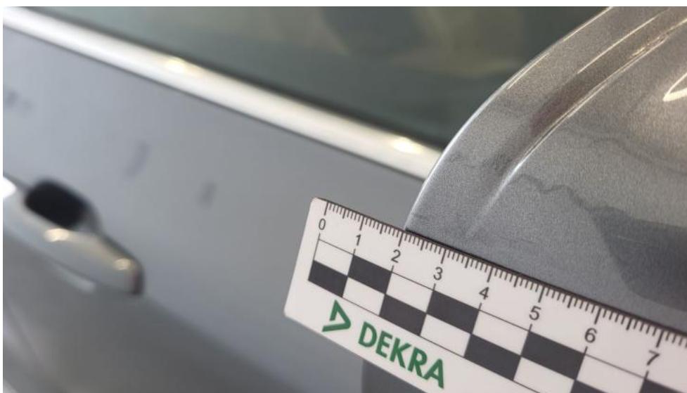
Fot. 47. Lusterko zew P - Rysa/odprysk 1
