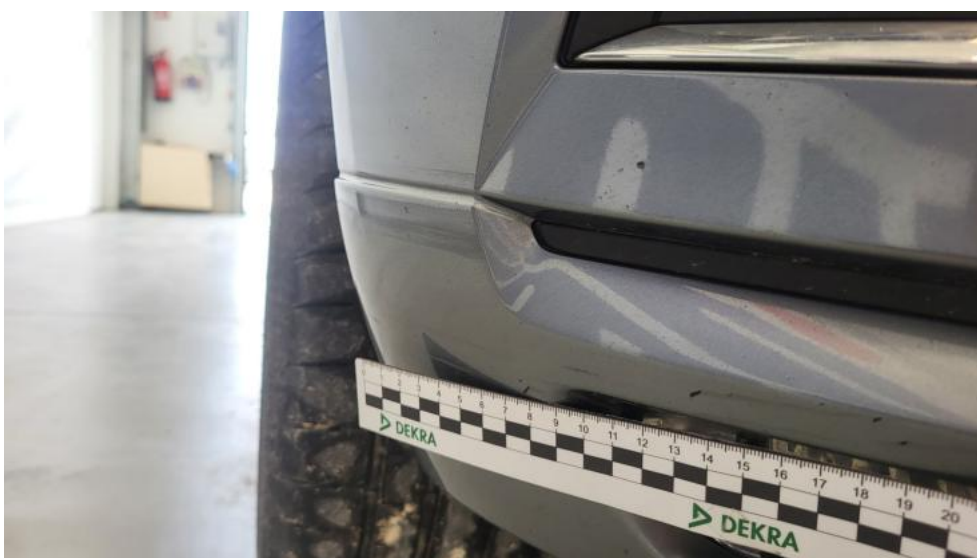
Fot. 44. Spoiler zderzaka przedniego - Rysa/odprysk 2
