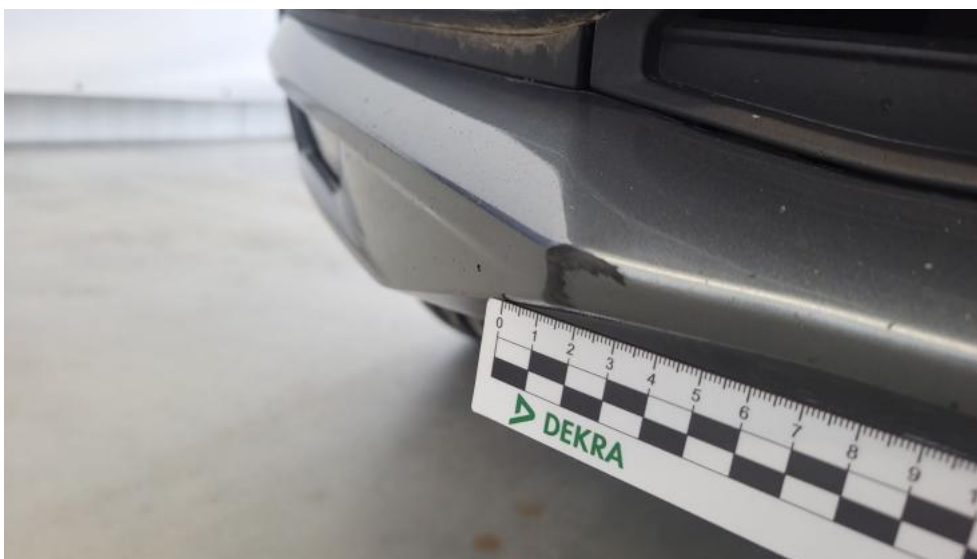
Fot. 43. Spoiler zderzaka przedniego - Rysa/odprysk 1
