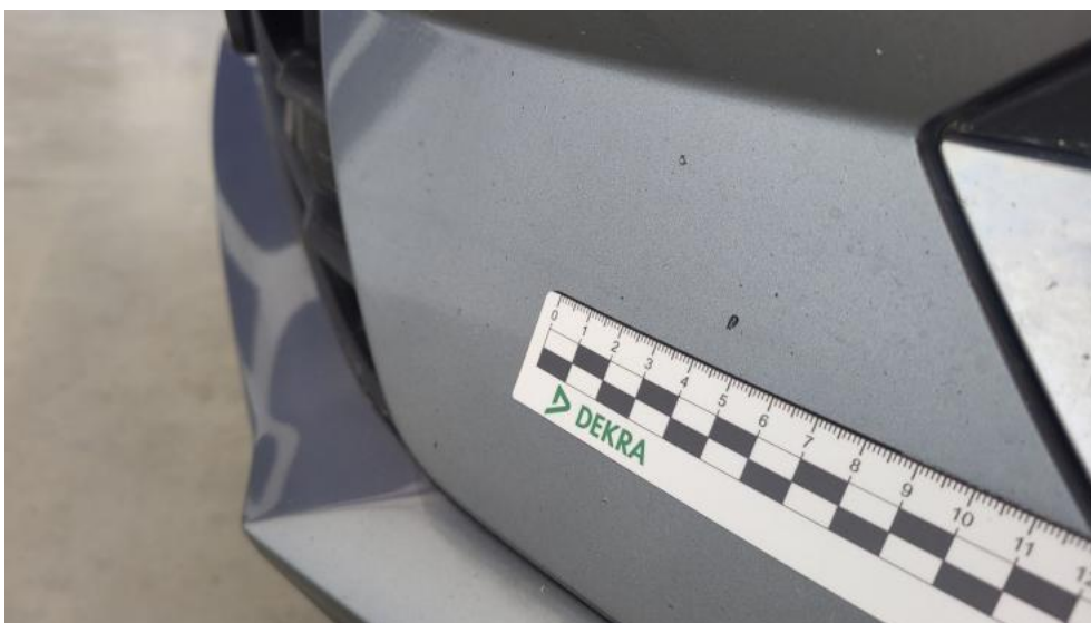
Fot. 45. Zderzak - Rysa/odprysk 1
