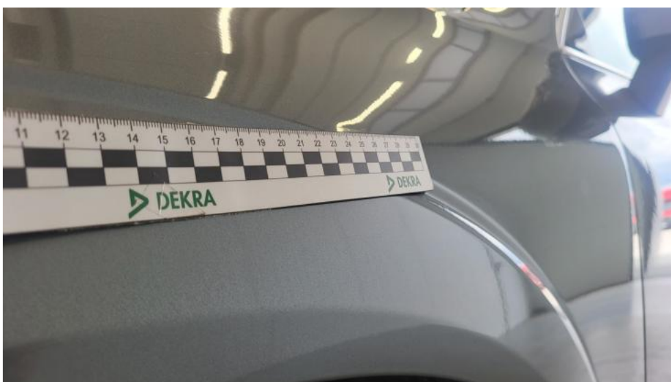
Fot. 58. Błotnik przedni L - Wgniecenie/odkształcenie 1
