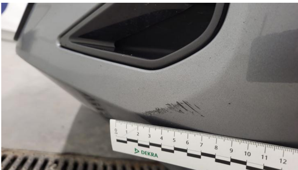
Fot. 49. Zderzak - Rysa/odprysk 2
