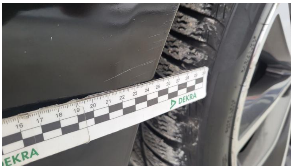
Fot. 43. Błotnik przedni P - Rysa/odprysk 2
