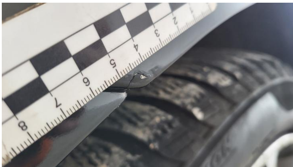
Fot. 86. Błotnik przedni L - Pęknięcie/rozerwanie 1
