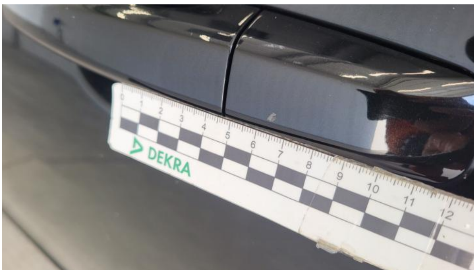
Fot. 84. Klamka drzwi tyl L - Rysa/odprysk 1
