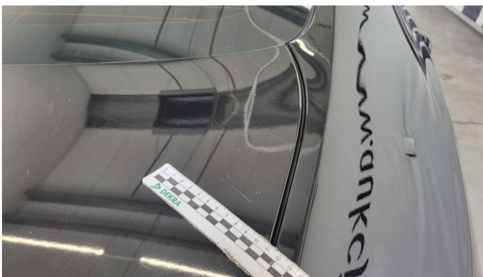
Fot. 66. Pokrywy bagażnika - Rysa/odprysk 1
