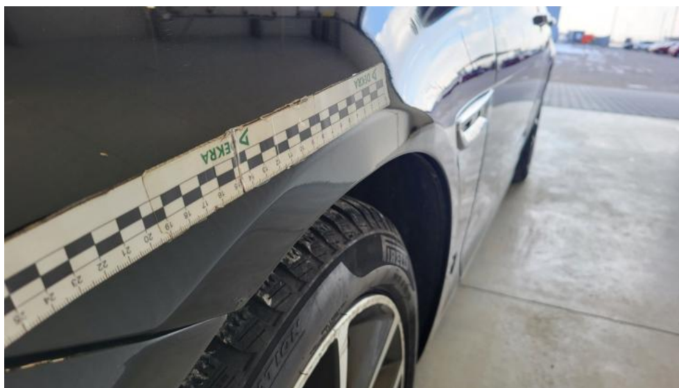
Fot. 85. Błotnik przedni L - Wgniecenie/odkształcenie 1
