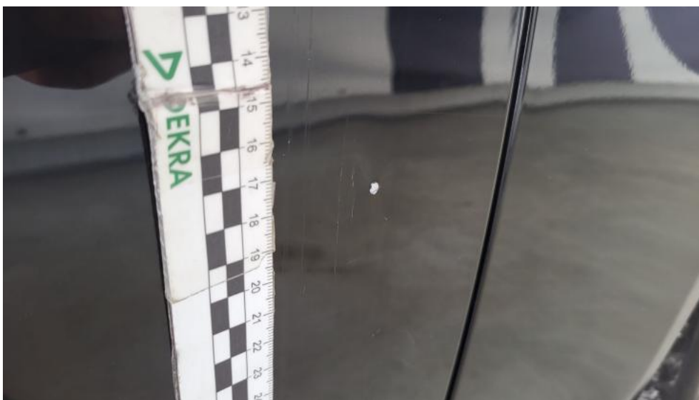
Fot. 48. Drzwi przednie P - Rysa/odprysk 1
