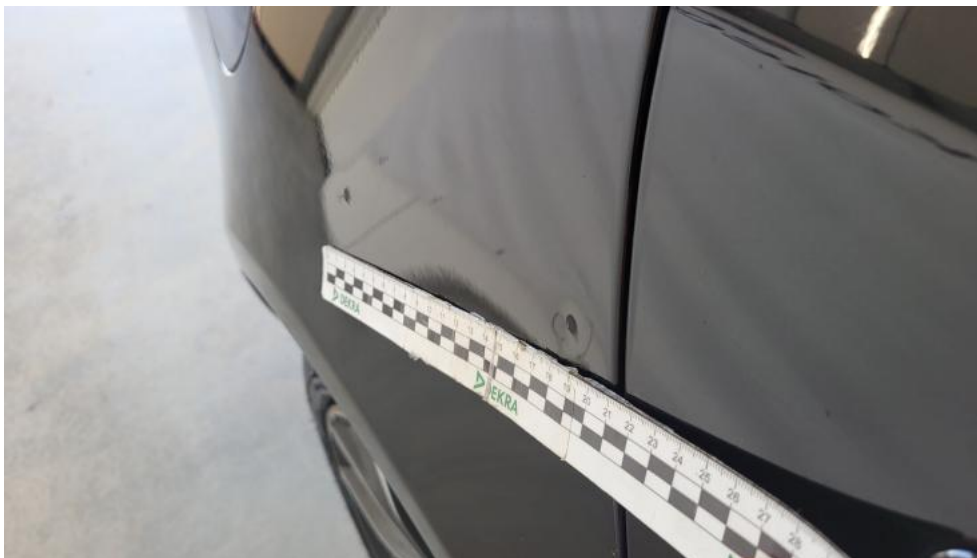
Fot. 61. Błotnik tylny P / Ściana boczna P - Wgniecenie/odkształcenie 1
