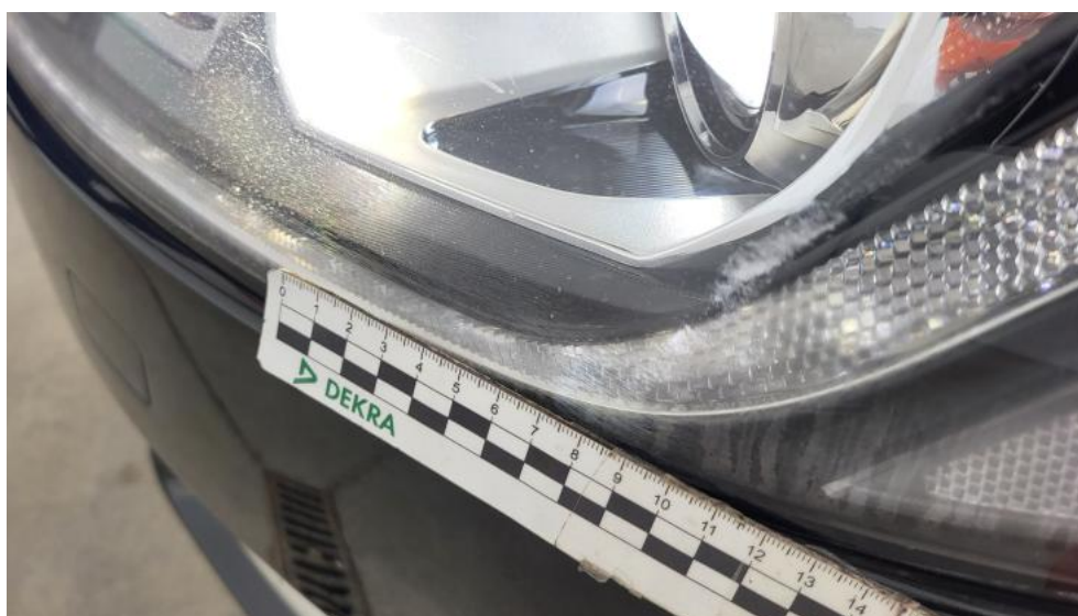
Fot. 90. Reflektor L - Rysa/odprysk 2
