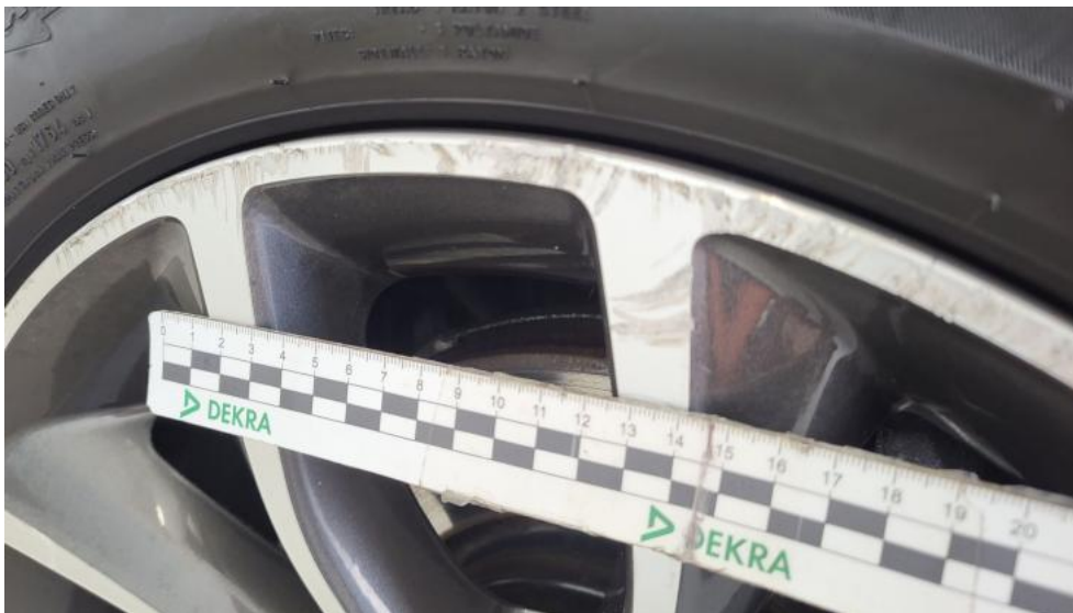
Fot. 87. Felga Aluminiowa przednia L - Rysa/odprysk 1
