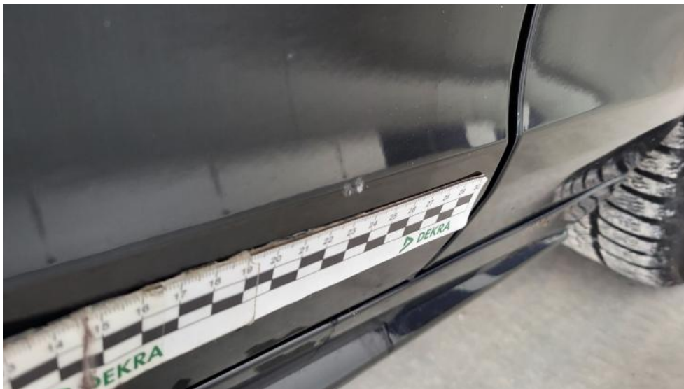
Fot. 49. Drzwi przednie P - Rysa/odprysk 2
