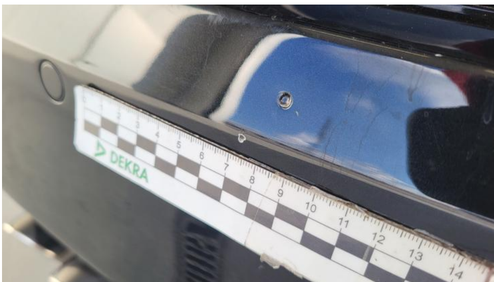
Fot. 68. Zderzak tylny - Rysa/odprysk 1
