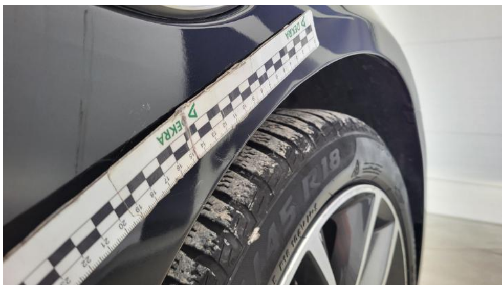
Fot. 44. Błotnik przedni P - Wgniecenie/odkształcenie 1
