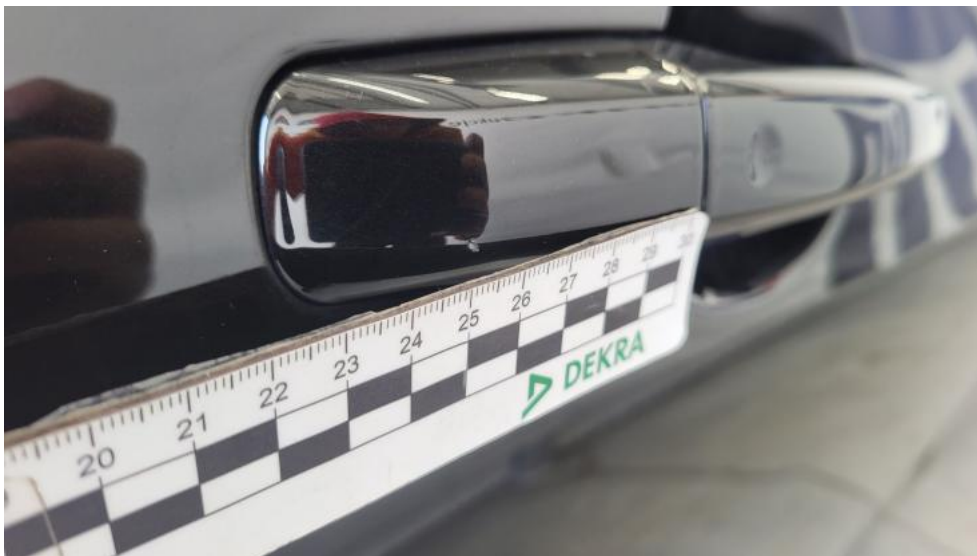
Fot. 57. Klamka drzwi tyl P - Rysa/odprysk 1
