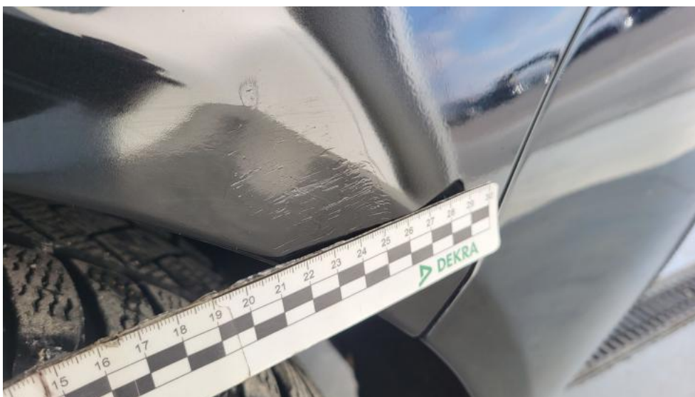
Fot. 71. Błotnik tylny L / Ściana boczna L - Rysa/odprysk 2
