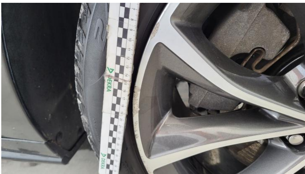
Fot. 46. Felga aluminiowa przednia P - Rysa/odprysk 2
