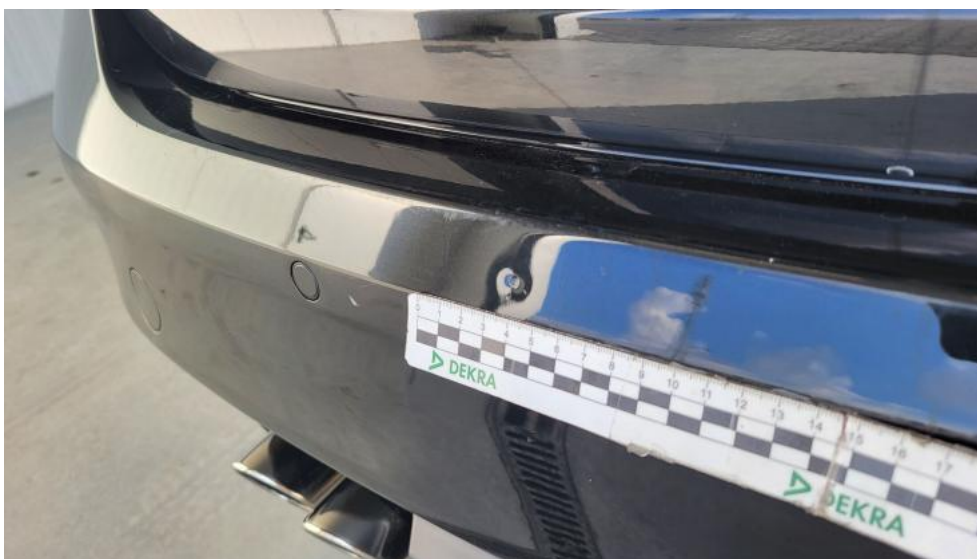
Fot. 69. Zderzak tylny - Wgniecenie/odkształcenie 1
