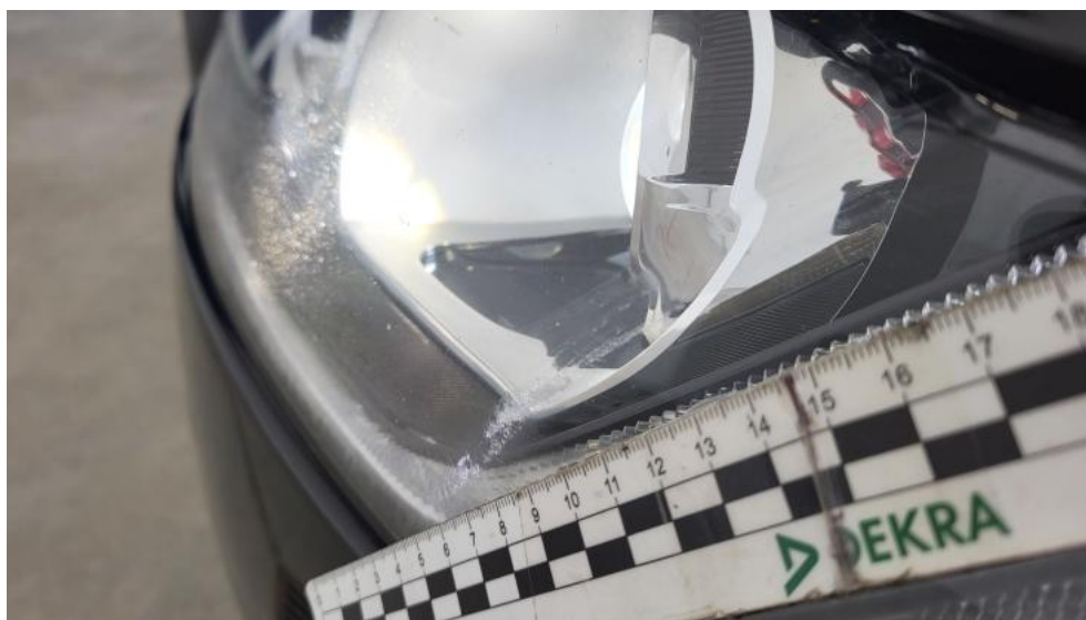
Fot. 89. Reflektor L - Rysa/odprysk 1
