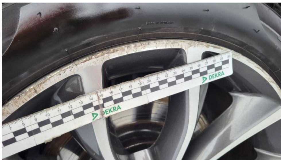
Fot. 63. Felga aluminiowa tylna P - Rysa/odprysk 1
