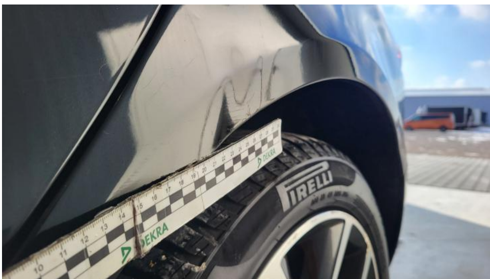
Fot. 74. Błotnik tylny L / Ściana boczna L - Wgniecenie/odkształcenie 2
