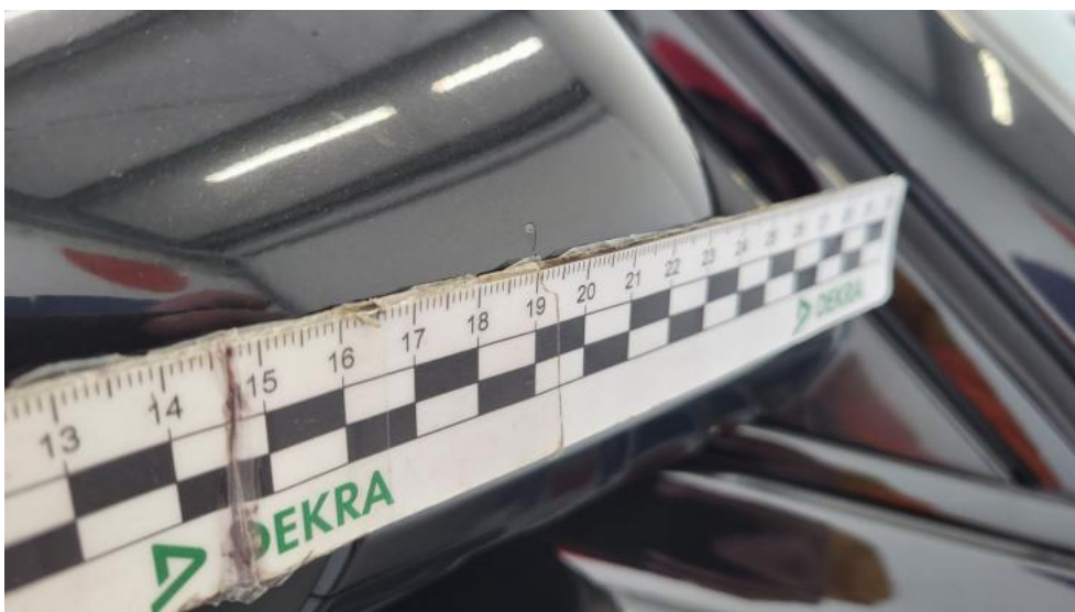
Fot. 58. Lusterko zew P - Rysa/odprysk 1
