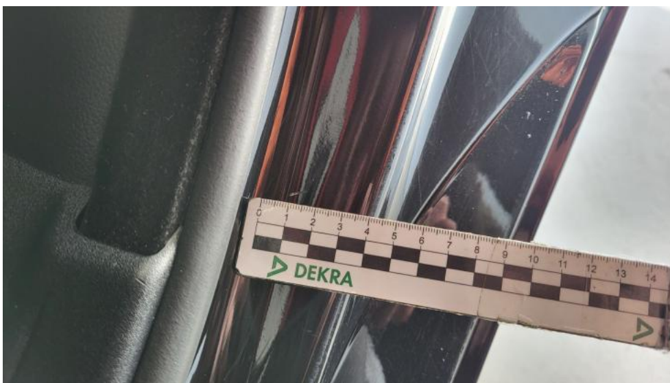
Fot. 72. Błotnik tylny L / Ściana boczna L() - Rysa/odprysk 3
