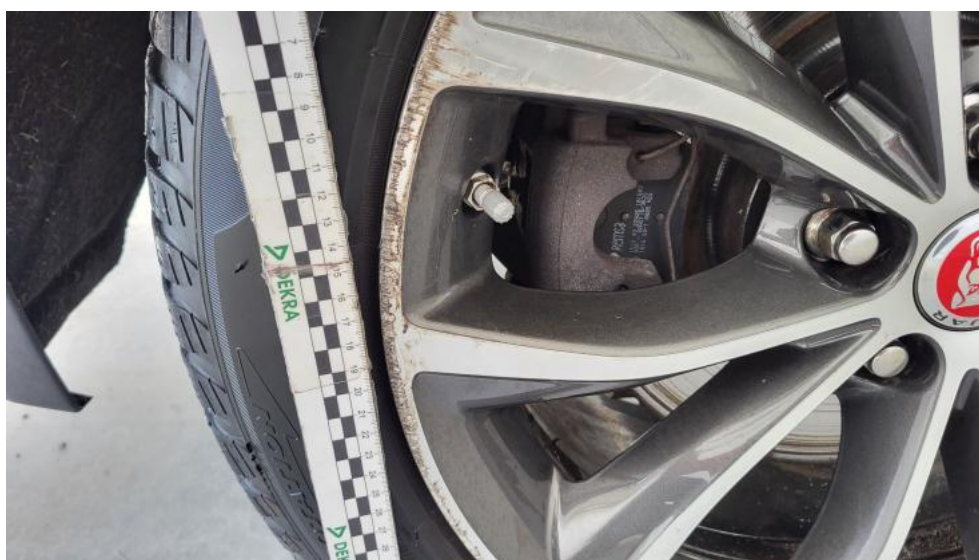
Fot. 64. Felga aluminiowa tylna P - Rysa/odprysk 2
