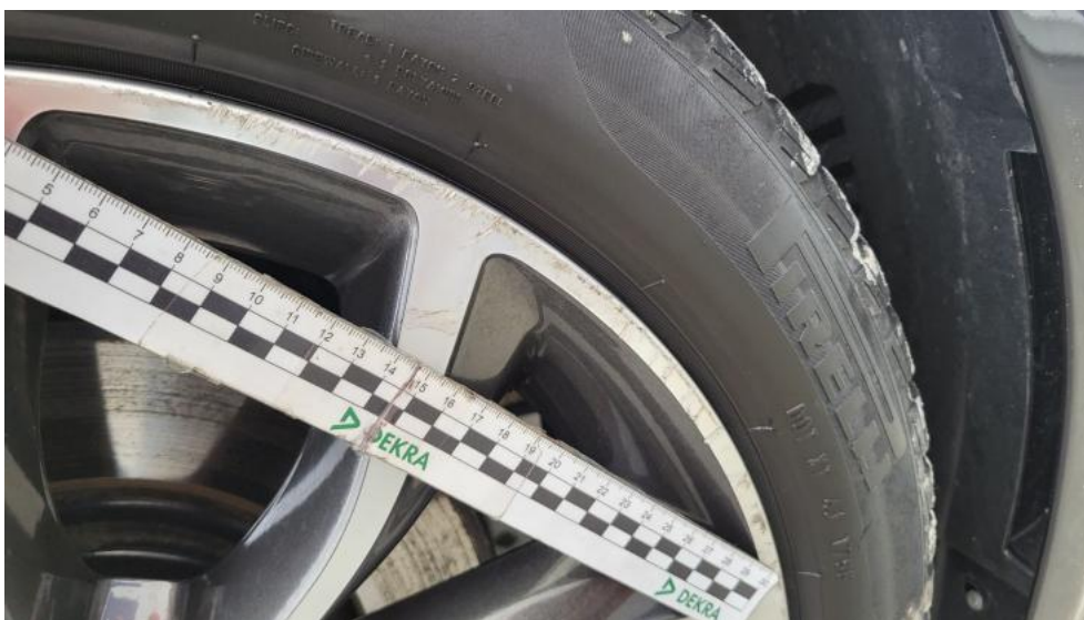
Fot. 45. Felga aluminiowa przednia P - Rysa/odprysk 1
