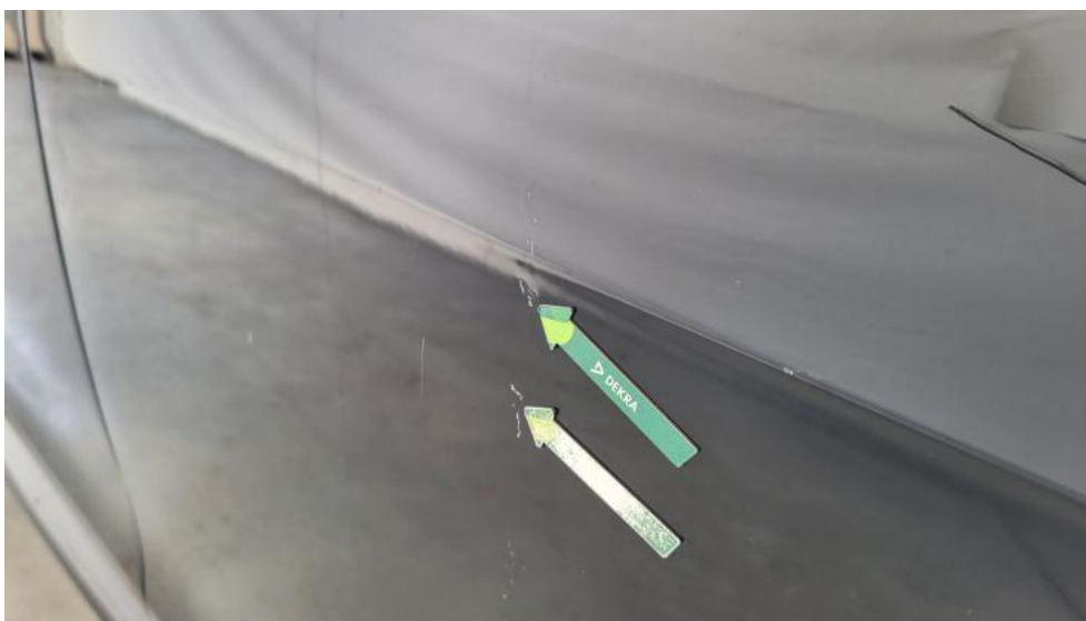
Fot. 53. Drzwi przednie P() - Wgniecenie/odkształcenie 3
