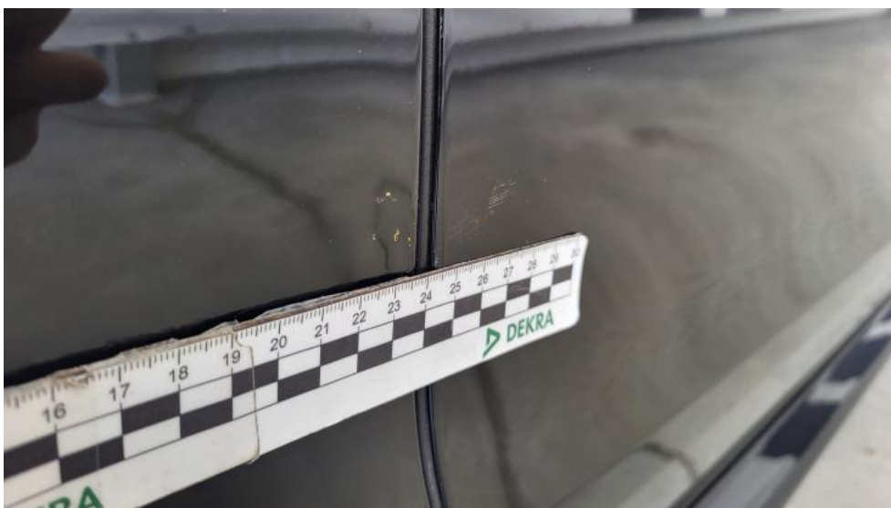
Fot. 54. Drzwi tylne P - Rysa/odprysk 1
