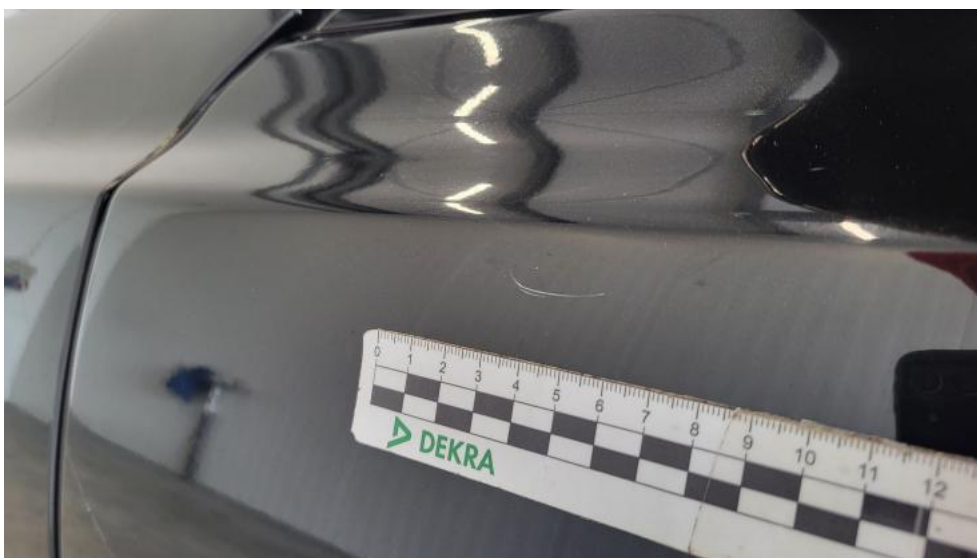
Fot. 78. Drzwi przed L - Rysa/odprysk 2
