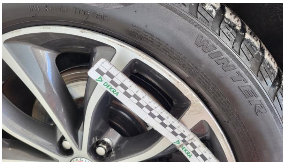
Fot. 75. Felga aluminiowa tylna L - Rysa/odprysk 1
