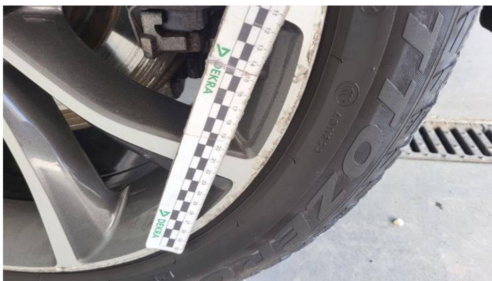
Fot. 76. Felga aluminiowa tylna L - Rysa/odprysk 2
