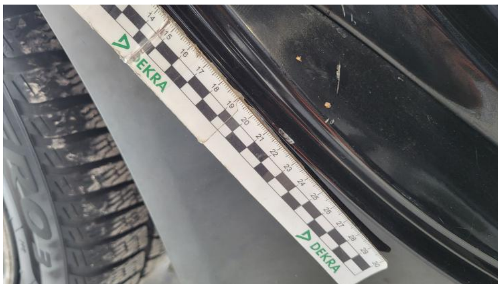
Fot. 59. Próg P - Rysa/odprysk 1
