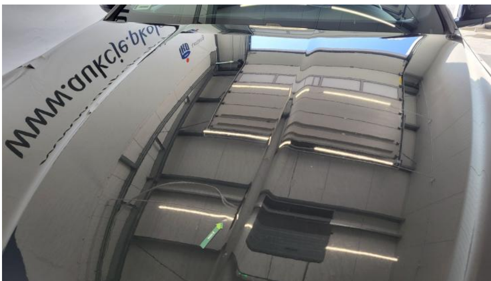
Fot. 37. Pokrywa komory silnika - Wgniecenie/odkształcenie 1
