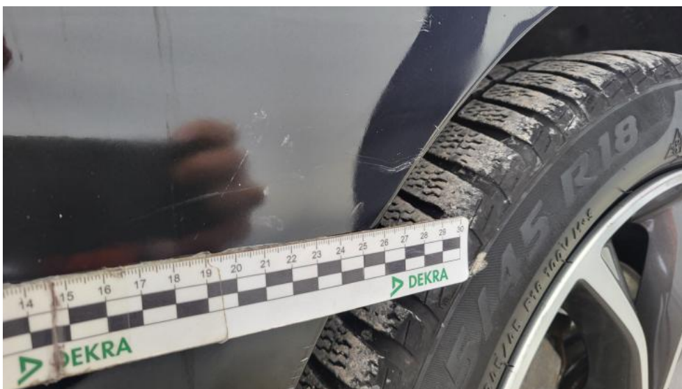
Fot. 42. Błotnik przedni P - Rysa/odprysk 1
