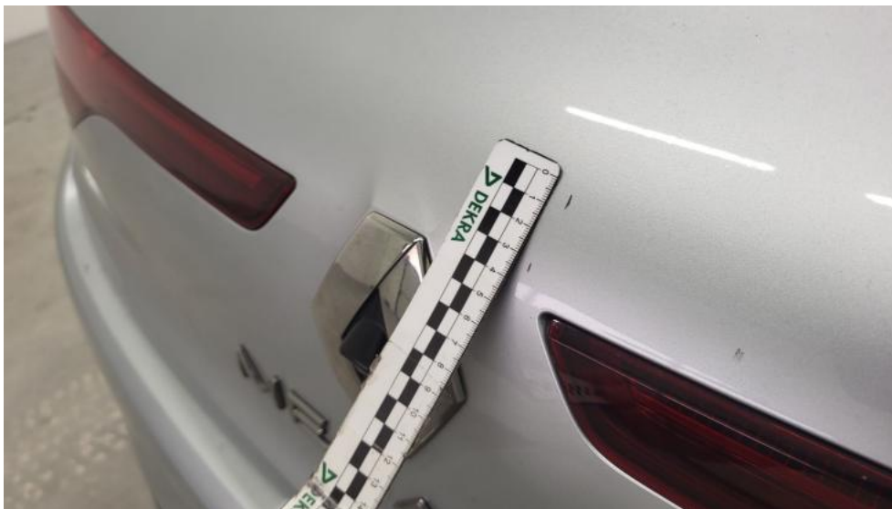
Photo 41. Pokrywy bagażnika - Rysa/odprysk 1
