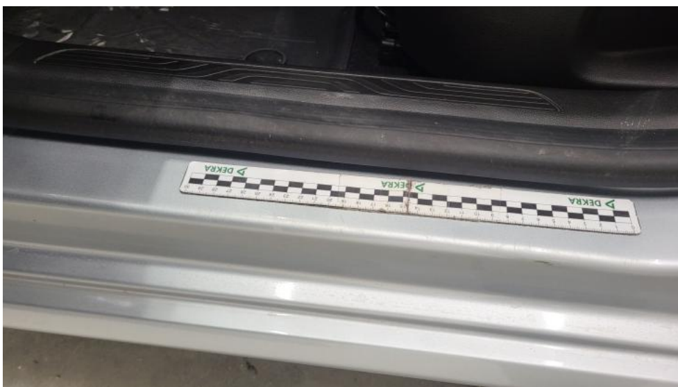
Photo 48. Próg L - Rysa/odprysk 1
