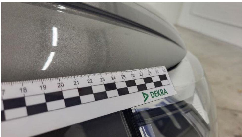
Fot. 70. Błotnik przedni P - Rysa/odprysk 1
