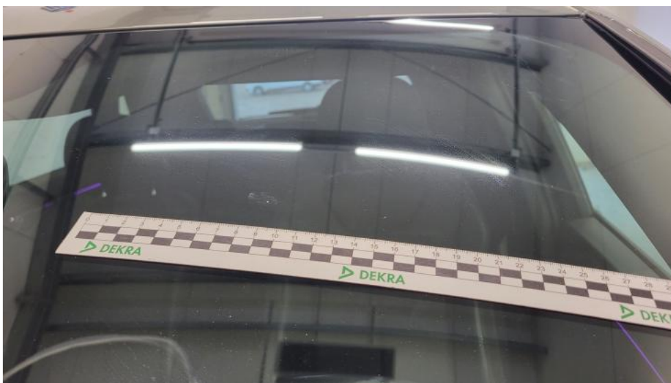
Fot. 66. Szyba czołowa - Rysa/odprysk 1
