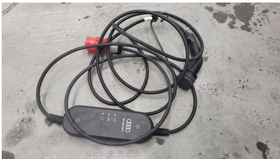
Fot. 36. Przewód ładowania baterii trakcyjnej
