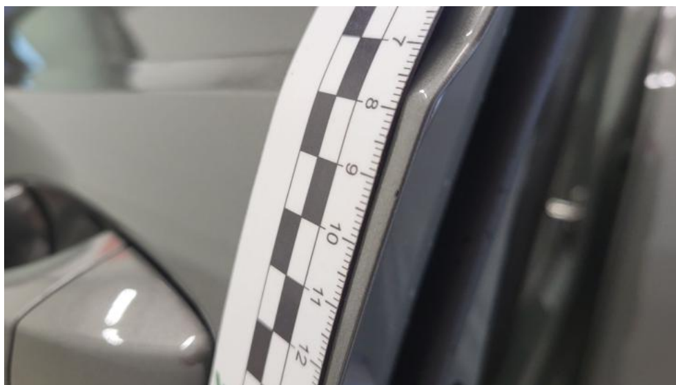
Fot. 74. Drzwi przed L - Rysa/odprysk 1
