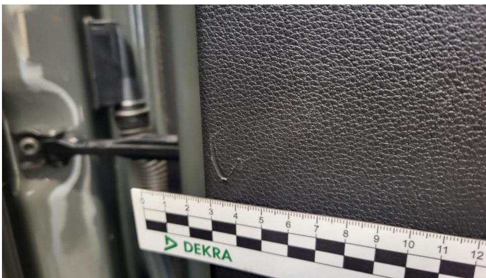
Fot. 79. Tapicerka drzwi tylnych P - Rysa/odprysk 1
