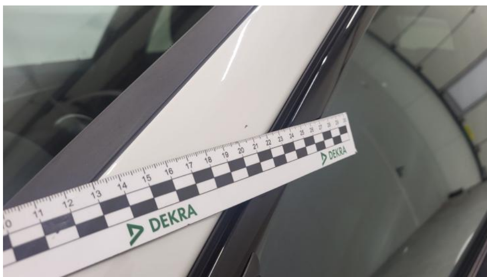
Fot. 70. Słupek przedni L - Rysa/odprysk 1
