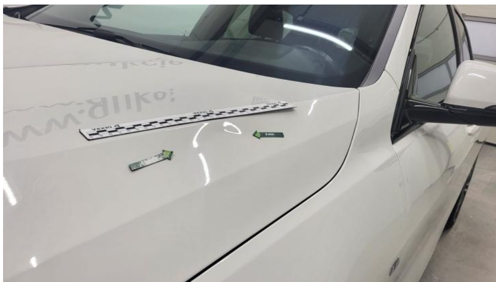
Fot. 42. Pokrywa komory silnika - Wgniecenie/odkształcenie 1
