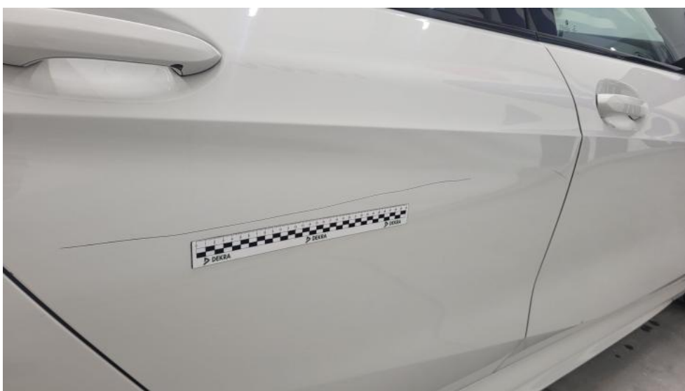
Fot. 56. Drzwi tylne P - Rysa/odprysk 1
