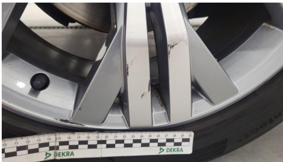
Photo 65. Felga aluminiowa tylna P - Rysa/odprysk 1
