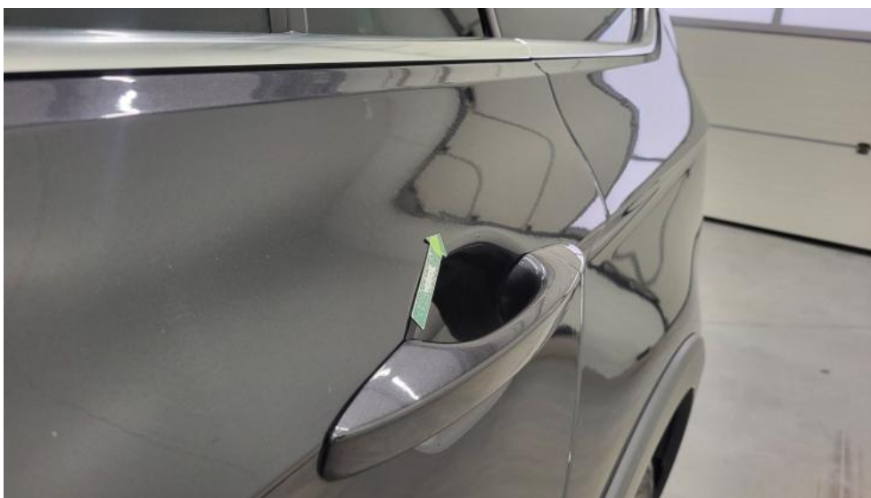
Photo 83. Drzwi tylne L - Wgniecenie/odkształcenie 1
