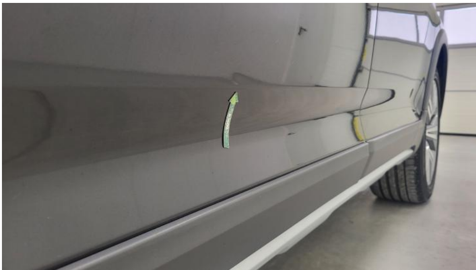
Photo 79. Drzwi przed L - Wgniecenie/odkształcenie 1
