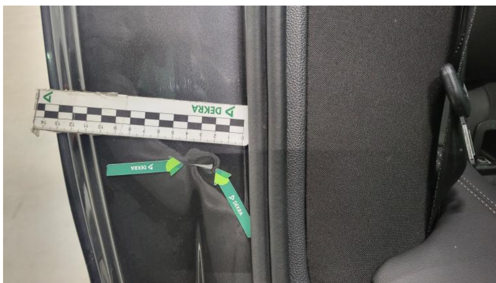
Photo 64. Błotnik tylny P / Ściana boczna P - Wgniecenie/odkształcenie 1
