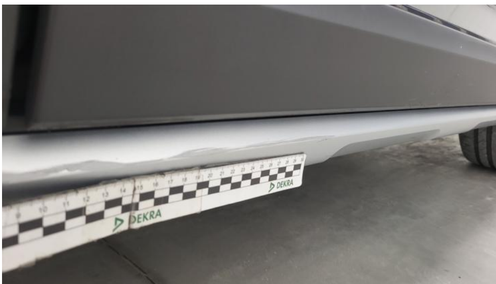
Photo 61. Próg P - Rysa/odprysk 2
