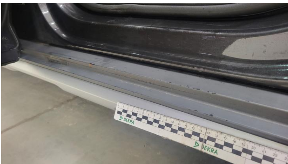
Photo 84. Próg L - Rysa/odprysk 1
