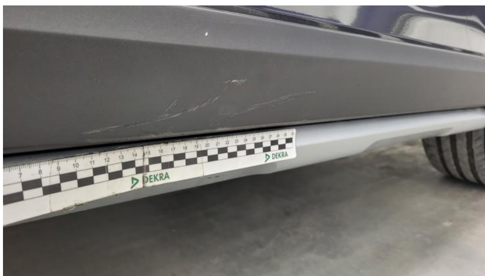
Photo 54. Listwa drzwi przednich P - Rysa/odprysk 1
