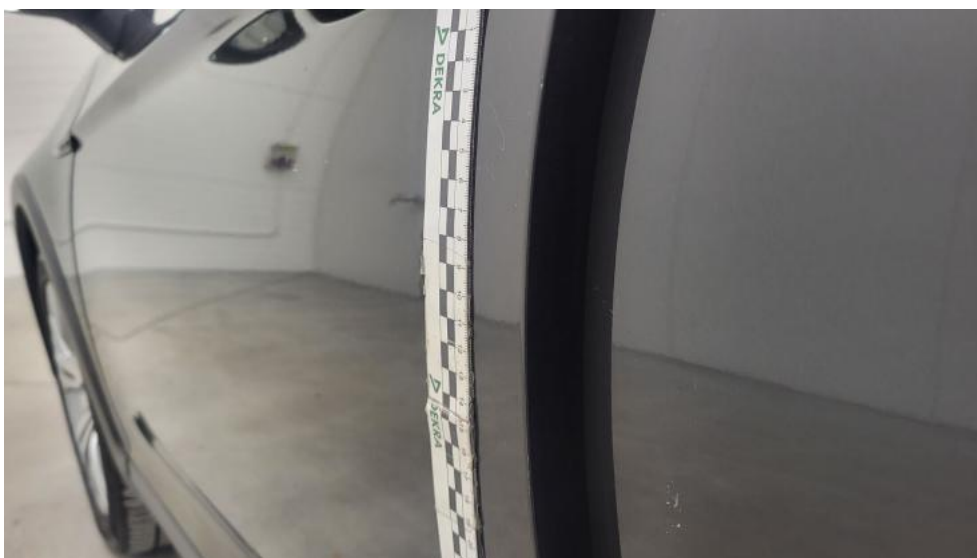
Photo 78. Drzwi przed L - Rysa/odprysk 1
