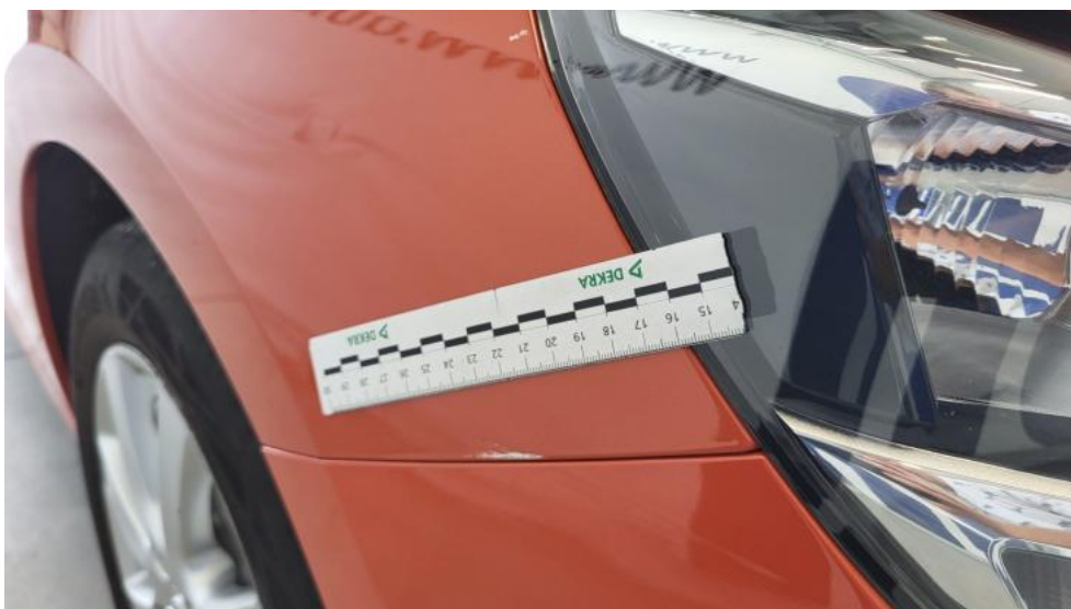
Fot. 44. Błotnik przedni P - Rysa/odprysk 1
