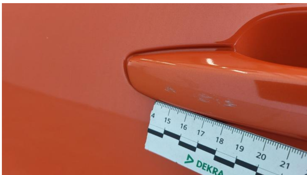
Fot. 71. Klamka drzwi prz L - Rysa/odprysk 2
