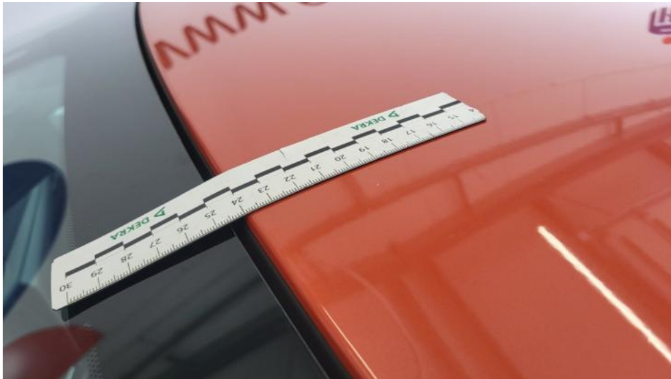
Fot. 63. Dach - Rysa/odprysk 1
