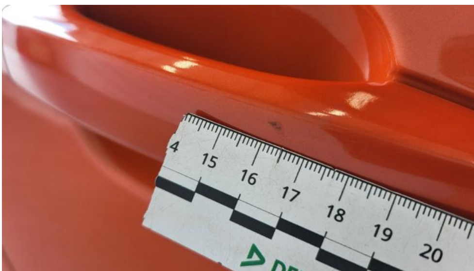
Fot. 53. Klamka drzwi tyl P - Rysa/odprysk 1
