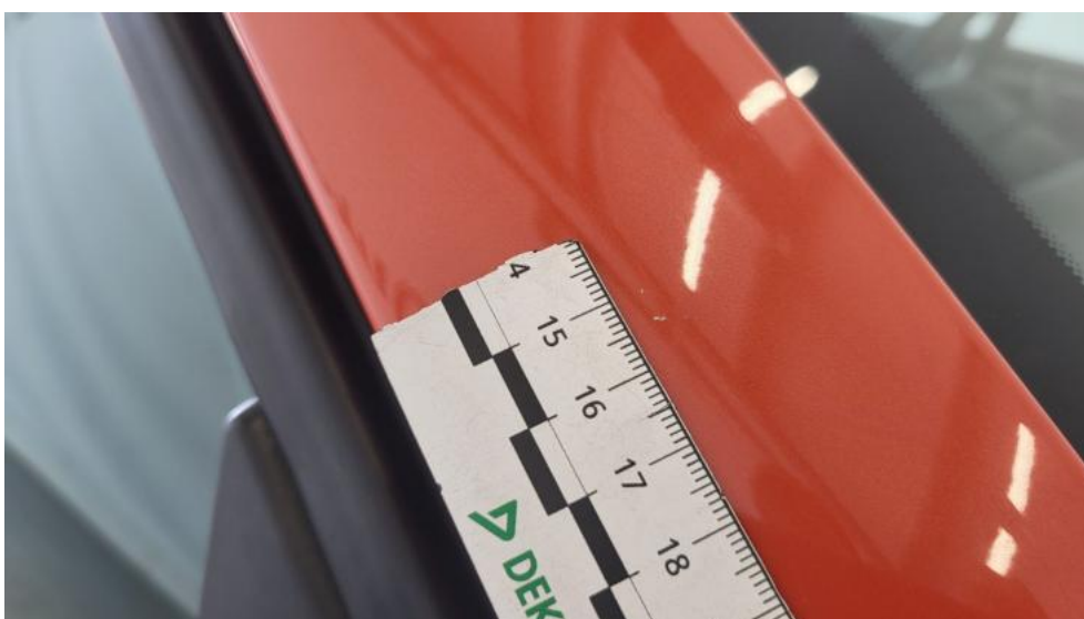
Fot. 54. Słupek przedni P - Rysa/odprysk 1
