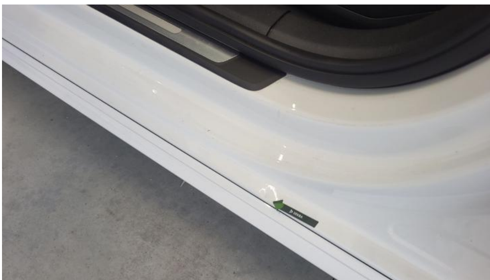
Photo 71. Próg L - Wgniecenie/odkształcenie 1
