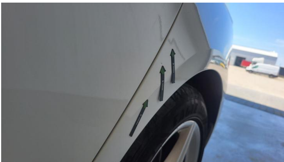
Photo 63. Błotnik tylny L / Ściana boczna L - Wgniecenie/odkształcenie 2
