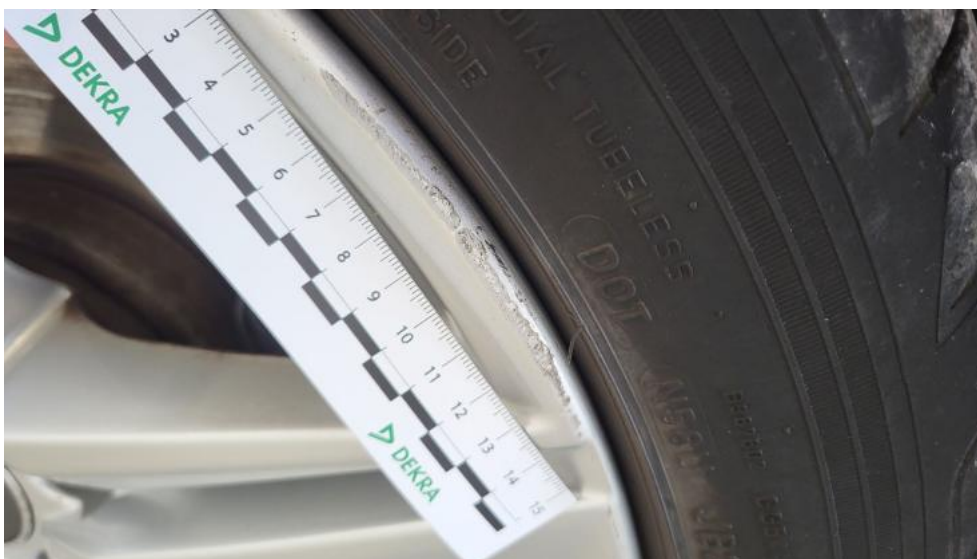
Photo 75. Felga Aluminiowa przednia L - Rysa/odprysk 1
