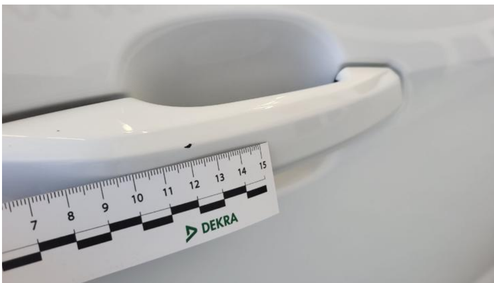
Photo 53. Klamka drzwi prz P - Rysa/odprysk 1
