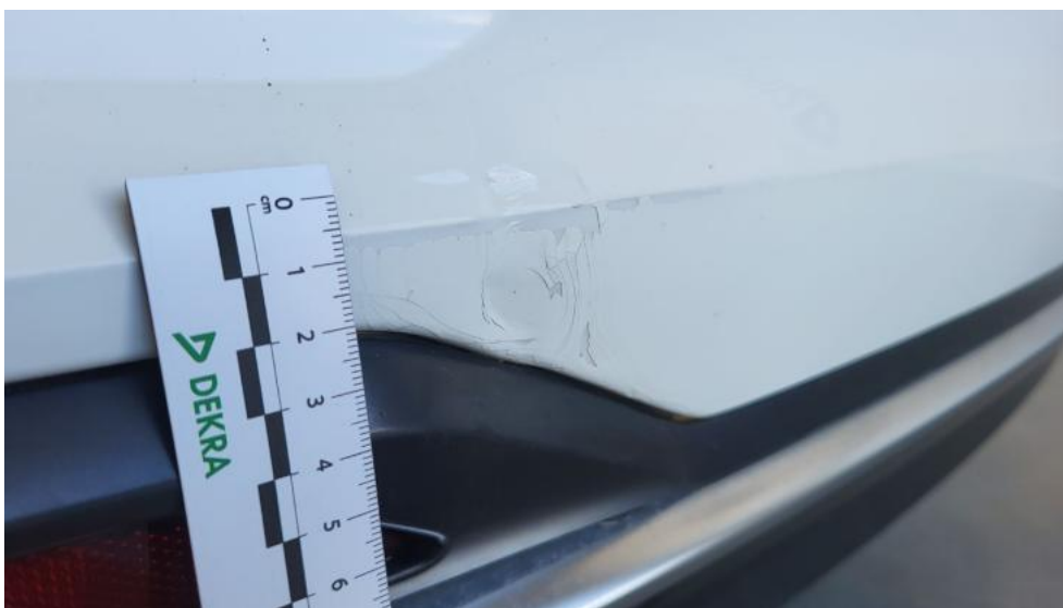
Photo 59. Zderzak tylny - Pęknięcie/rozerwanie 1
