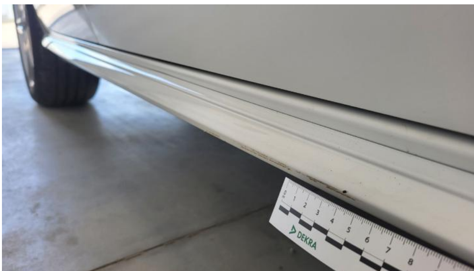
Photo 54. Próg P - Rysa/odprysk 1
