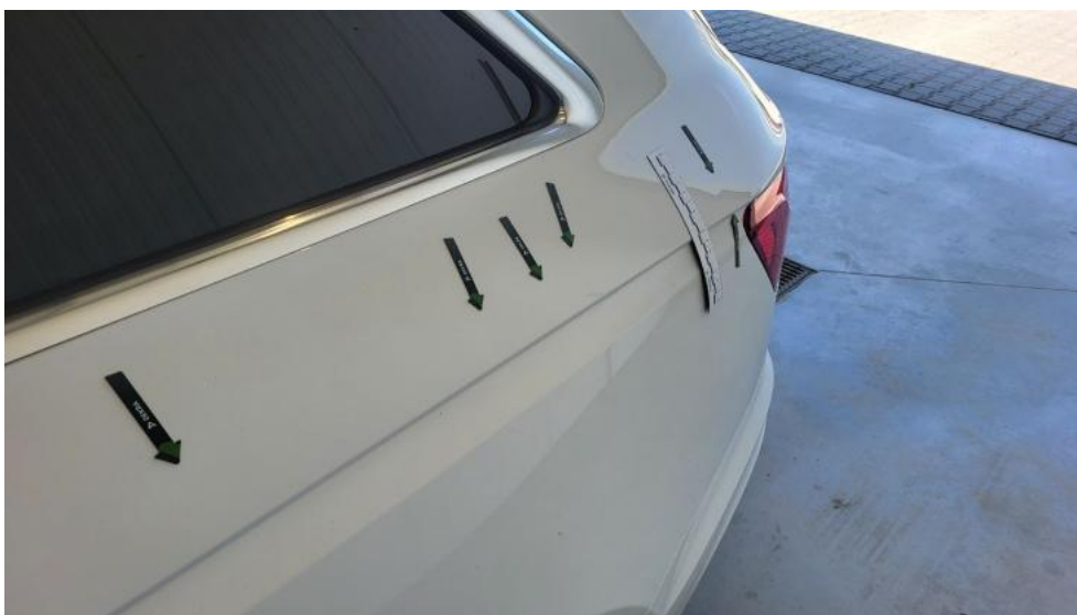
Photo 62. Błotnik tylny L / Ściana boczna L - Wgniecenie/odkształcenie 1
