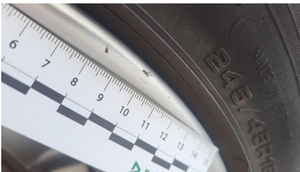
Photo 64. Felga aluminiowa tylna L - Rysa/odprysk 1
