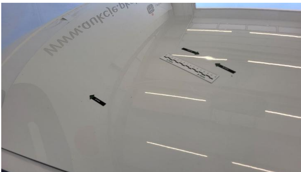
Photo 42. Pokrywa komory silnika - Wgniecenie/odkształcenie 1
