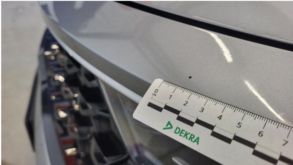
Fot. 47. Zderzak przedni cz górna - Rysa/odprysk 1
