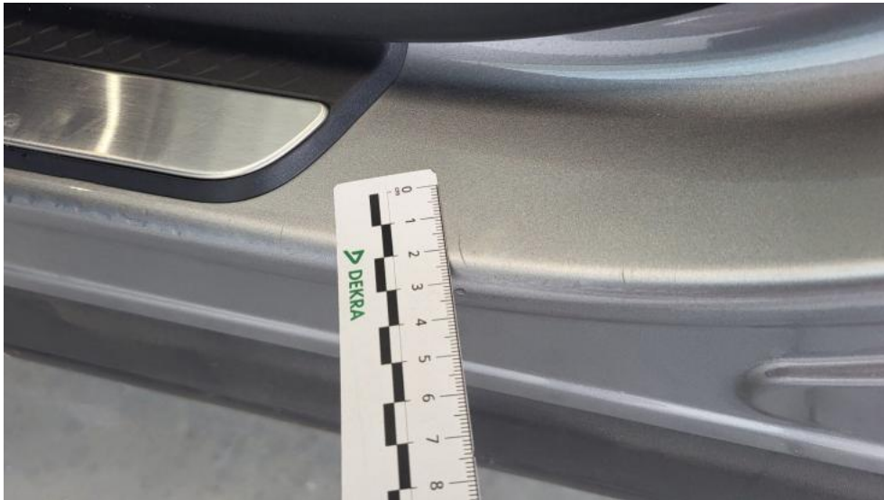
Fot. 77. Próg L - Rysa/odprysk 1
