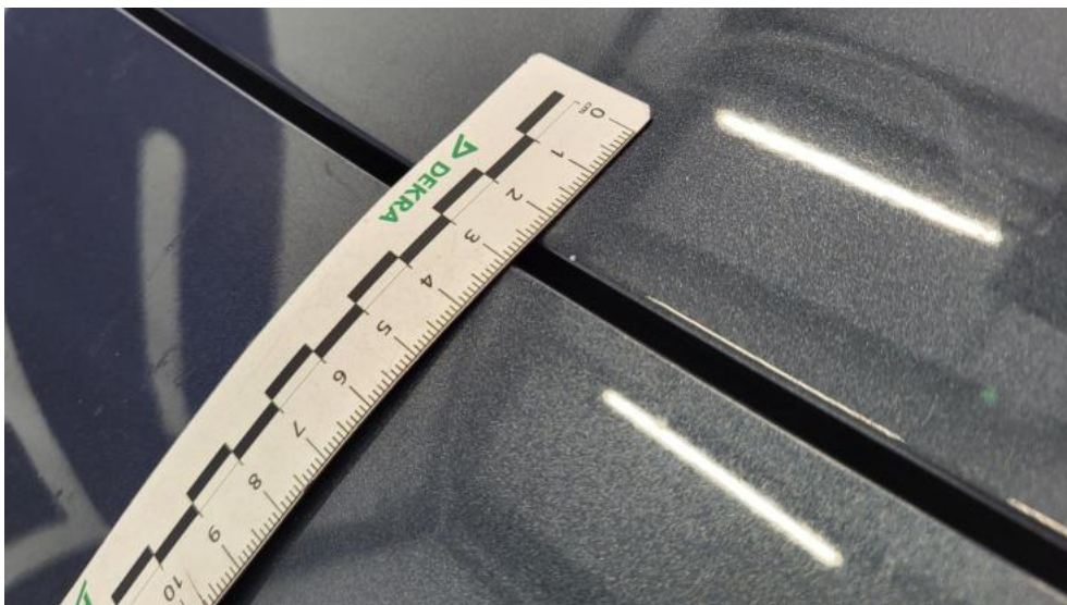
Photo 42. Pokrywa komory silnika - Rysa/odprysk 1
