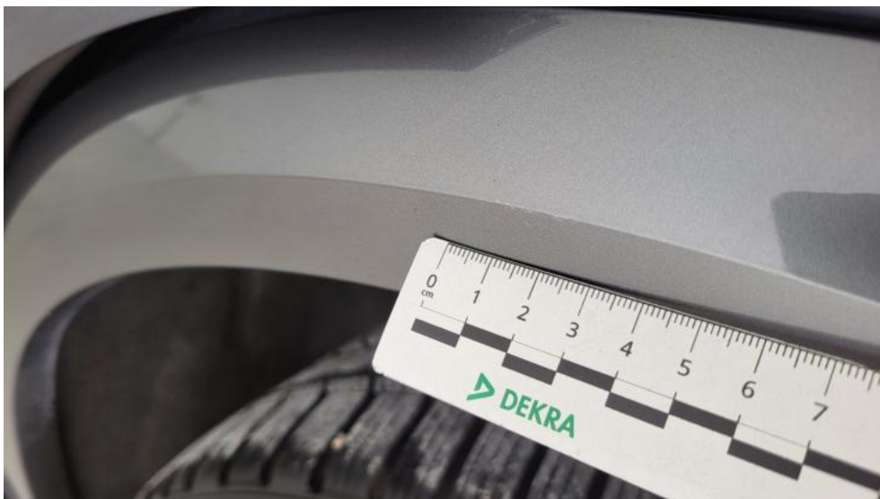
Photo 62. Listwa krawędzi błotnika tyl L - Rysa/odprysk 1
