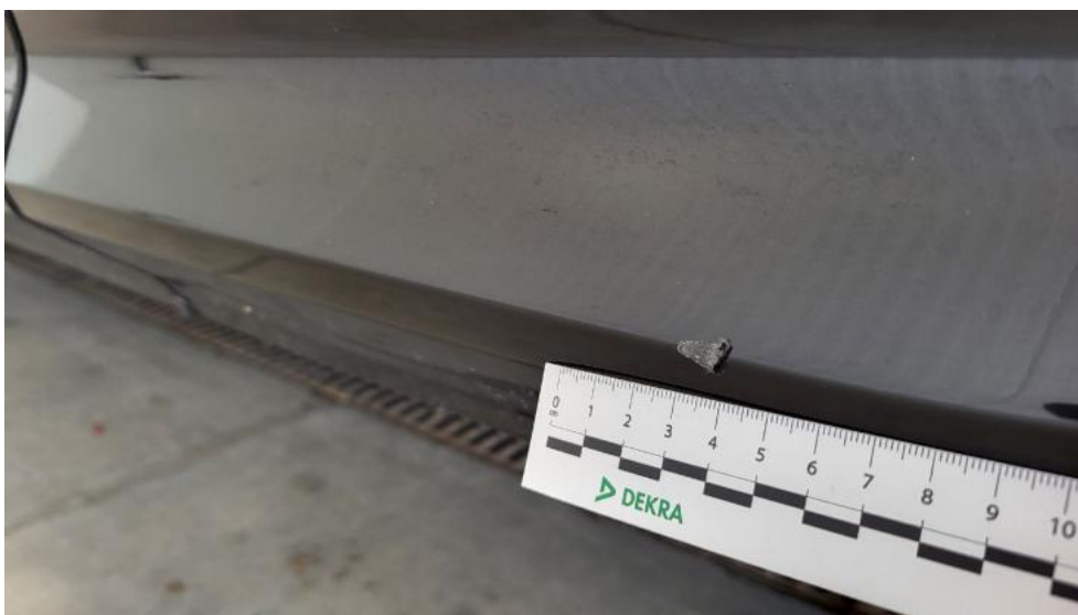
Fot. 58. Listwa drzwi tył L - Rysa/odprysk 1
