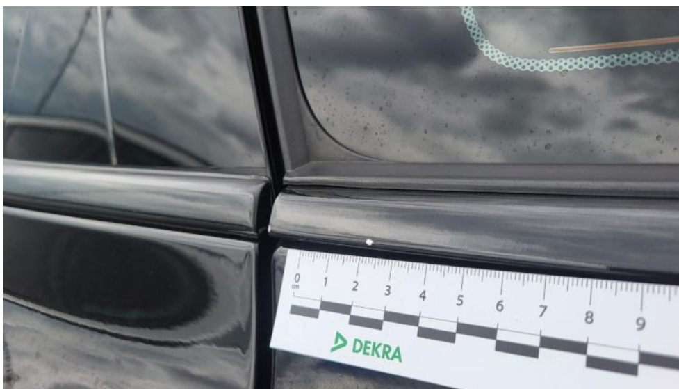
Fot. 55. Uszczelka szyby bocznej tyl L - Rysa/odprysk 1
