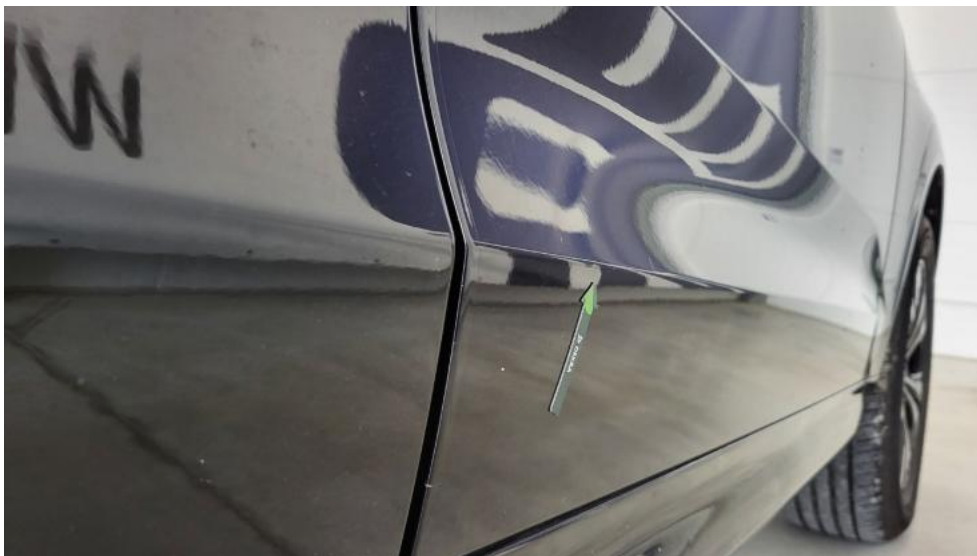
Fot. 47. Drzwi przednie P - Wgniecenie/odkształcenie 1
