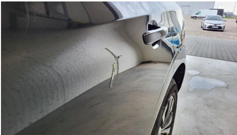
Fot. 57. Drzwi tylne L - Wgniecenie/odkształcenie 1
