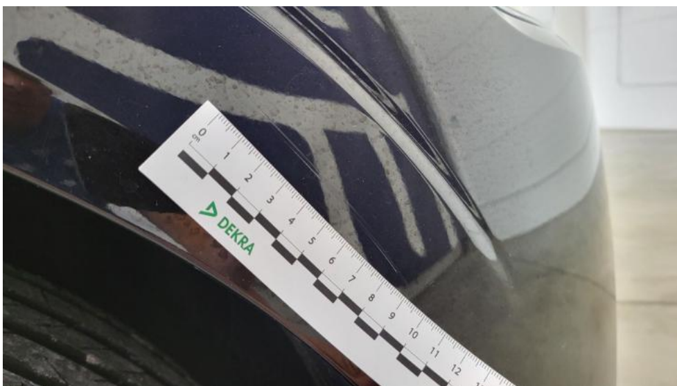
Fot. 44. Zderzak - Rysa/odprysk 1
