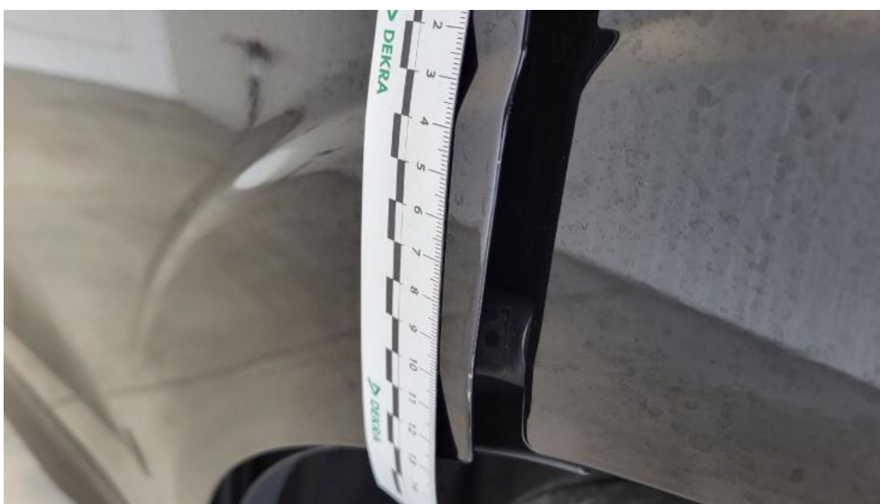
Fot. 56. Drzwi tylne L - Rysa/odprysk 1
