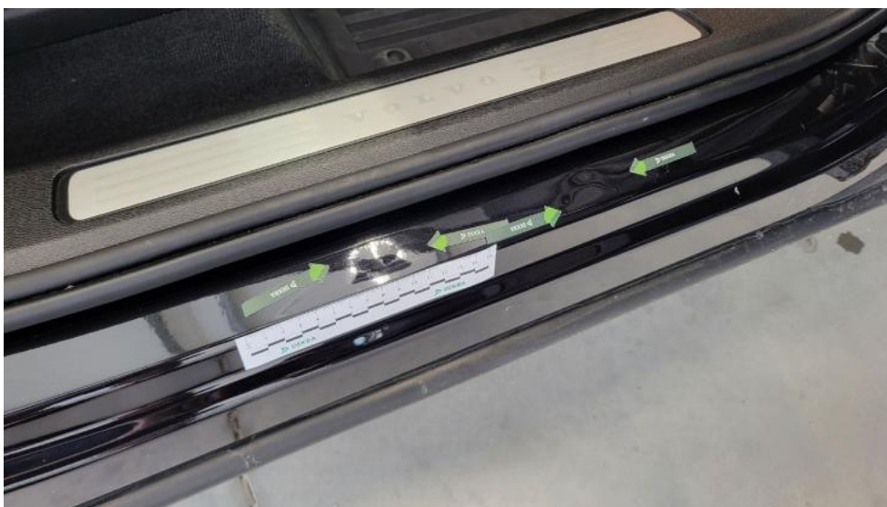
Fot. 50. Próg P - Wgniecenie/odkształcenie 1
