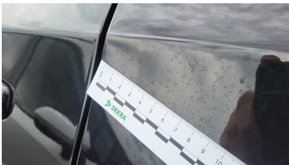
Fot. 54. Błotnik tylny L / Ściana boczna L - Rysa/odprysk 1
