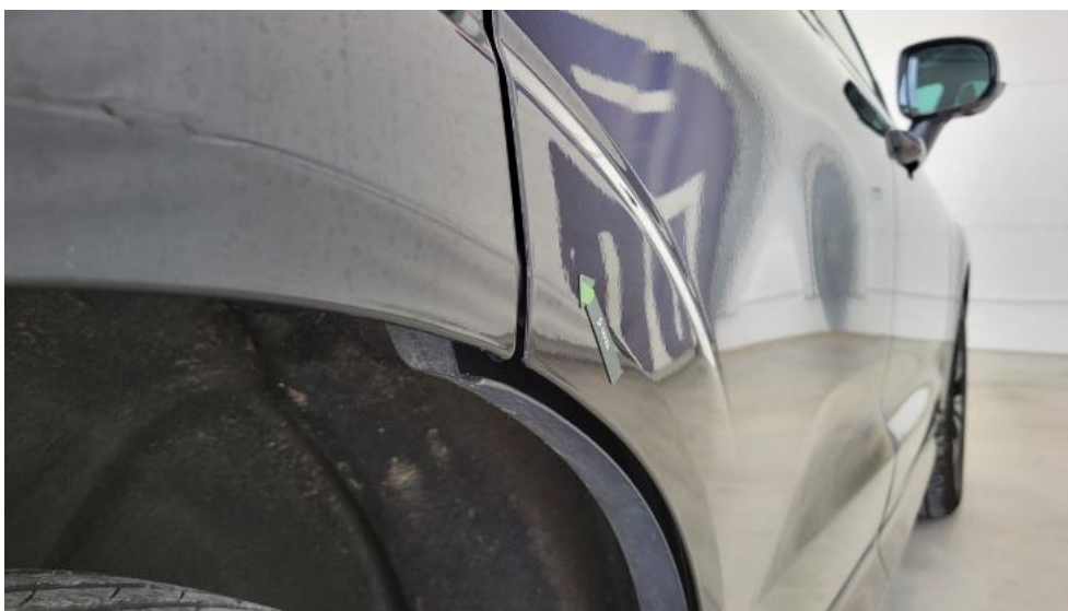
Fot. 49. Drzwi tylne P - Wgniecenie/odkształcenie 1
