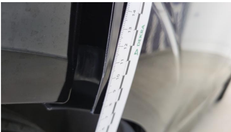
Fot. 48. Drzwi tylne P - Rysa/odprysk 1
