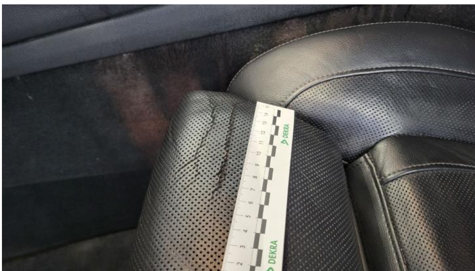
Fot. 84. Fotel prz. lew. - Pęknięcie/rozerwanie 1
