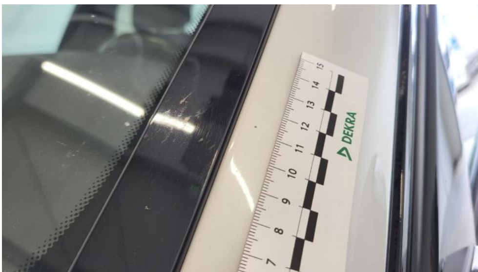
Fot. 80. Słupek przedni L - Rysa/odprysk 1
