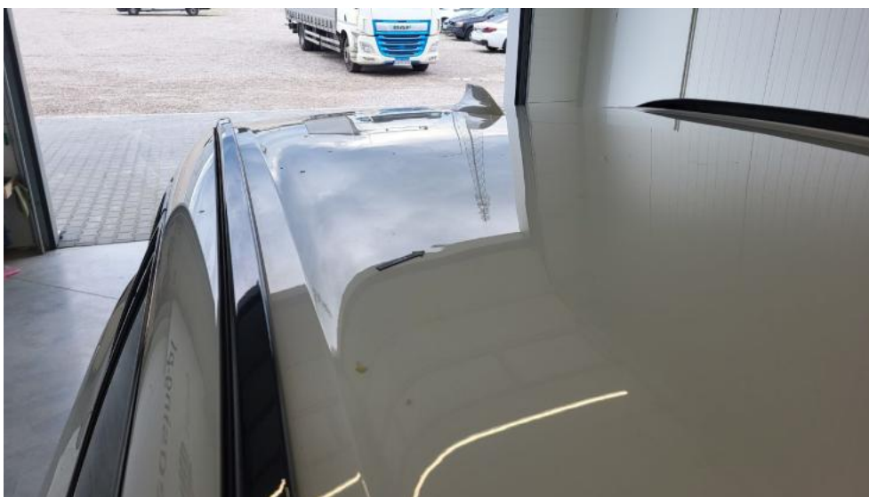
Fot. 69. Dach - Wgniecenie/odkształcenie 1
