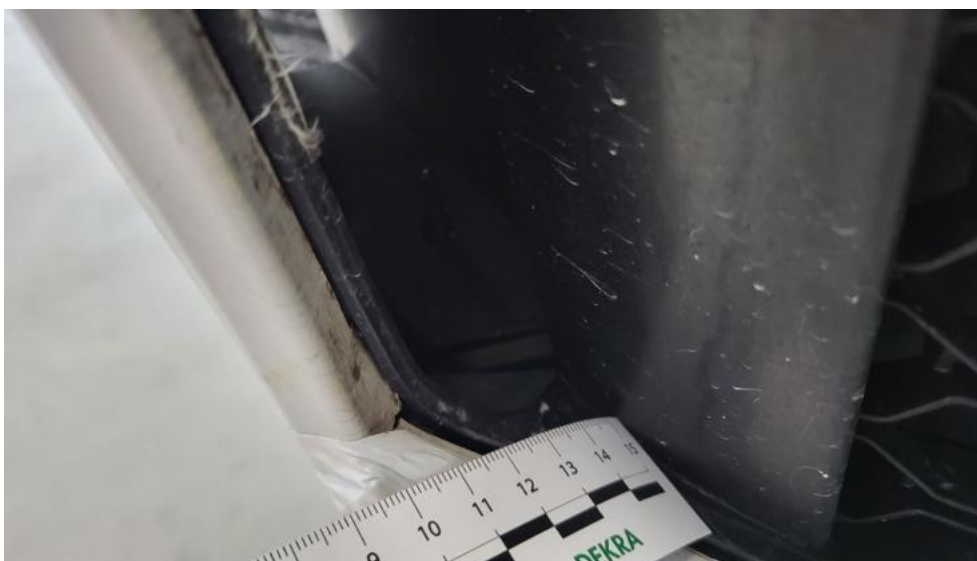
Fot. 45. Kratka/zasłepka halogenu P - Pęknięcie/rozerwanie 1
