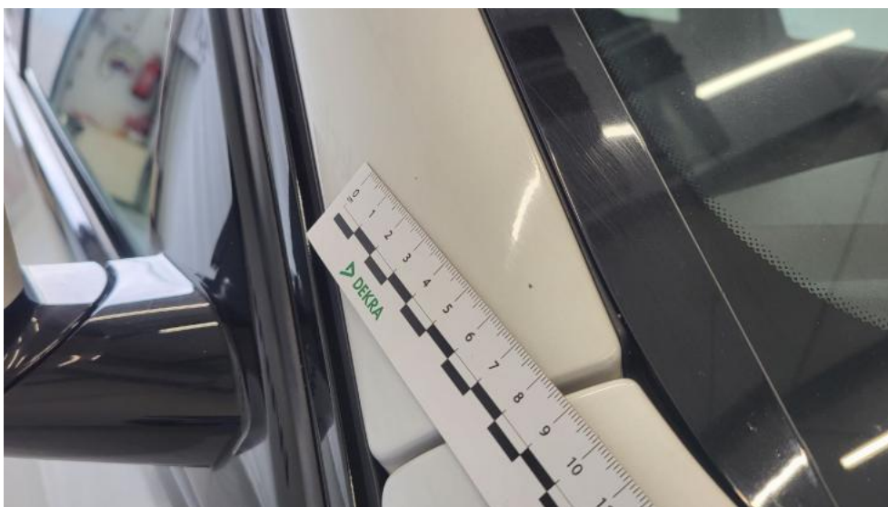
Fot. 64. Słupek przedni P - Rysa/odprysk 1
