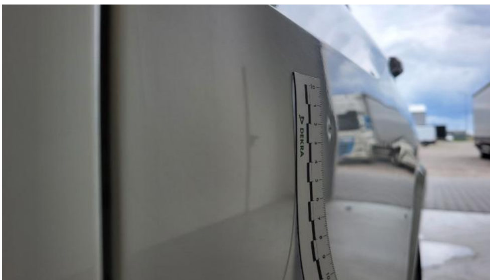
Fot. 78. Drzwi tylne L - Wgniecenie/odkształcenie 1
