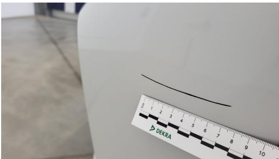
Fot. 49. Zderzak - Rysa/odprysk 1
