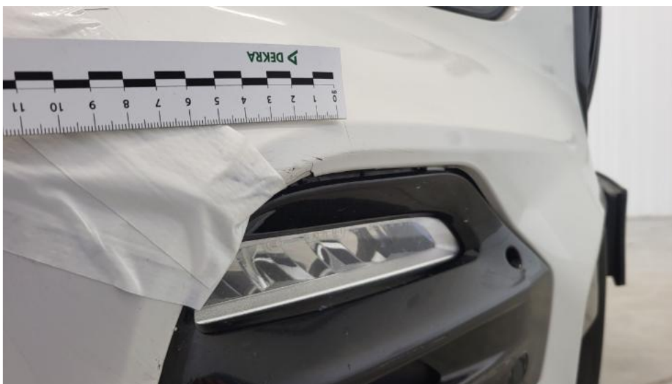
Fot. 53. Zderzak() - Pęknięcie/rozerwanie 3
