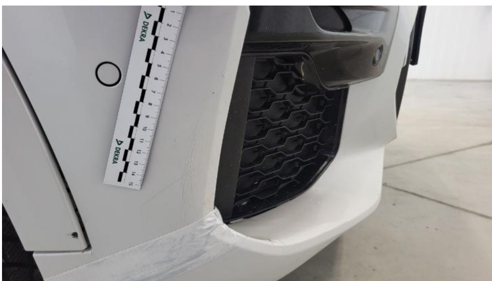
Fot. 52. Zderzak - Pęknięcie/rozerwanie 1
