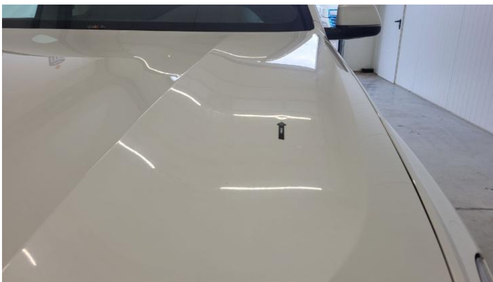
Fot. 47. Pokrywa komory silnika - Wgniecenie/odkształcenie 1
