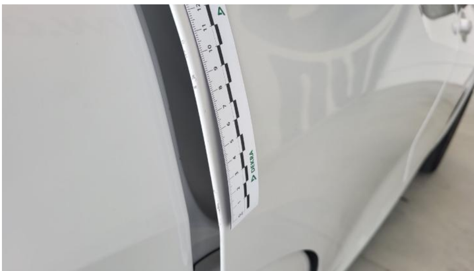
Fot. 61. Drzwi tylne P - Rysa/odprysk 1
