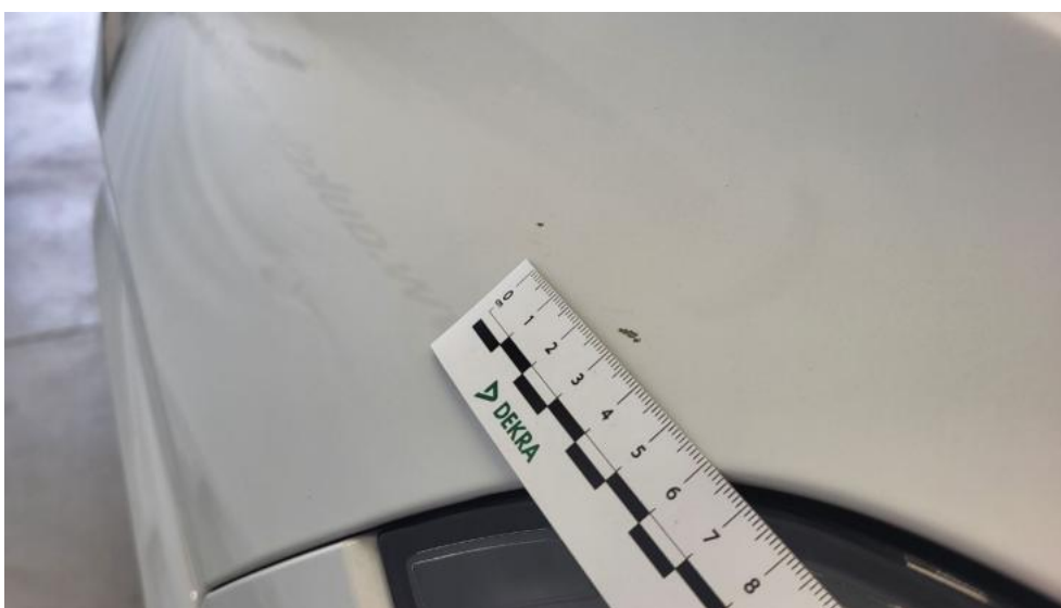
Fot. 54. Błotnik przedni P - Rysa/odprysk 1
