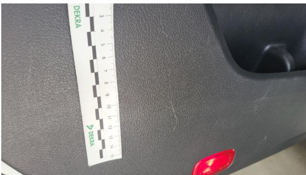
Photo 84. Tapicerka drzwi przednich L - Rysa/odprysk 1
