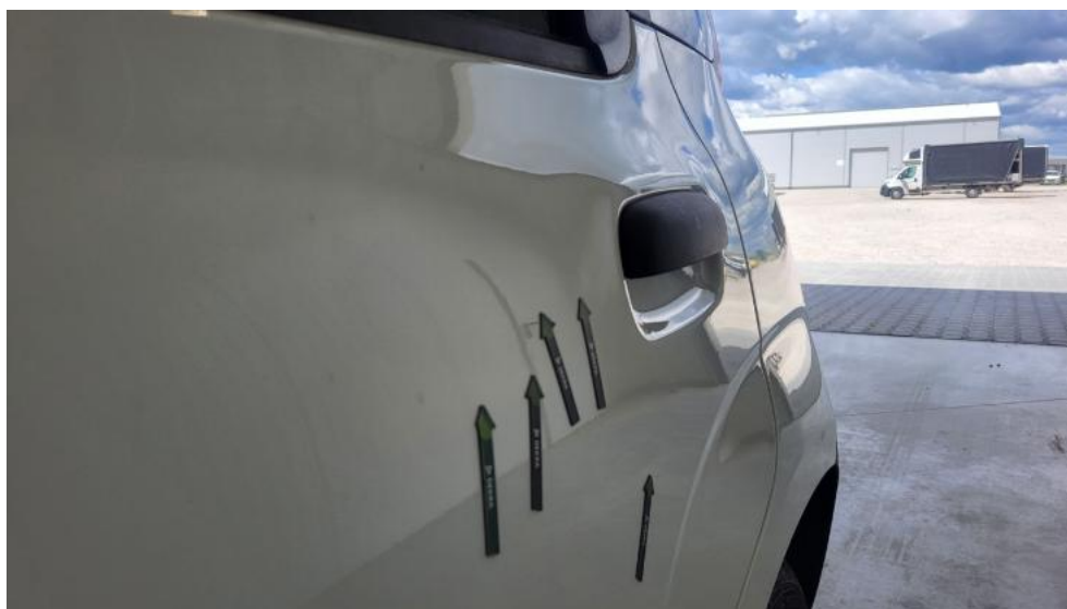
Fot. 49. Drzwi tylne L - Wgniecenie/odkształcenie 1
