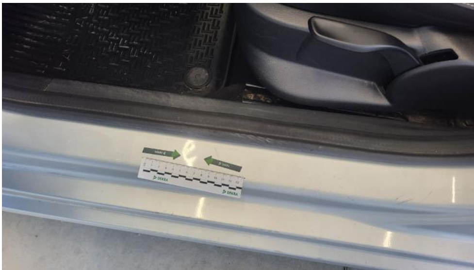
Photo 67. Próg L - Wgniecenie/odkształcenie 1
