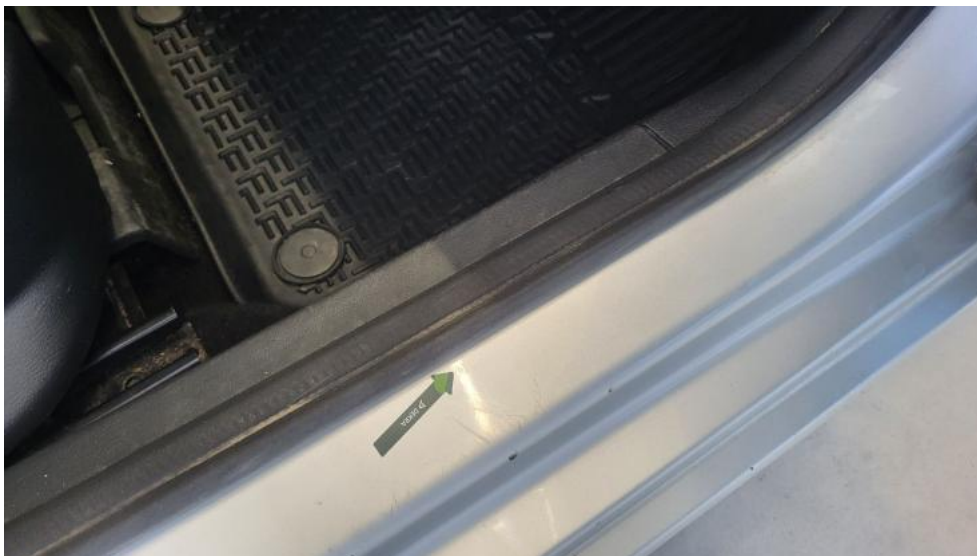
Photo 51. Próg P - Wgniecenie/odkształcenie 1
