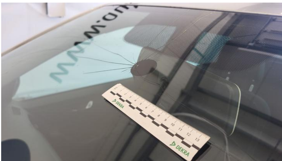
Photo 43. Szyba czołowa - Pęknięcie/rozerwanie 1
