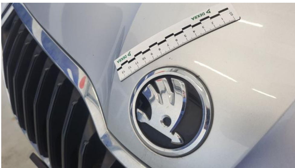
Photo 40. Pokrywa komory silnika - Rysa/odprysk 1
