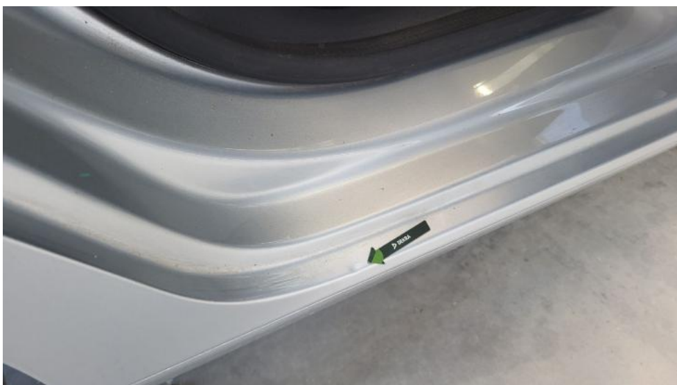
Photo 52. Próg P - Wgniecenie/odkształcenie 2
