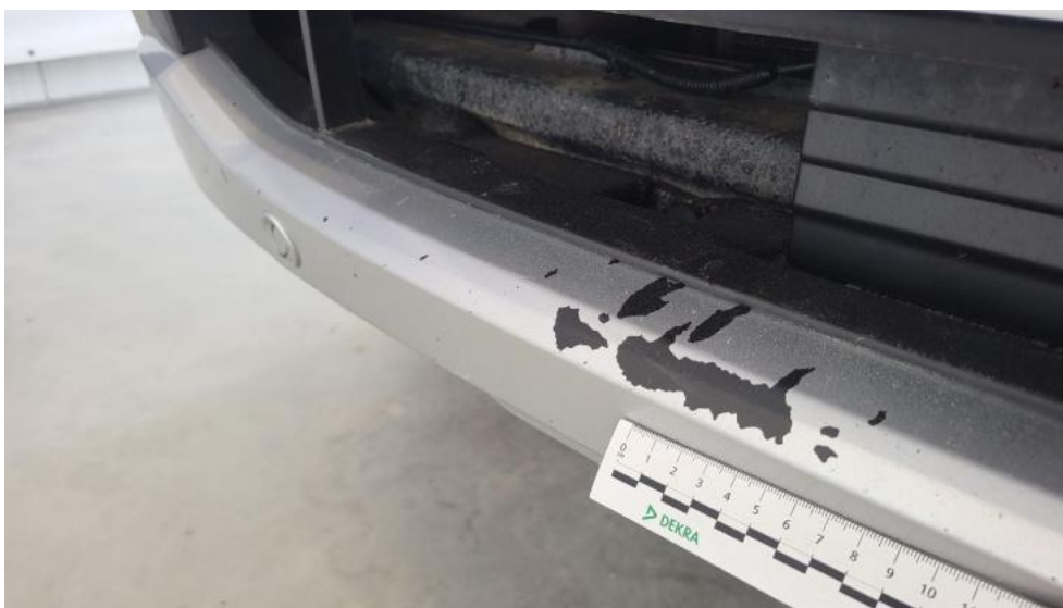
Photo 53. Zderzak przedni cz dolna - Rysa/odprysk 1
