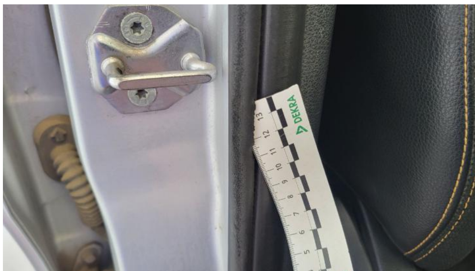
Photo 98. Uszczelka drzwi przednich P - Pęknięcie/rozerwanie 1
