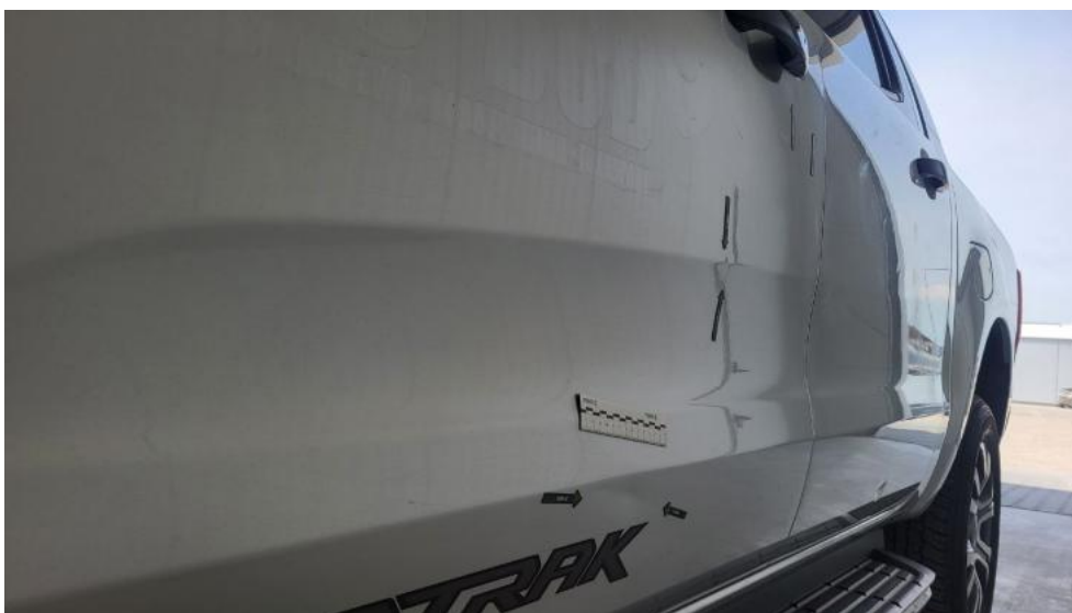
Photo 83. Drzwi przed L - Wgniecenie/odkształcenie 1
