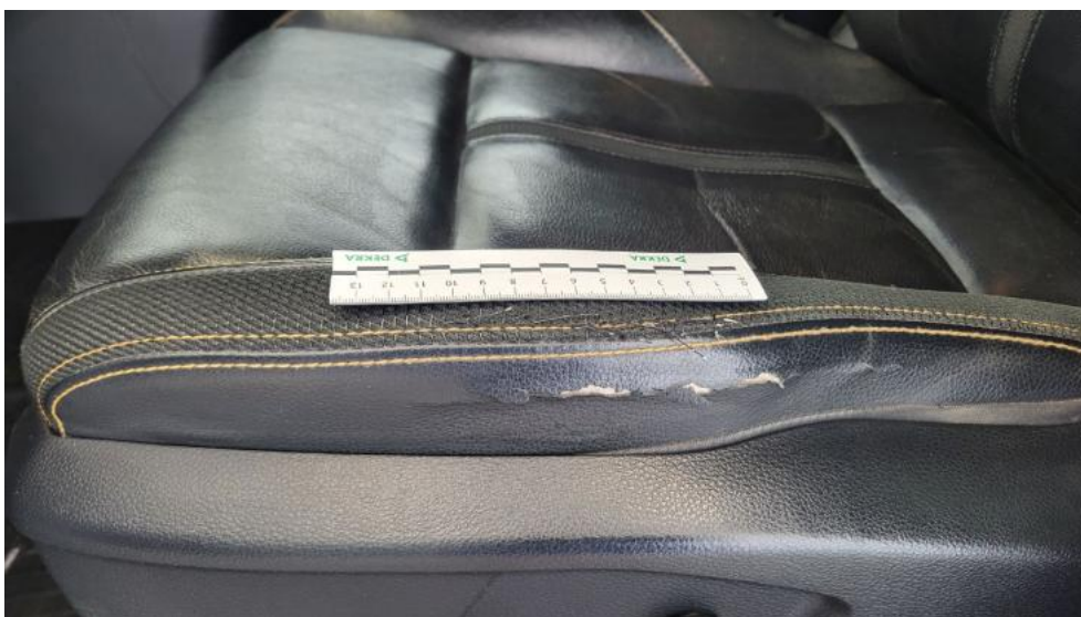
Photo 92. Fotel prz. lew. - Pęknięcie/rozerwanie 1
