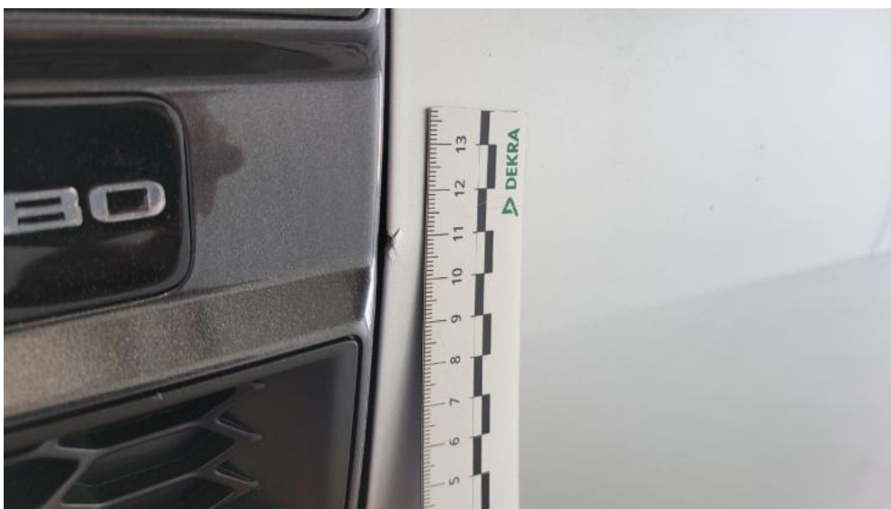
Photo 84. Drzwi przed L - Pęknięcie/rozerwanie 1
