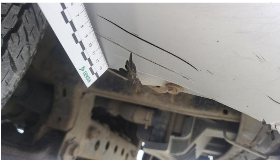
Photo 58. Zderzak przedni cz P - Pęknięcie/rozerwanie 1
