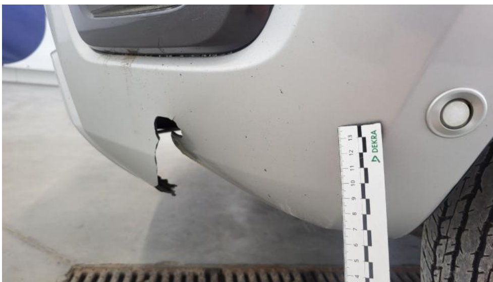
Photo 55. Zderzak przedni cz L - Wgniecenie/odkształcenie 1
