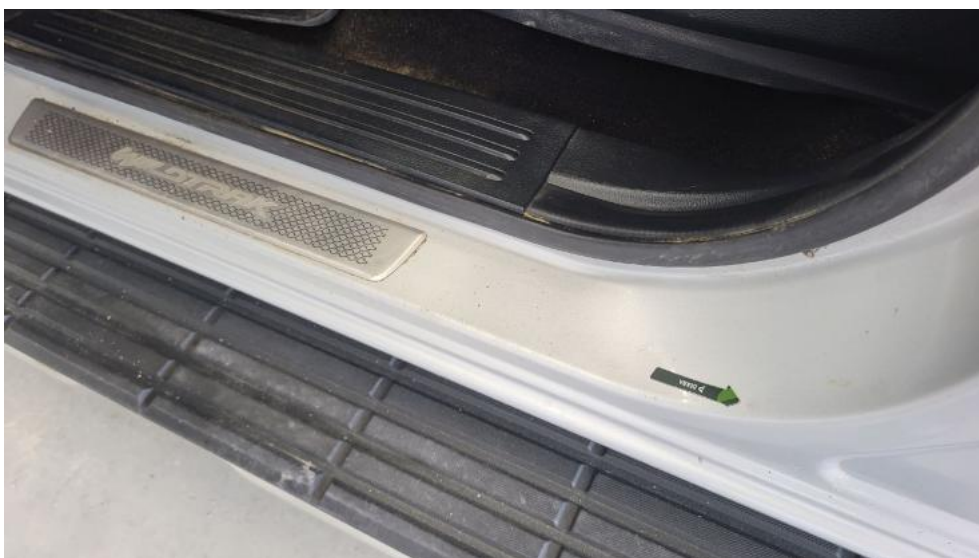
Photo 88. Próg L - Wgniecenie/odkształcenie 1
