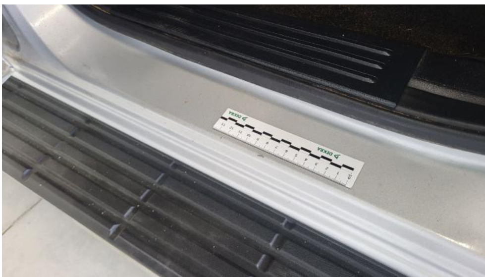
Photo 87. Próg L - Rysa/odprysk 1
