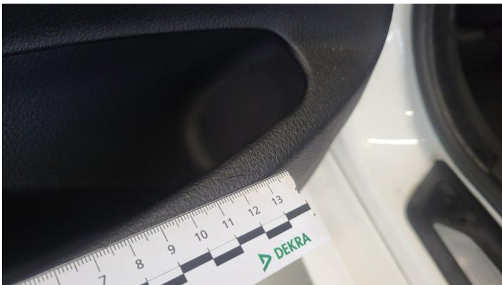
Photo 80. Tapicerka drzwi tylnych L - Rysa/odprysk 1
