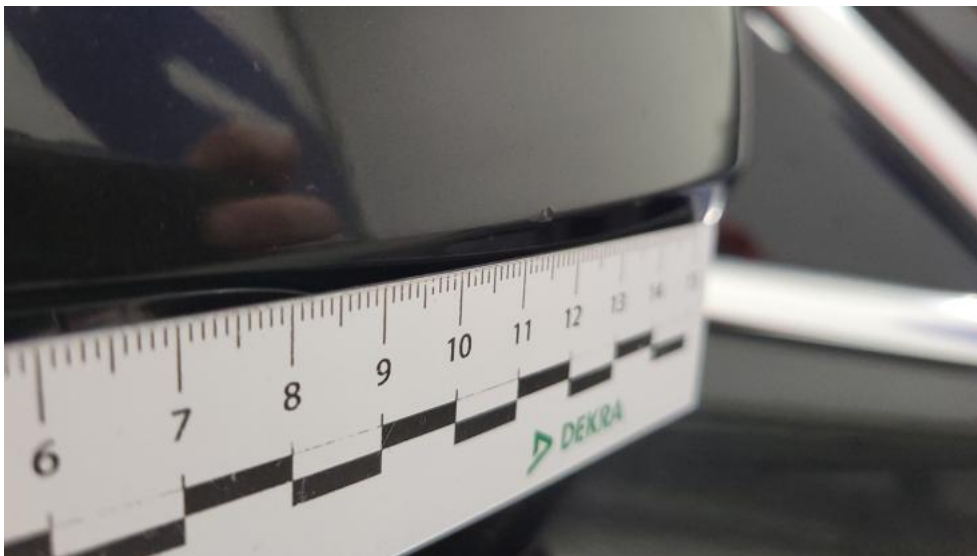
Fot. 47. Lusterko zew P - Rysa/odprysk 1
