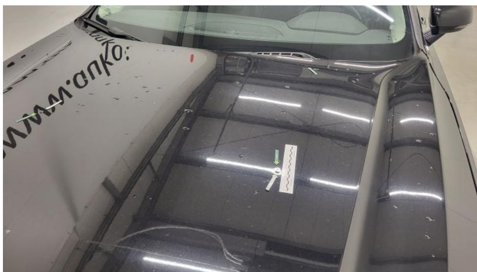
Fot. 42. Pokrywa komory silnika - Wgniecenie/odkształcenie 1
