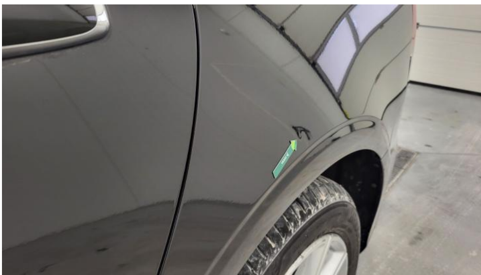
Fot. 55. Błotnik tylny L / Ściana boczna L - Wgniecenie/odkształcenie 1
