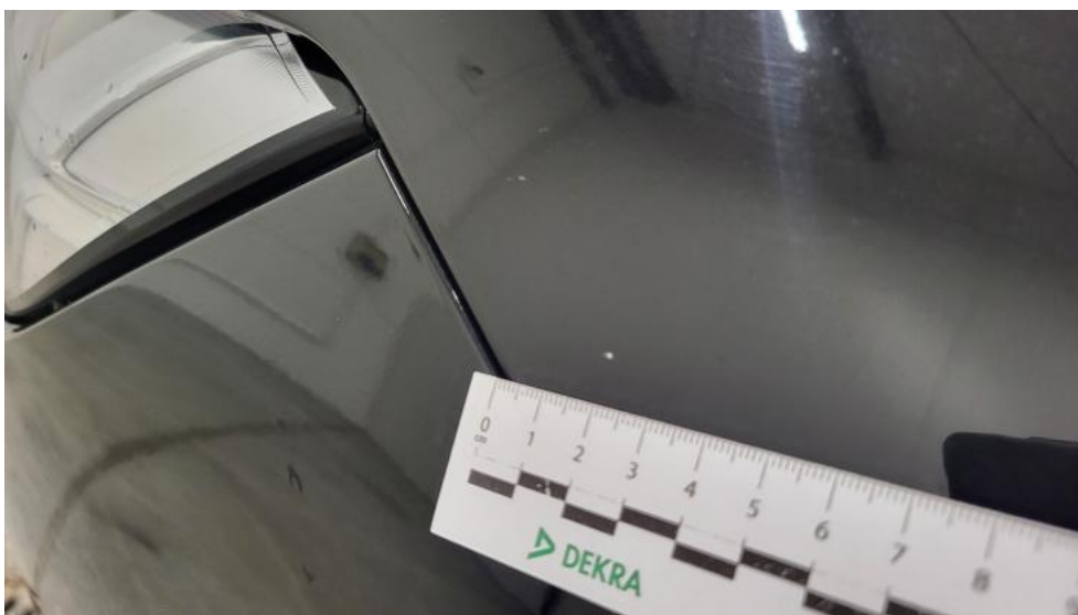
Fot. 60. Błotnik przedni L - Rysa/odprysk 1
