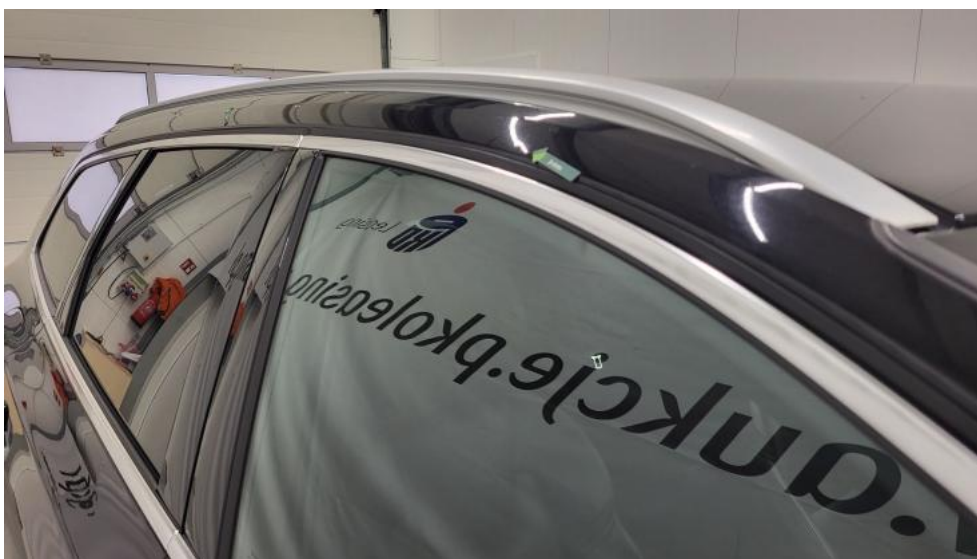
Fot. 49. Stupek przedni P - Wgniecenie/odkształcenie 1
