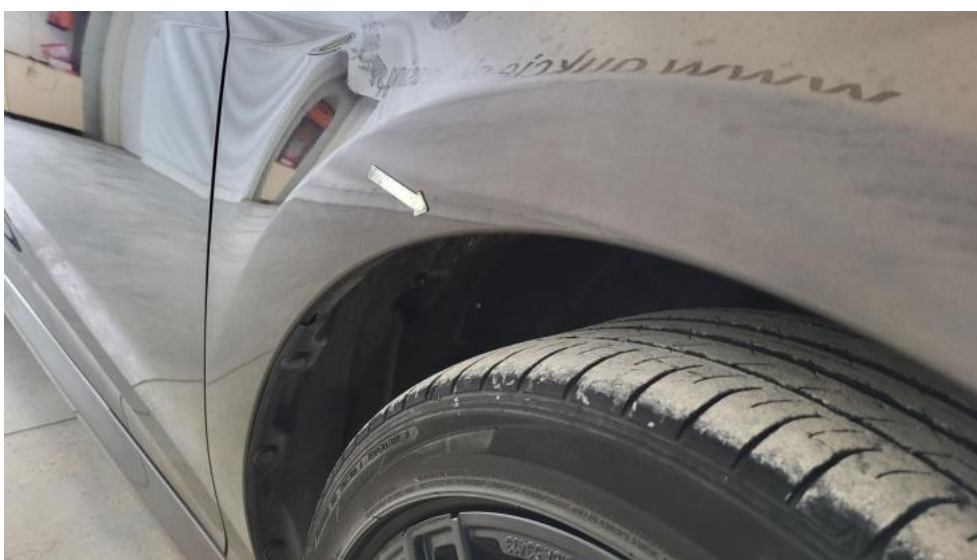
Fot. 40. Błotnik przedni P - Rysa/odprysk 1
