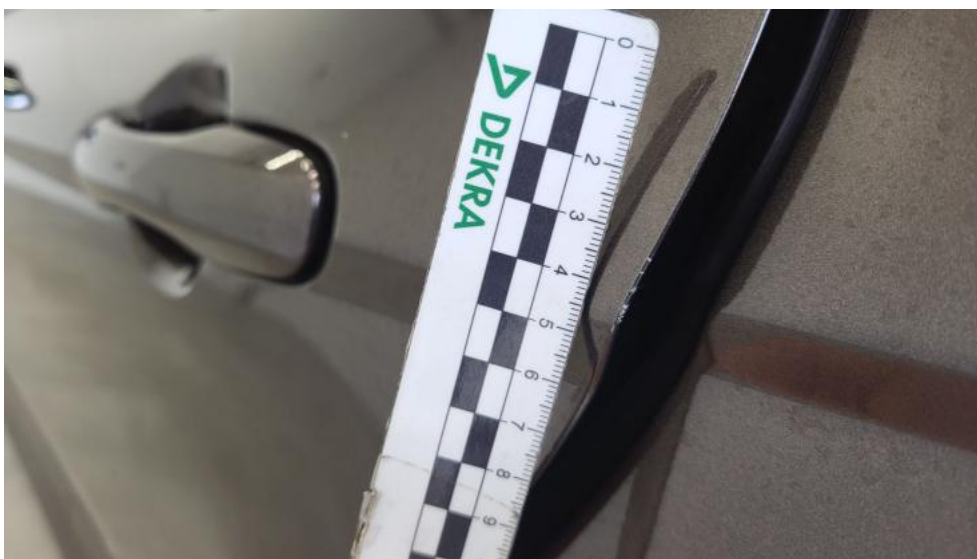
Fot. 49. Drzwi tylne L - Rysa/odprysk 1
