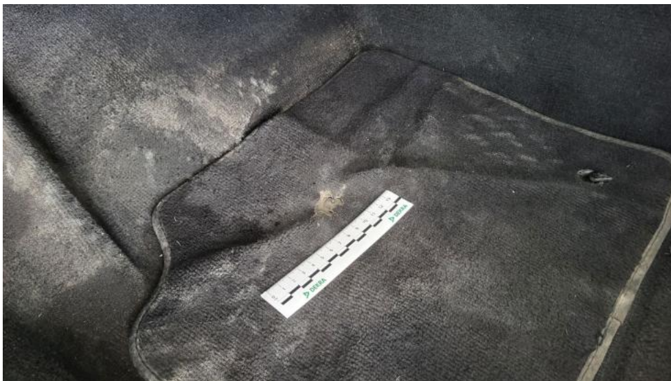
Photo 91. Dywanik prze L - Pęknięcie/rozerwanie 1
