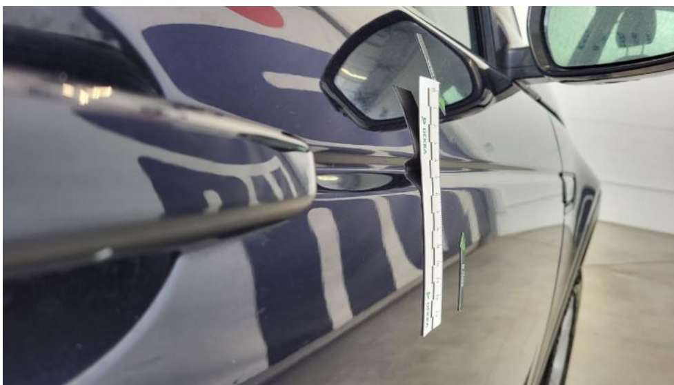
Photo 52. Drzwi przednie P - Wgniecenie/odkształcenie 1
