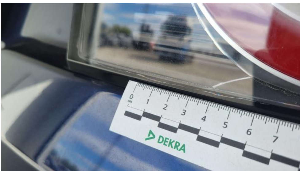
Photo 60. Lampa tylna wew P - Pęknięcie/rozerwanie 1
