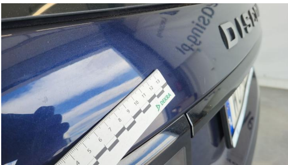
Photo 64. Pokrywy bagażnika - Rysa/odprysk 2
