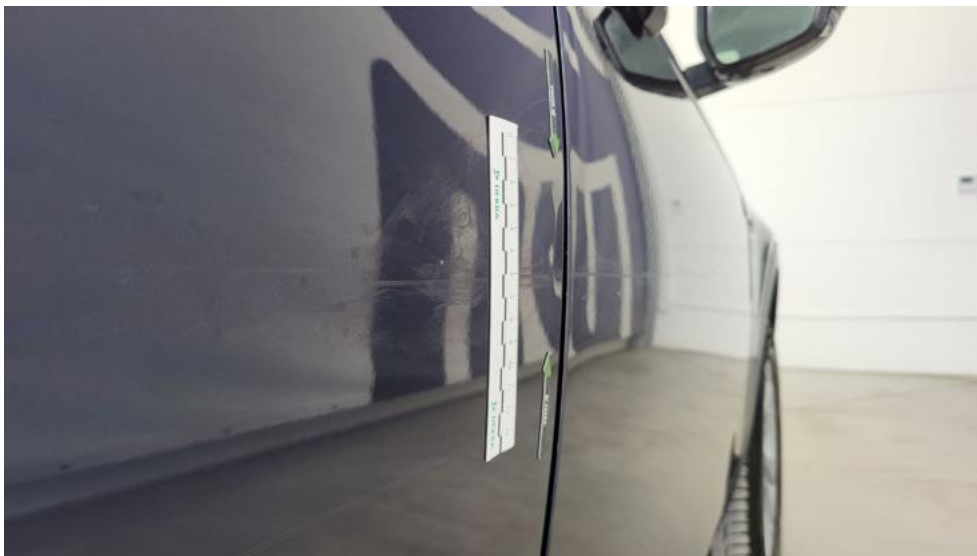
Photo 55. Drzwi tylne P - Wgniecenie/odkształcenie 1
