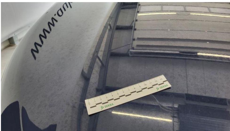
Photo 40. Pokrywa komory silnika - Rysa/odprysk 1
