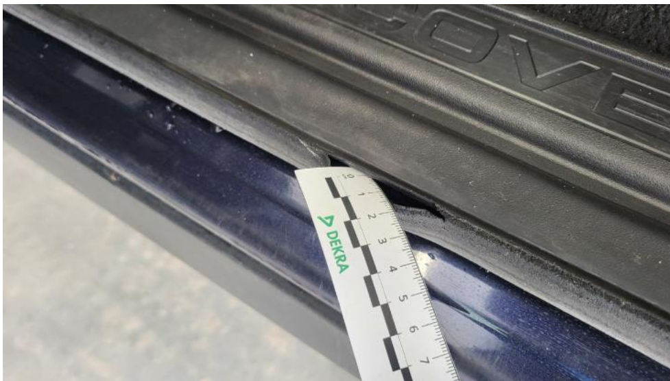
Photo 87. Uszczelka drzwi przednich L - Pęknięcie/rozerwanie 1
