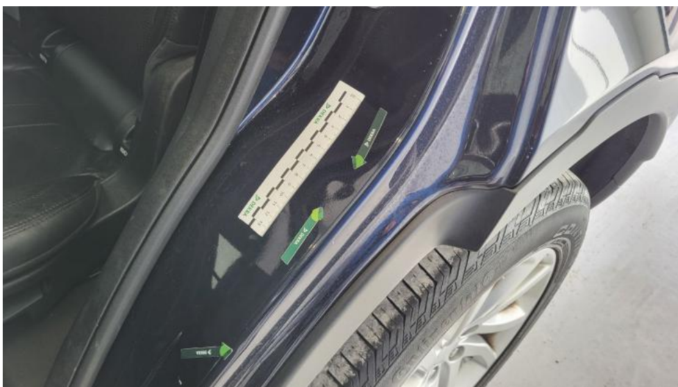
Photo 72. Błotnik tylny L / Ściana boczna L - Wgniecenie/odkształcenie 2
