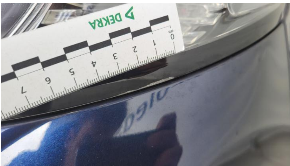
Photo 62. Lampa tylna zew P - Pęknięcie/rozerwanie 1
