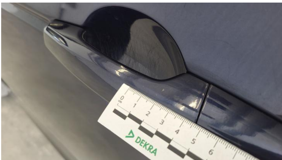
Photo 78. Klamka drzwi prz L - Rysa/odprysk 1
