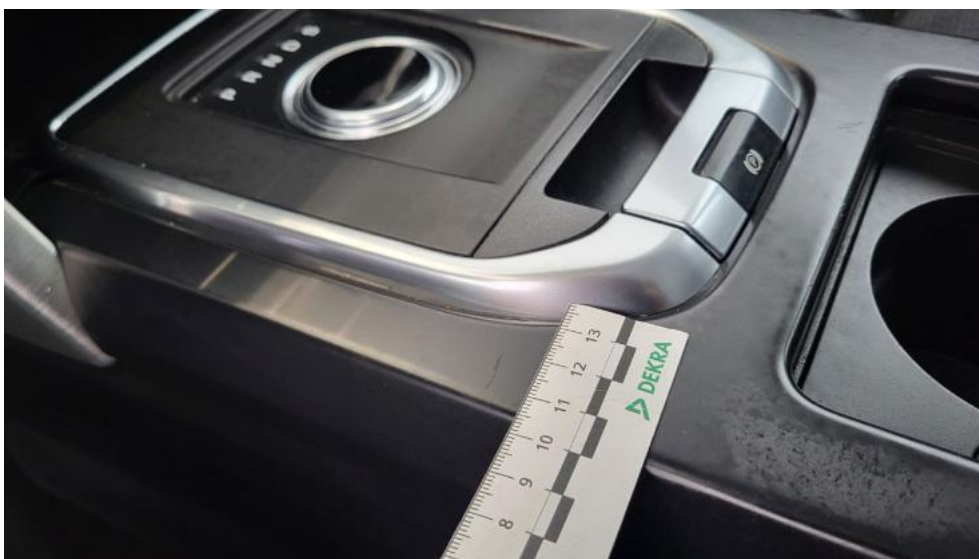
Photo 83. Konsola tunelu śr. - Rysa/odprysk 1
