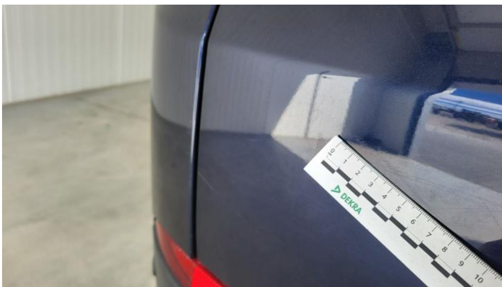
Photo 63. Pokrywy bagażnika - Rysa/odprysk 1
