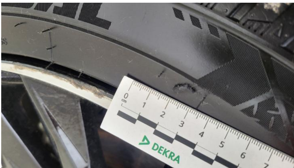
Fot. 61. Opona przednia L - Pęknięcie/rozerwanie 1
