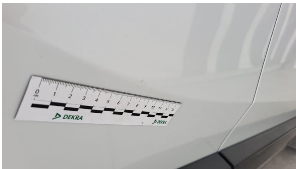
Fot. 42. Drzwi tylne P - Rysa/odprysk 1
