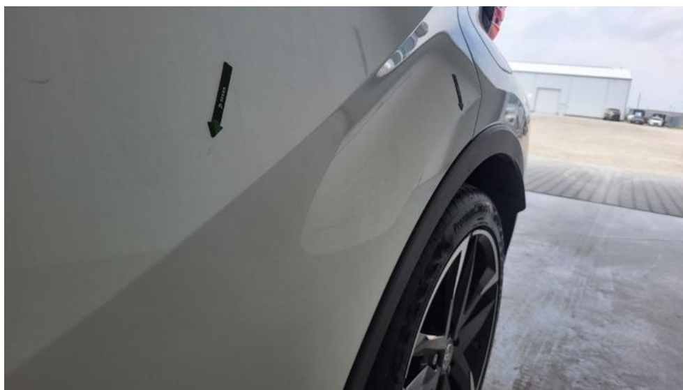
Fot. 57. Drzwi tylne L - Wgniecenie/odkształcenie 1
