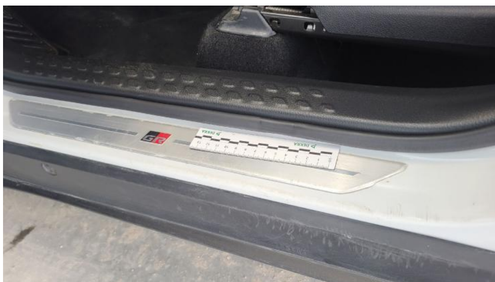
Fot. 58. Próg L - Rysa/odprysk 1
