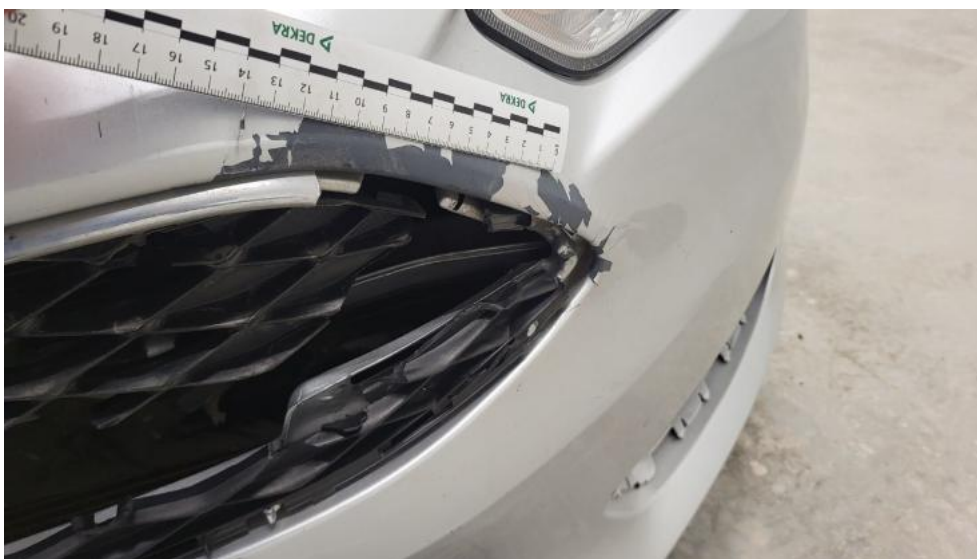
Fot. 53. Listwa śr zderzaka przedniego - Pęknięcie/rozerwanie 2
