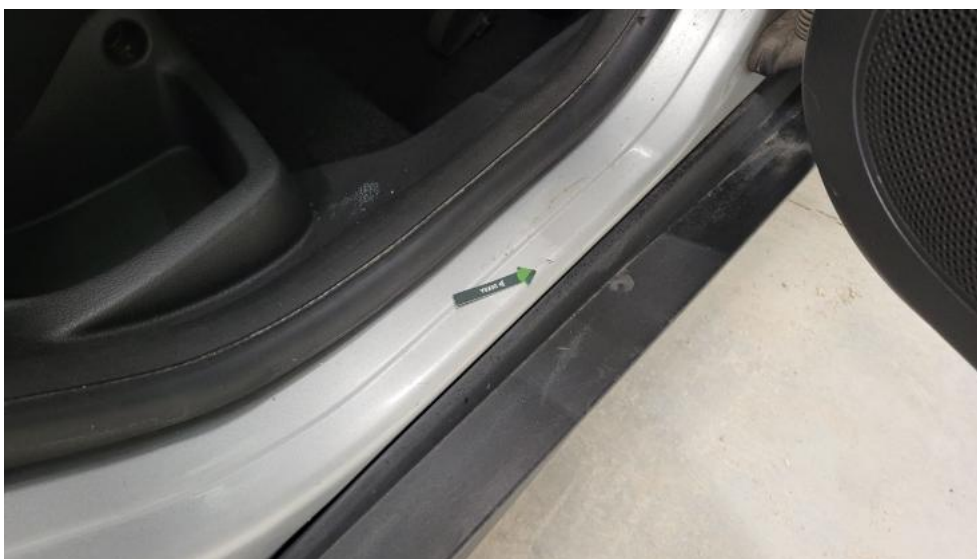
Fot. 81. Próg P - Wgniecenie/odkształcenie 2
