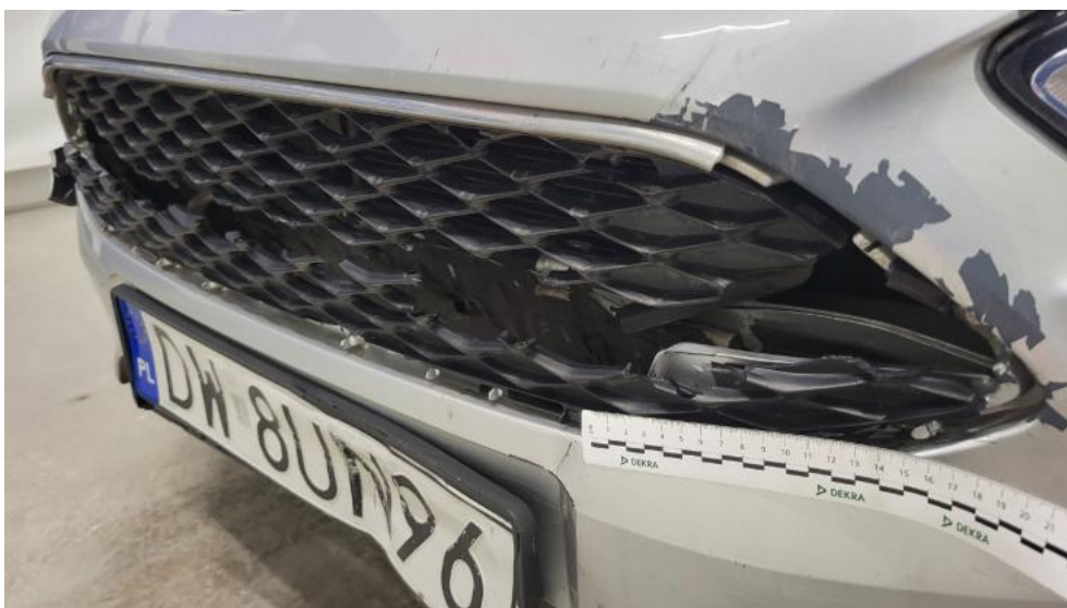
Fot. 48. Atrapa przednia - Pęknięcie/rozerwanie 1
