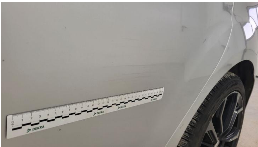
Fot. 100. Drzwi tylne L - Rysa/odprysk 1
