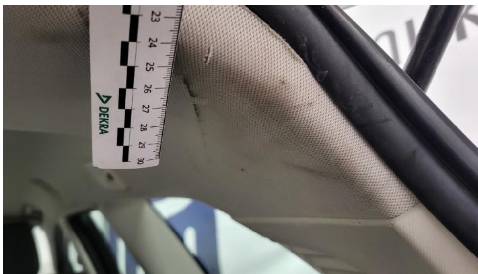
Fot. 127. Podsufitka - Pęknięcie/rozerwanie 1
