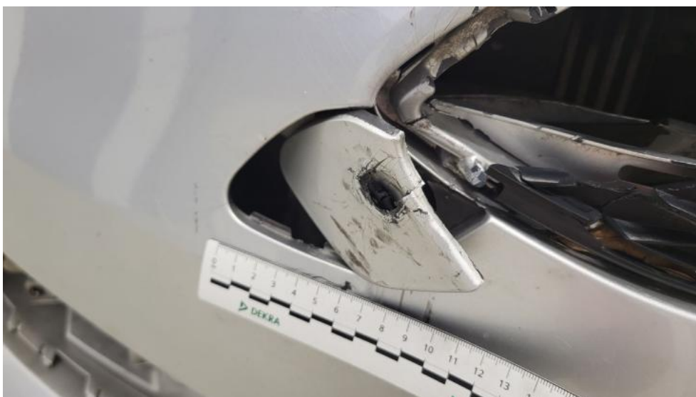
Fot. 60. Zaślepka prz haka hol. - Pęknięcie/rozerwanie 1
