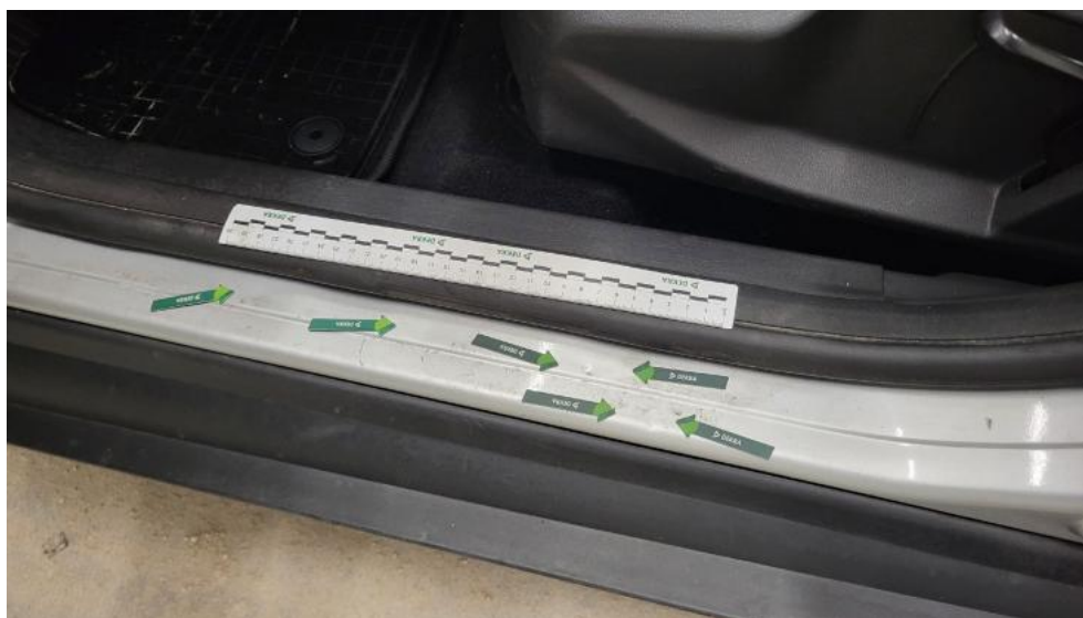
Fot. 105. Próg L - Wgniecenie/odkształcenie 1
