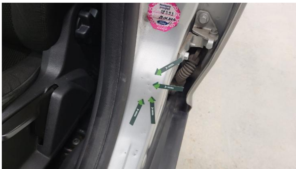
Fot. 107. Słupek środkowy L - Wgniecenie/odkształcenie 1
