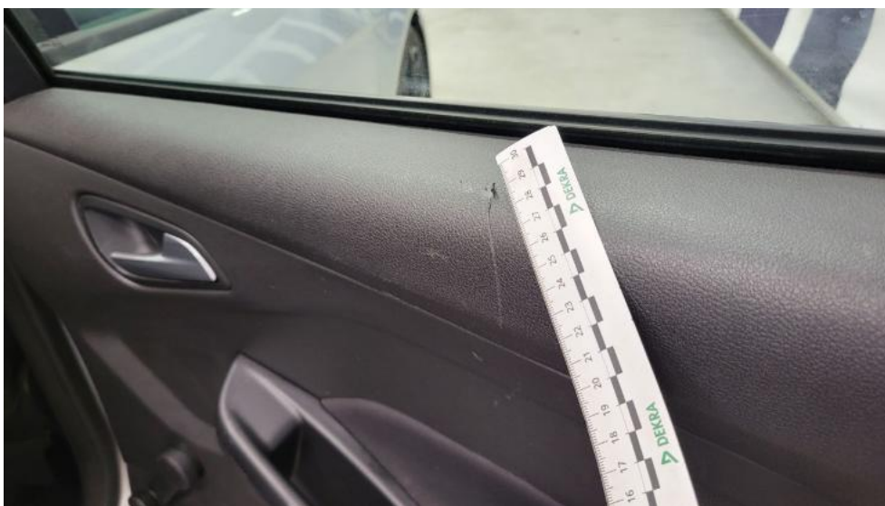
Fot. 121. Tapicerka drzwi tylnych P - Rysa/odprysk 1
