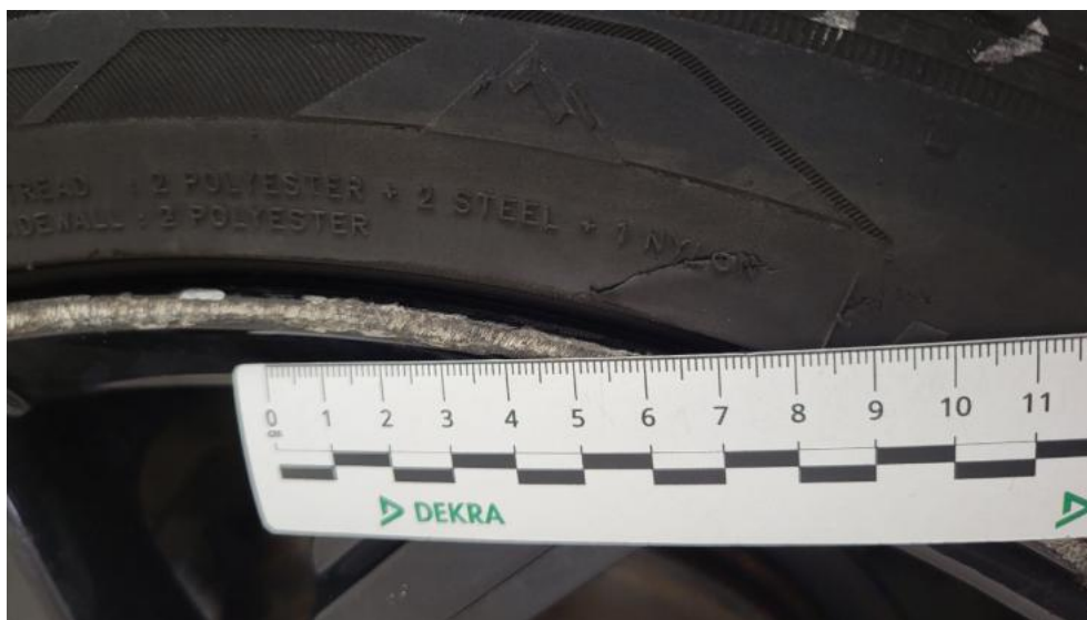
Fot. 111. Opona przednia L - Pęknięcie/rozerwanie 1
