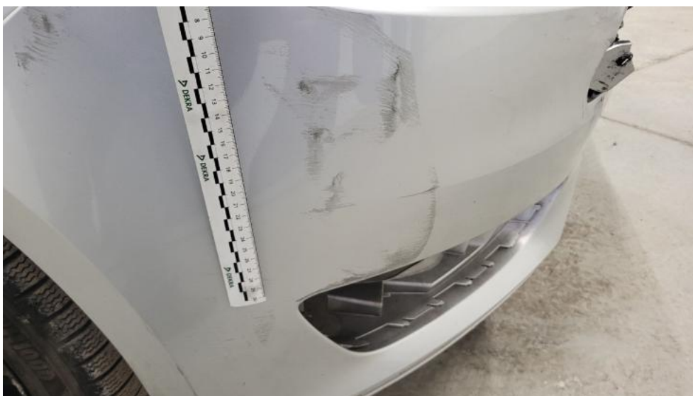
Fot. 63. Zderzak - Rysa/odprysk 1
