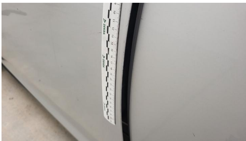
Fot. 98. Drzwi przed L - Rysa/odprysk 1
