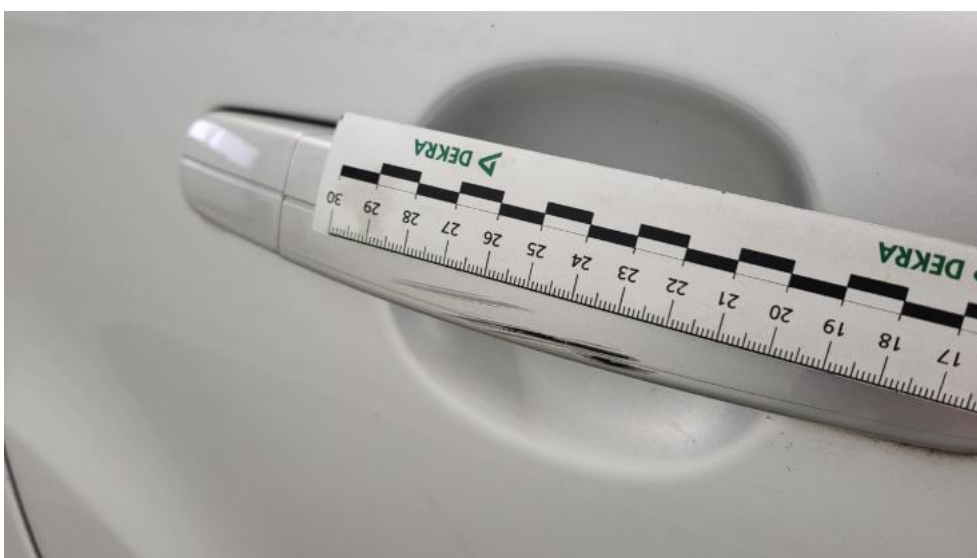
Fot. 78. Klamka drzwi tyl P - Rysa/odprysk 1
