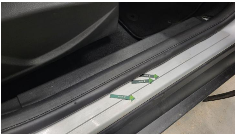
Fot. 80. Próg P - Wgniecenie/odkształcenie 1
