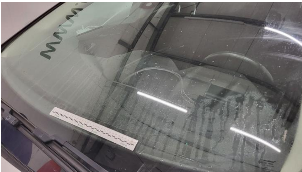
Fot. 57. Szyba czołowa - Pęknięcie/rozerwanie 1
