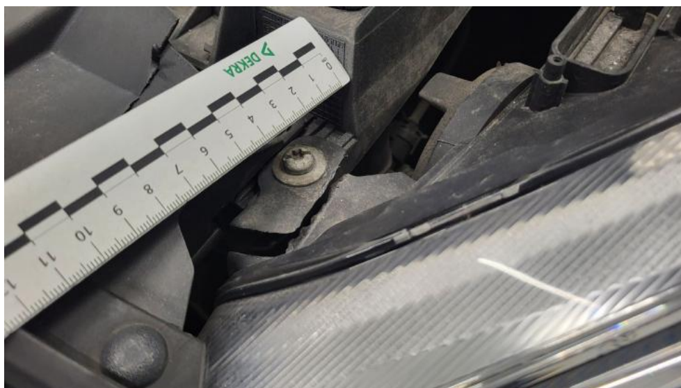
Fot. 112. Reflektor L - Pęknięcie/rozerwanie 1
