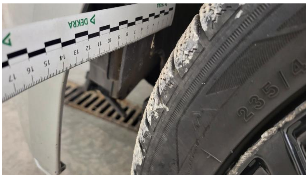
Fot. 110. Nadkole przednie L - Pęknięcie/rozerwanie 1
