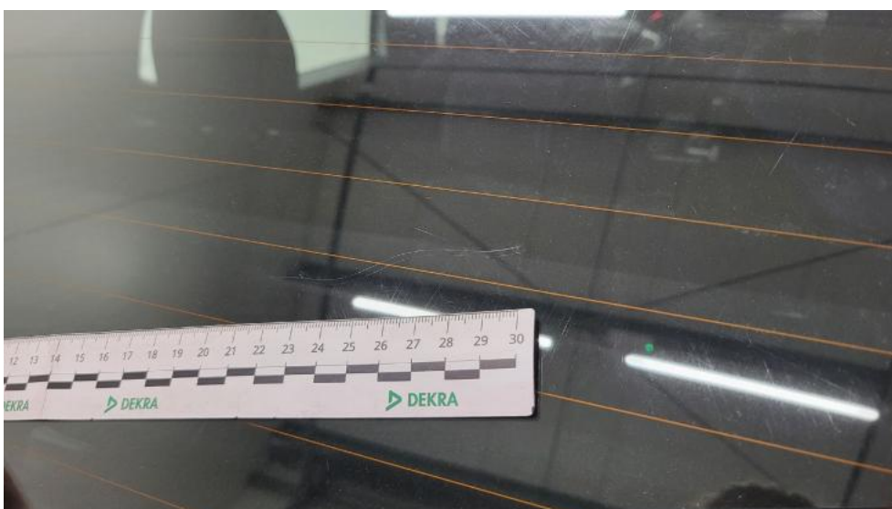
Fot. 54. Szyba tylna - Rysa/odprysk 1
