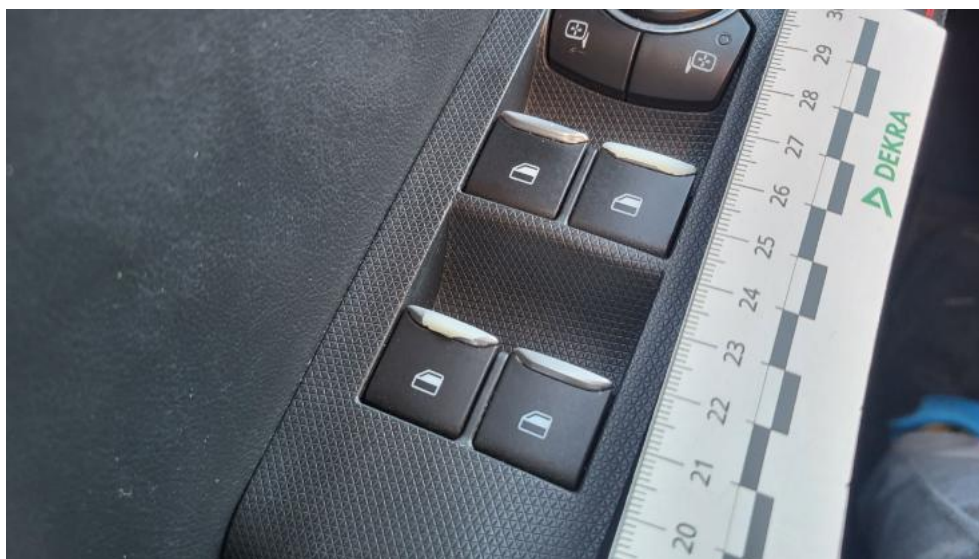
Fot. 69. Włączniki/przełączniki drzwi prz L - Rysa/odprysk 1
