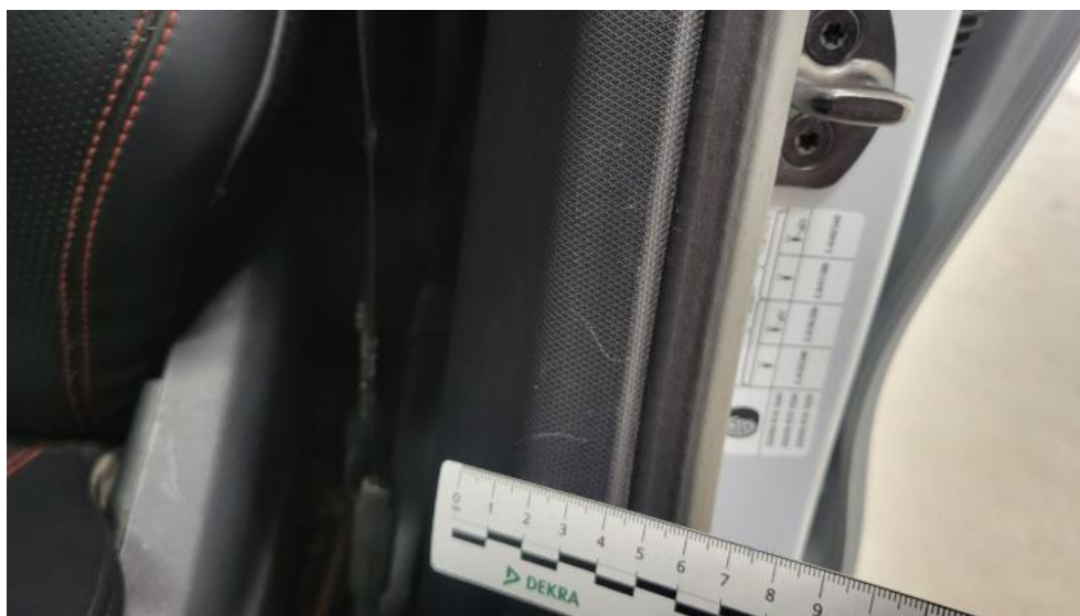
Fot. 70. Wykładzina(y) słupka środkowego L - Rysa/odprysk 1
