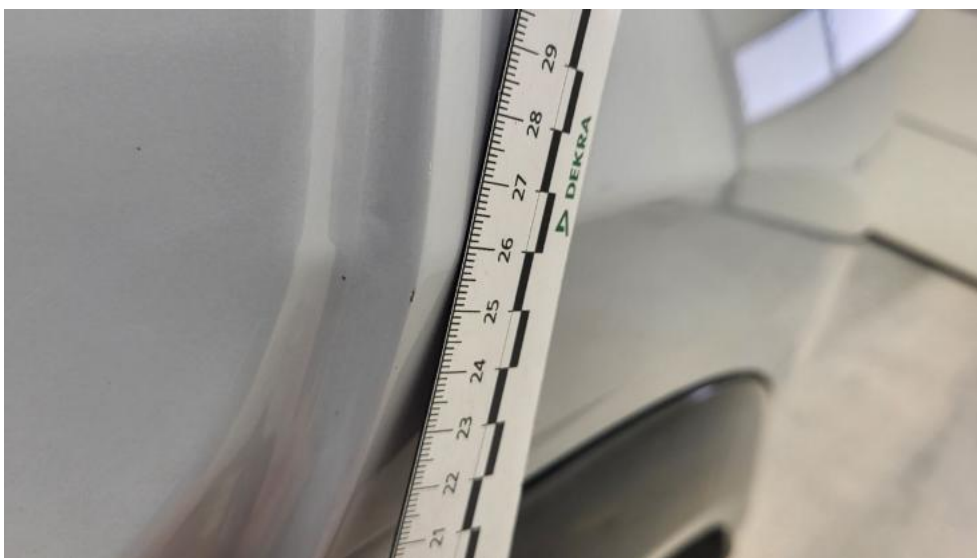
Fot. 52. Błotnik tylny L / Ściana boczna L - Rysa/odprysk 2
