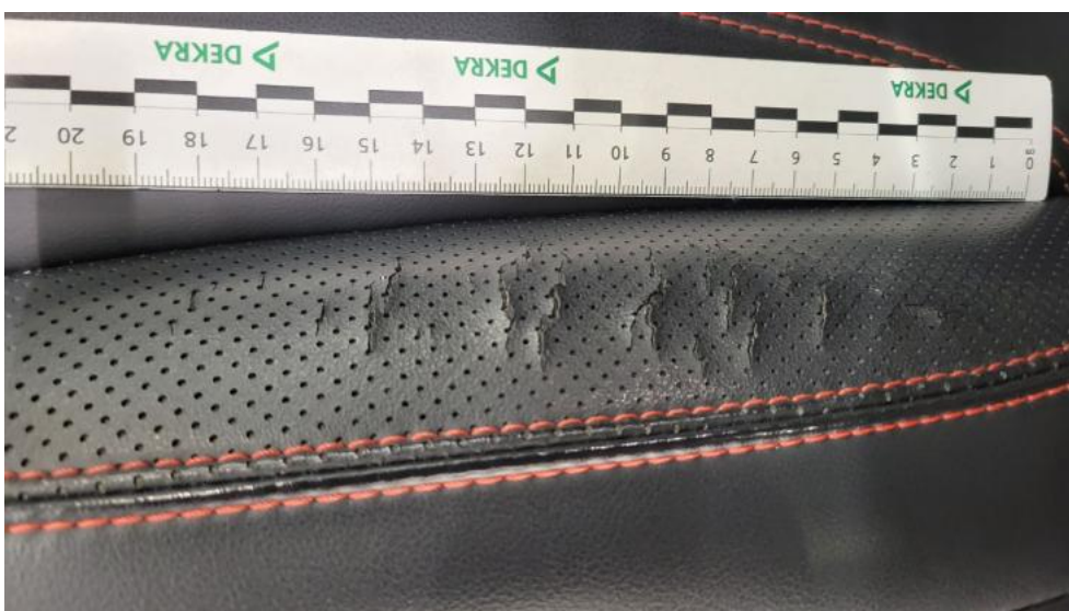
Fot. 64. Fotel prz. lew. - Pęknięcie/rozerwanie 1
