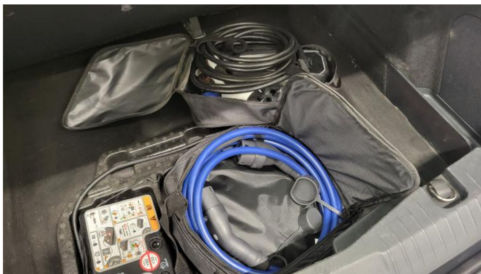
Fot. 34. Przewód ładowania baterii trakcyjnej
