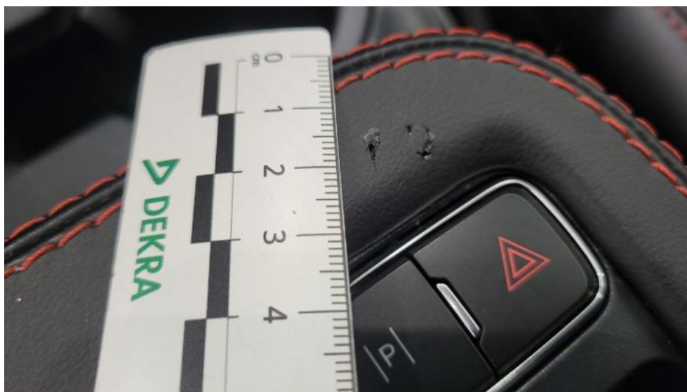
Fot. 61. Konsola tunelu śr. - Pęknięcie/rozerwanie 1
