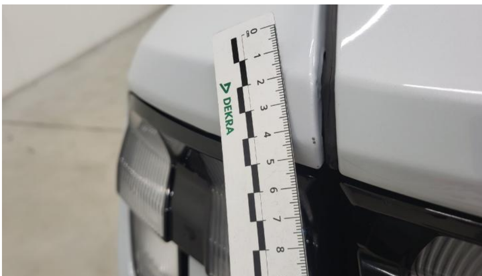
Fot. 51. Błotnik tylny L / Ściana boczna L - Rysa/odprysk 1
