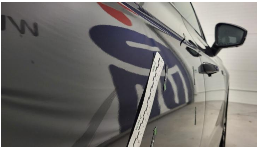
Photo 67. Drzwi tylne P - Wgniecenie/odkształcenie 1
