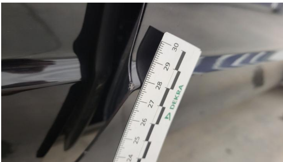
Photo 68. Listwa drzwi przednich P - Rysa/odprysk 1
