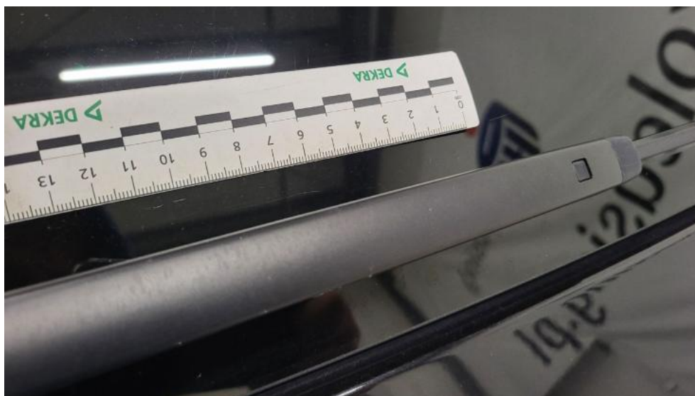
Photo 70. Szyba tylna - Rysa/odprysk 1
