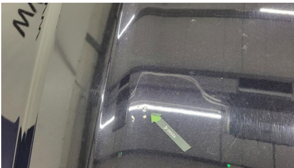
Photo 58. Pokrywa komory silnika - Wgniecenie/odkształcenie 2
