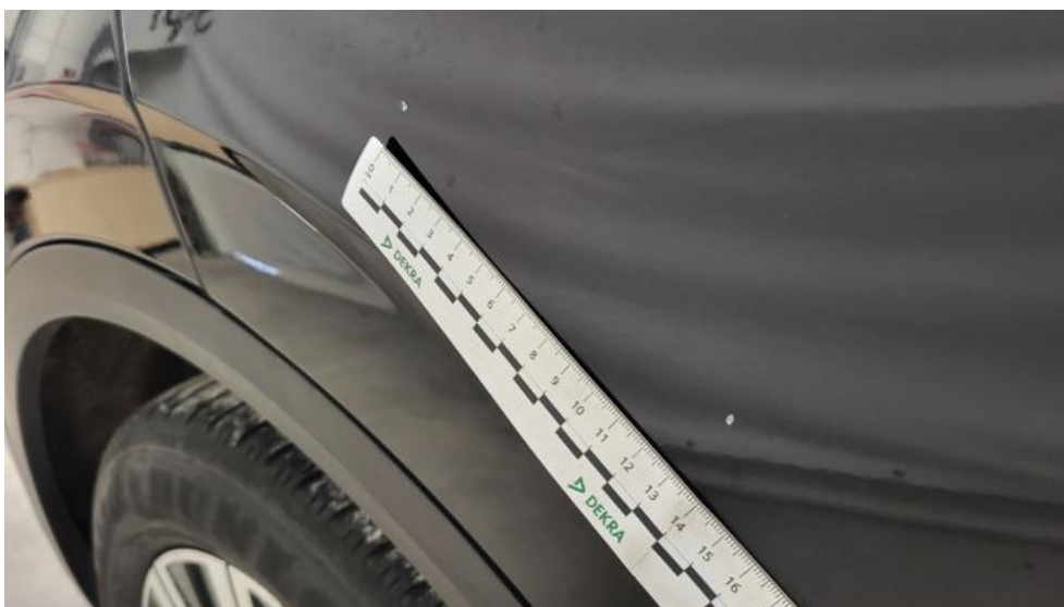
Photo 66. Drzwi tylne P - Rysa/odprysk 1
