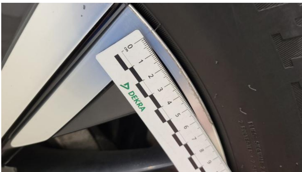
Photo 78. Felga Aluminiowa przednia L - Rysa/odprysk 1
