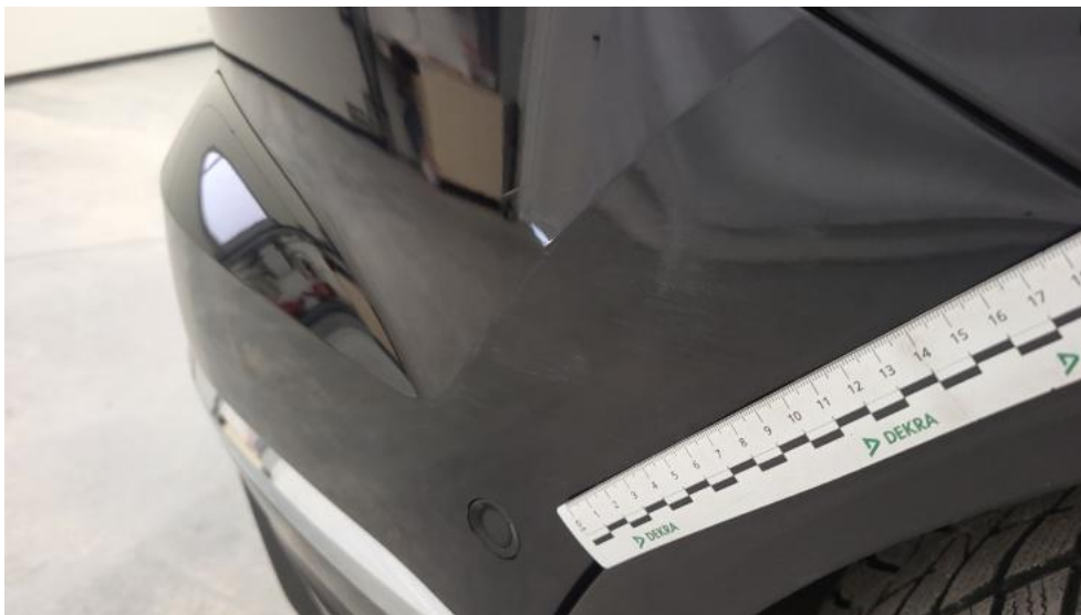
Photo 71. Zderzak tylny - Rysa/odprysk 1
