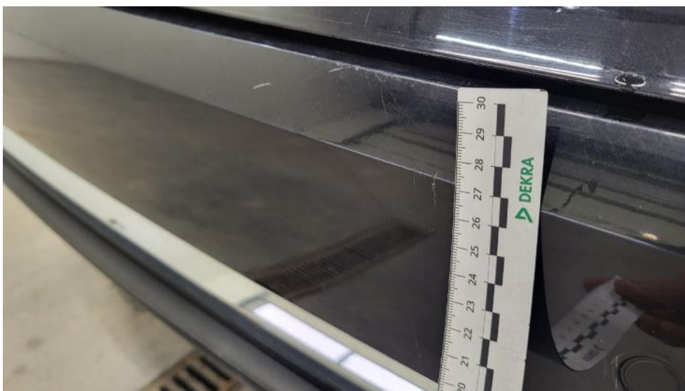
Photo 72. Zderzak tylny - Rysa/odprysk 2
