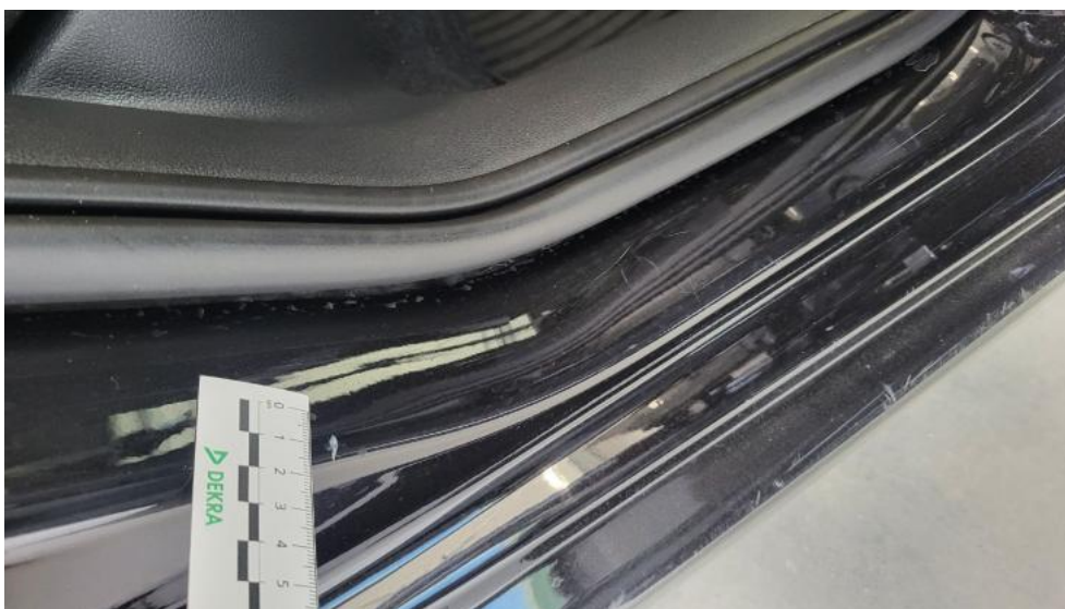
Photo 43. Próg P - Rysa/odprysk 1
