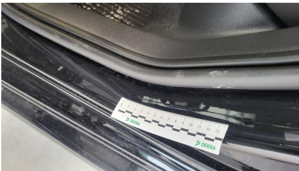
Photo 52. Próg L - Rysa/odprysk 1
