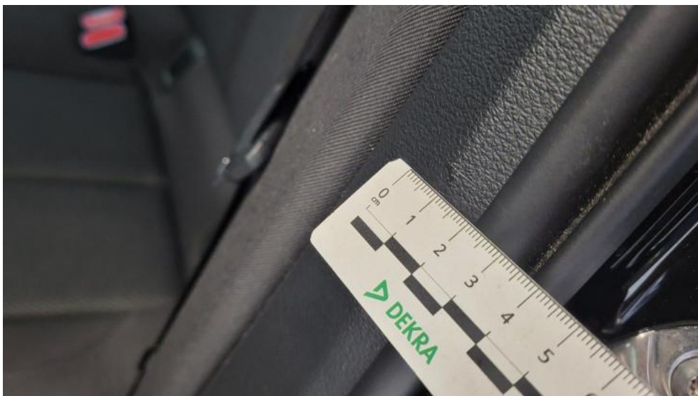
Photo 68. Wykładzina(y) słupka tylnego L - Rysa/odprysk 1
