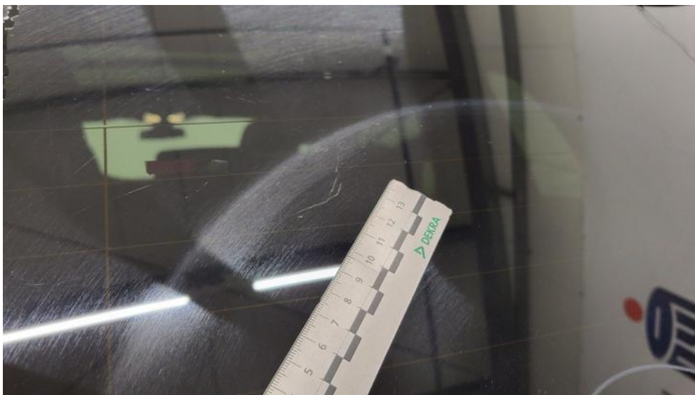
Fot. 65. Szyba tylna - Rysa/odprysk 1
