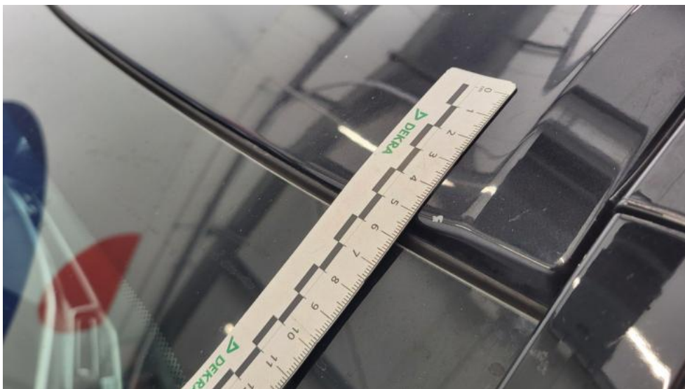
Fot. 71. Dach - Rysa/odprysk 2
