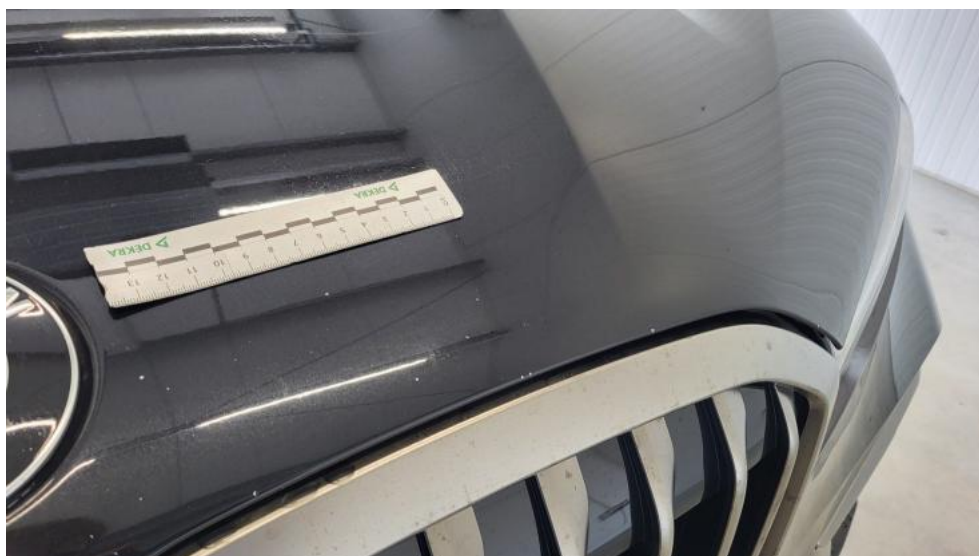
Fot. 50. Pokrywa komory silnika - Rysa/odprysk 1
