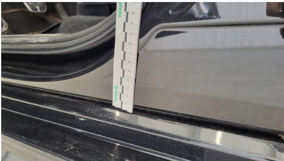
Fot. 85. Próg L - Rysa/odprysk 2
