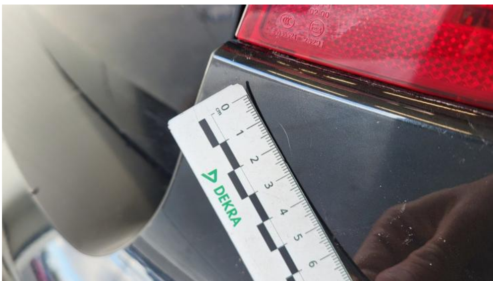
Fot. 66. Zderzak tylny - Rysa/odprysk 1
