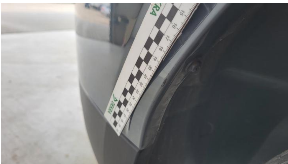
Fot. 52. Zderzak tylny cz P - Rysa/odprysk 1
