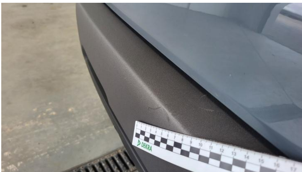
Fot. 51. Zderzak tylny - Rysa/odprysk 1
