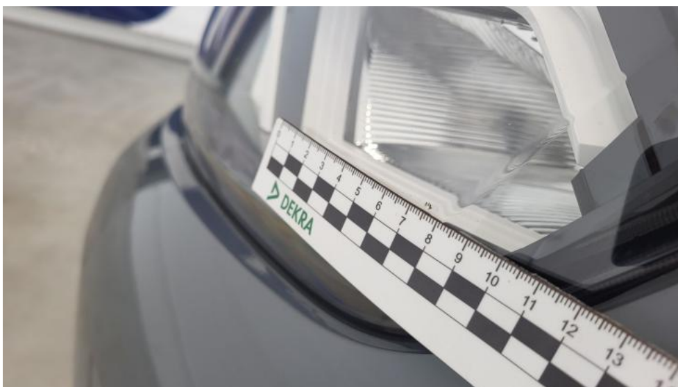
Fot. 58. Reflektor L - Rysa/odprysk 1
