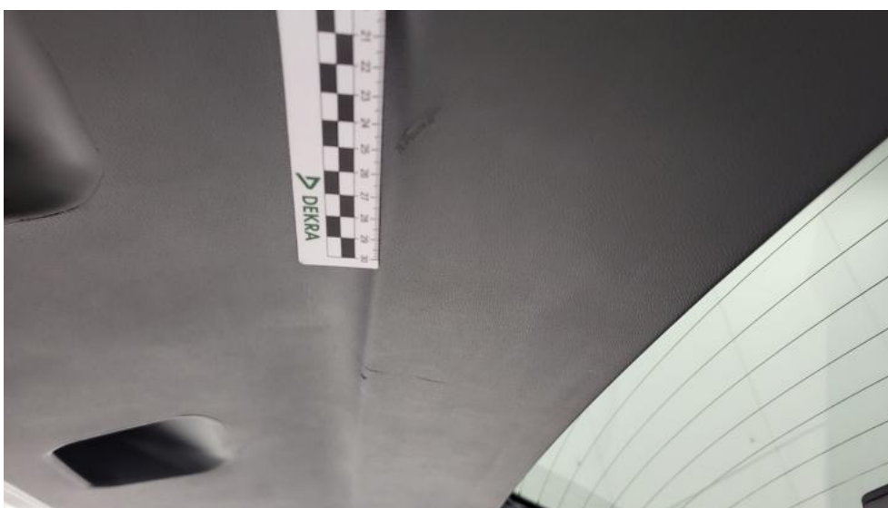
Fot. 62. Wykładzina pokrywy tylnej - Rysa/odprysk 1
