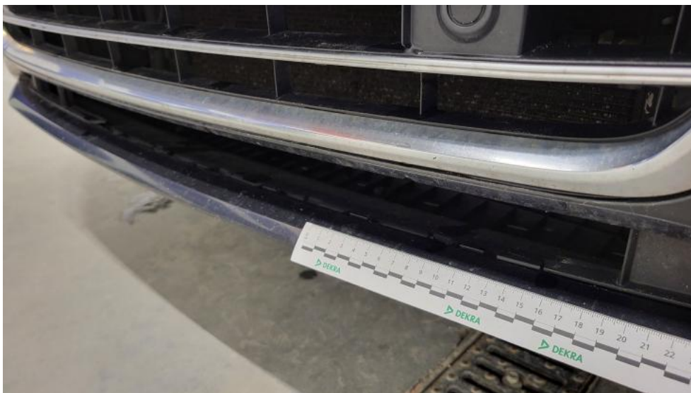
Fot. 40. Krata zderzaka prz. - Pęknięcie/rozerwanie 1
