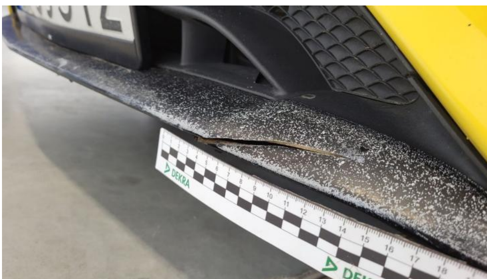
Fot. 40. Spoiler zderzaka przedniego - Pęknięcie/rozerwanie 1
