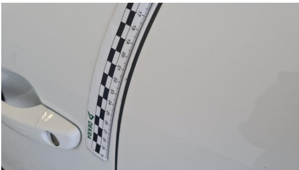
Fot. 46. Drzwi przed L - Rysa/odprysk 1
