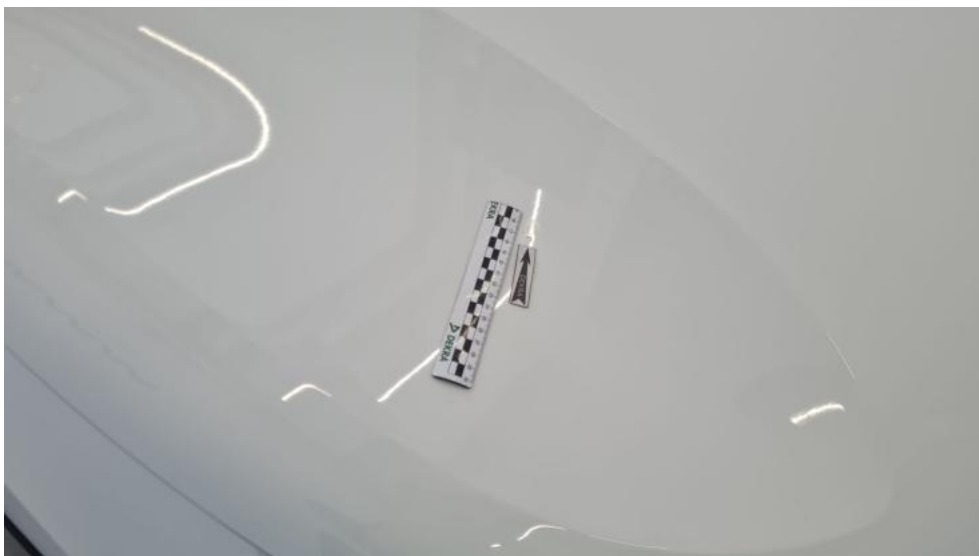
Fot. 36. Pokrywa komory silnika - Wgniecenie/odkształcenie 1
