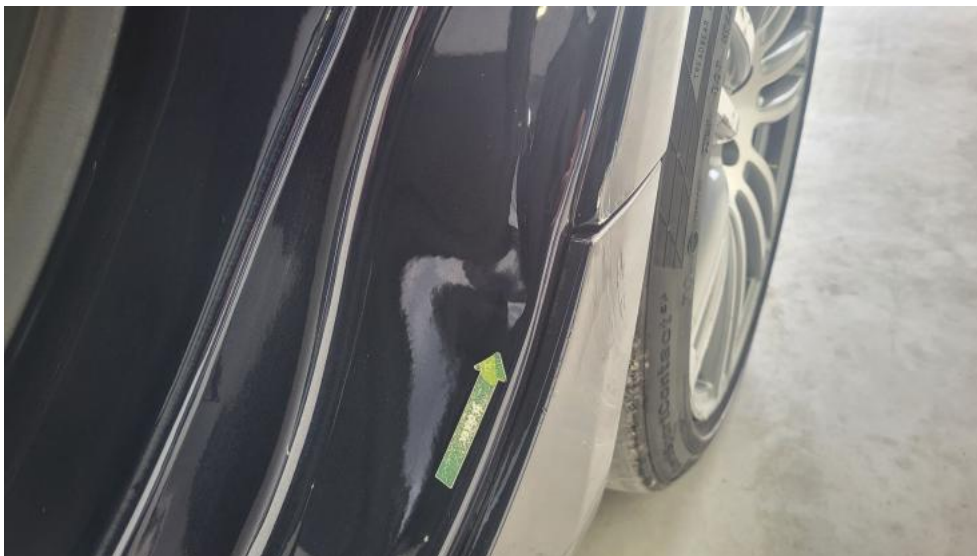
Fot. 59. Błotnik tylny L / Ściana boczna L - Wgniecenie/odkształcenie 2
