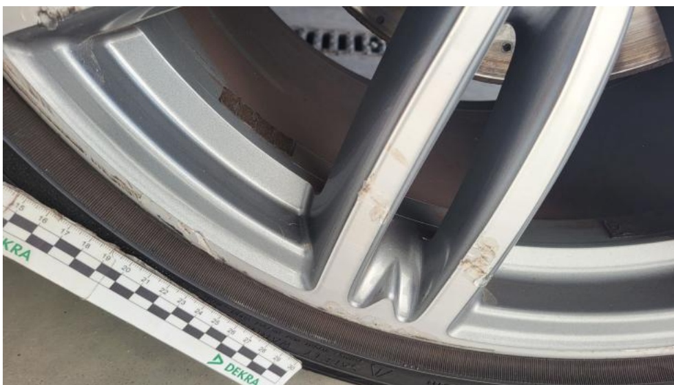
Fot. 63. Felga aluminiowa tylna L() - Rysa/odprysk 3
