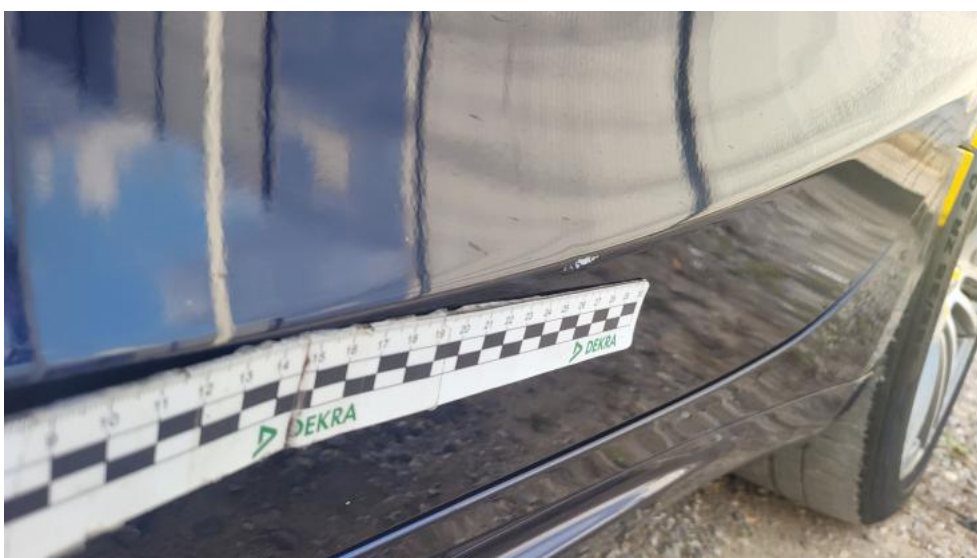
Fot. 70. Drzwi tylne L() - Wgniecenie/odkształcenie 3
