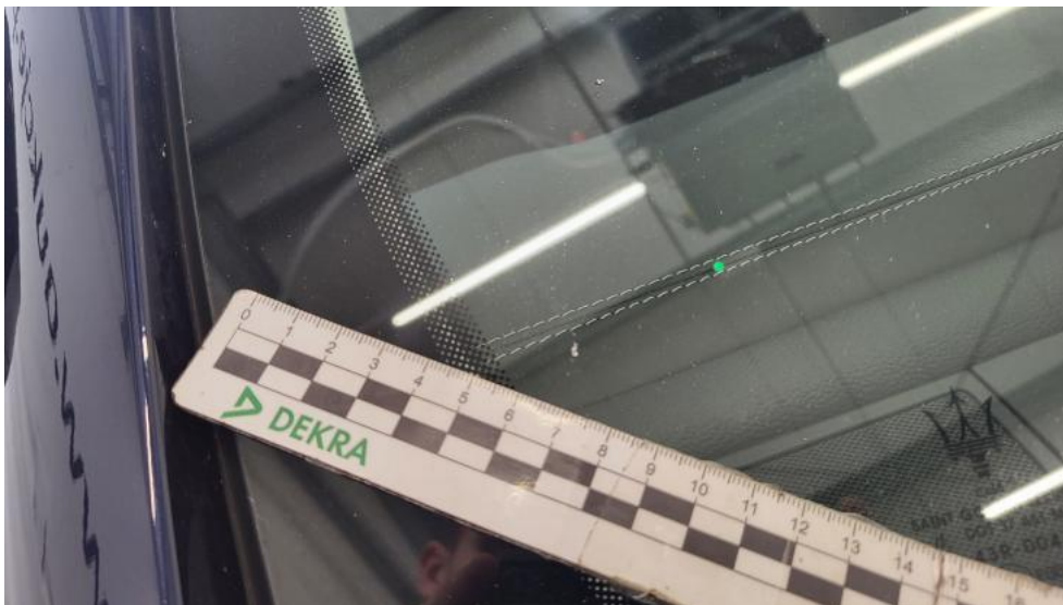
Fot. 45. Szyba czołowa() - Rysa/odprysk 3
