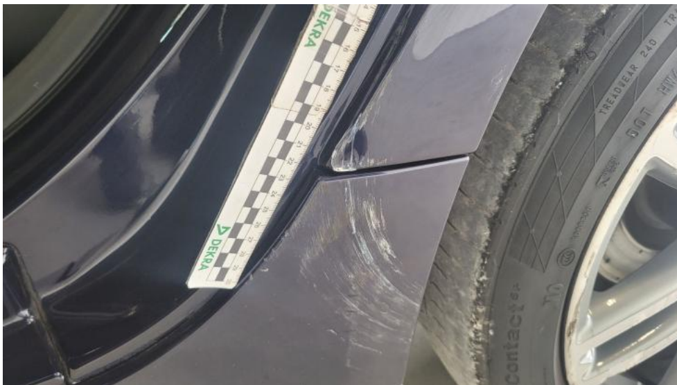
Fot. 57. Błotnik tylny L / Ściana boczna L - Rysa/odprysk 2
