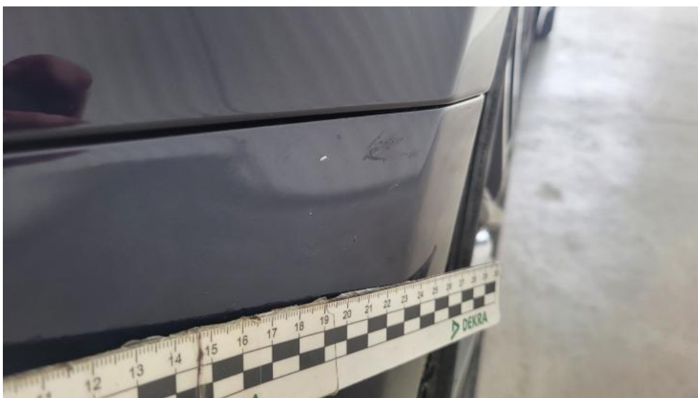
Fot. 48. Zderzak() - Rysa/odprysk 3
