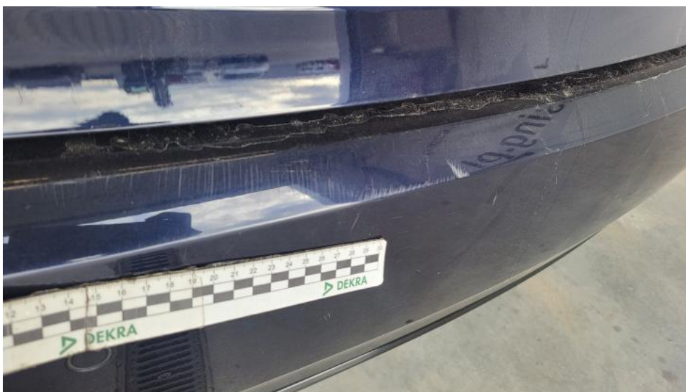
Fot. 54. Zderzak tylny - Rysa/odprysk 1
