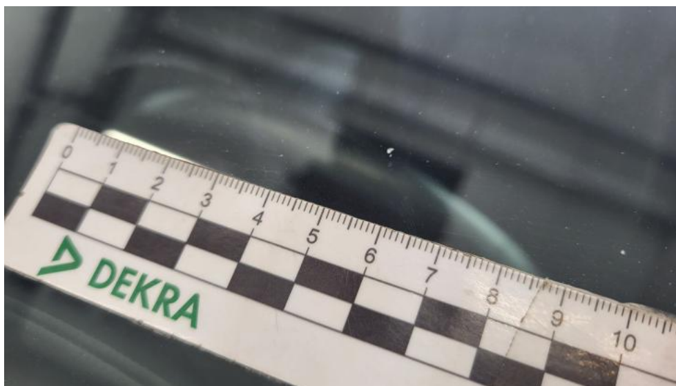
Fot. 43. Szyba czołowa - Rysa/odprysk 1
