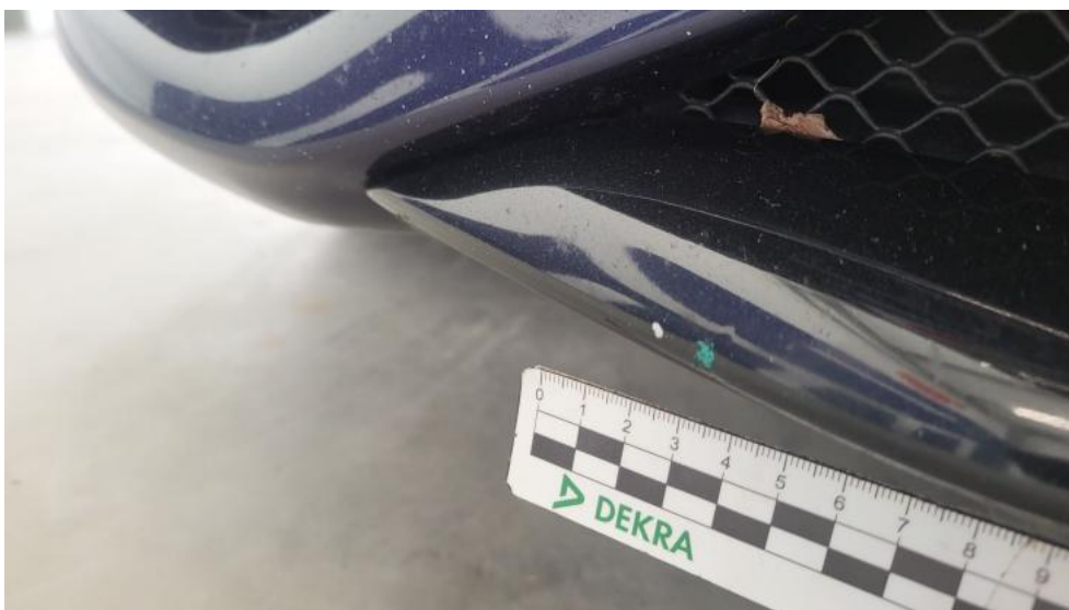
Fot. 46. Zderzak - Rysa/odprysk 1
