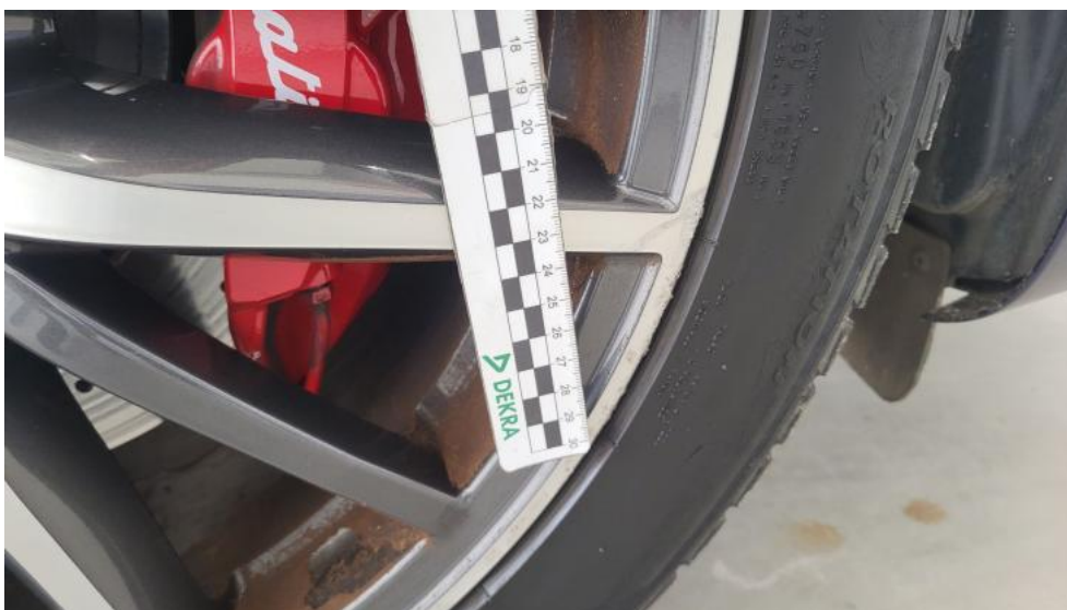
Fot. 53. Felga aluminiowa przednia P - Rysa/odprysk 2
