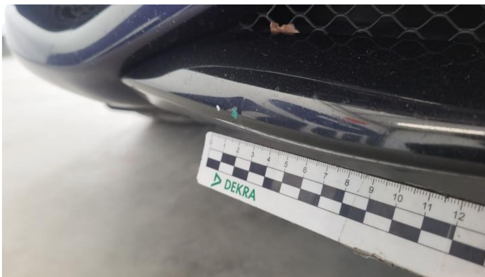
Fot. 49. Zderzak - Wgniecenie/odkształcenie 1
