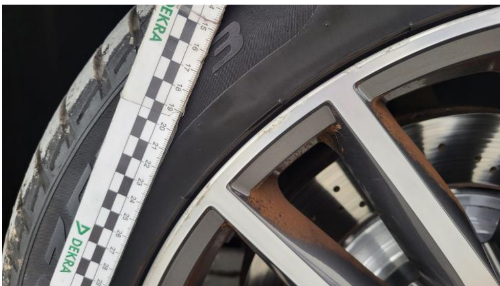
Fot. 52. Felga aluminiowa przednia P - Rysa/odprysk 1
