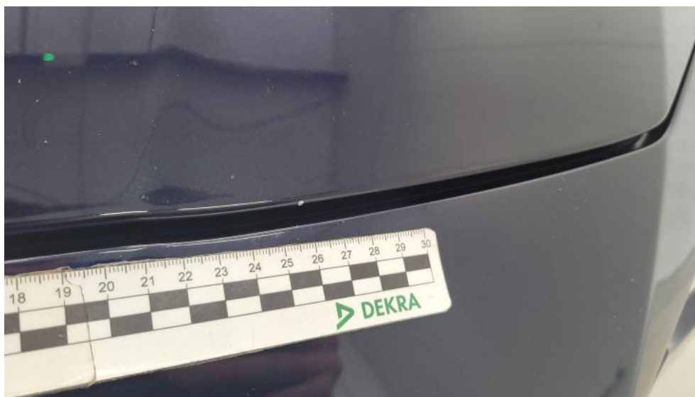
Fot. 41. Pokrywa komory silnika - Rysa/odprysk 1
