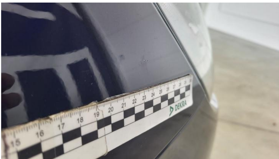
Fot. 50. Błotnik przedni P - Rysa/odprysk 1
