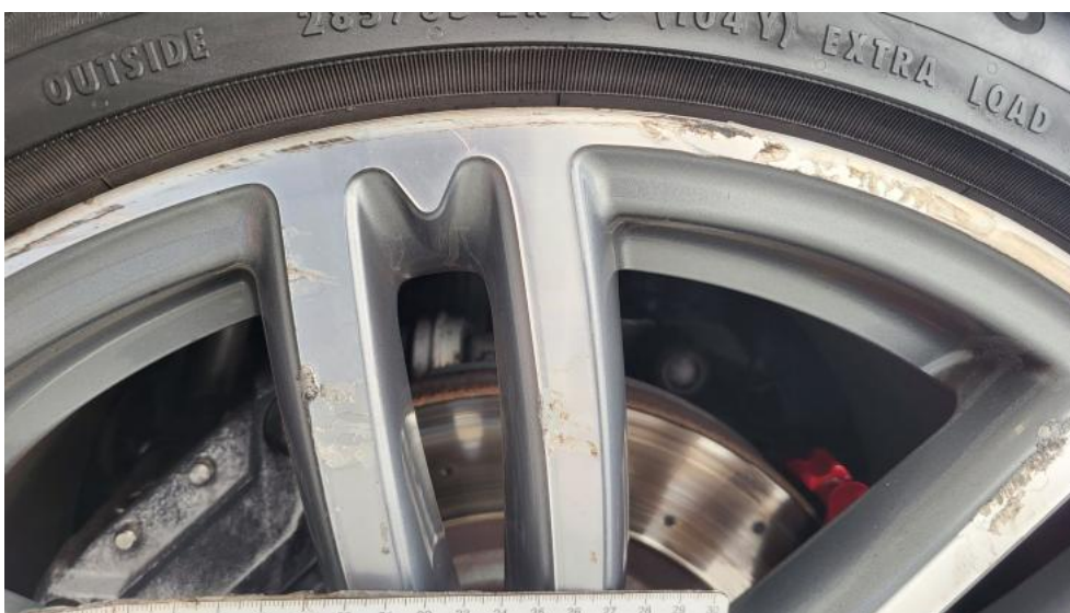
Fot. 62. Felga aluminiowa tylna L - Rysa/odprysk 2
