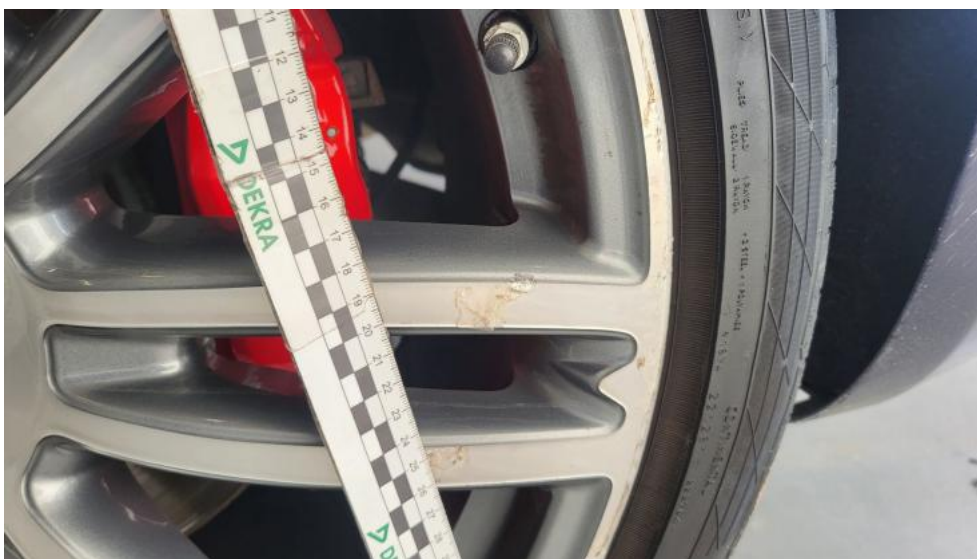
Fot. 61. Felga aluminiowa tylna L - Rysa/odprysk 1
