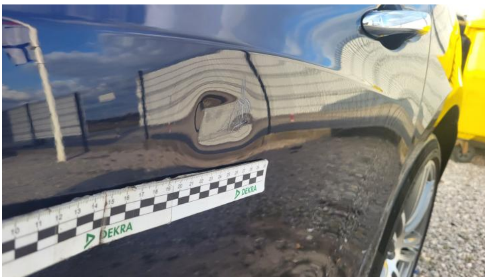
Fot. 69. Drzwi tylne L - Wgniecenie/odkształcenie 2
