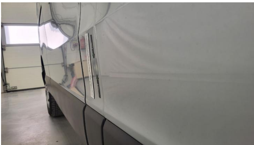
Fot. 44. Słupek środkowy P - Wgniecenie/odkształcenie 2
