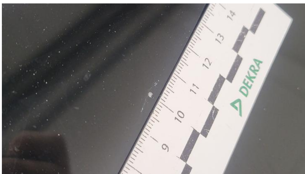
Fot. 36. Szyba czołowa - Pęknięcie/rozerwanie 1
