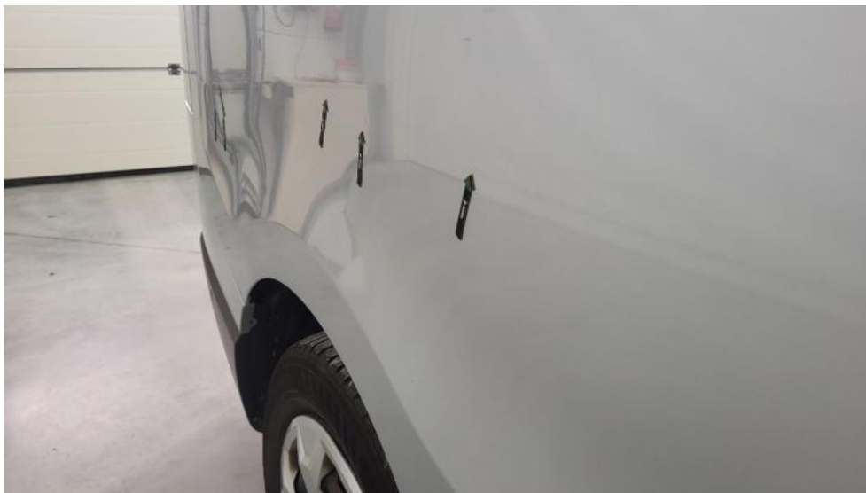
Fot. 47. Błotnik tylny P / Ściana boczna P - Wgniecenie/odkształcenie 1
