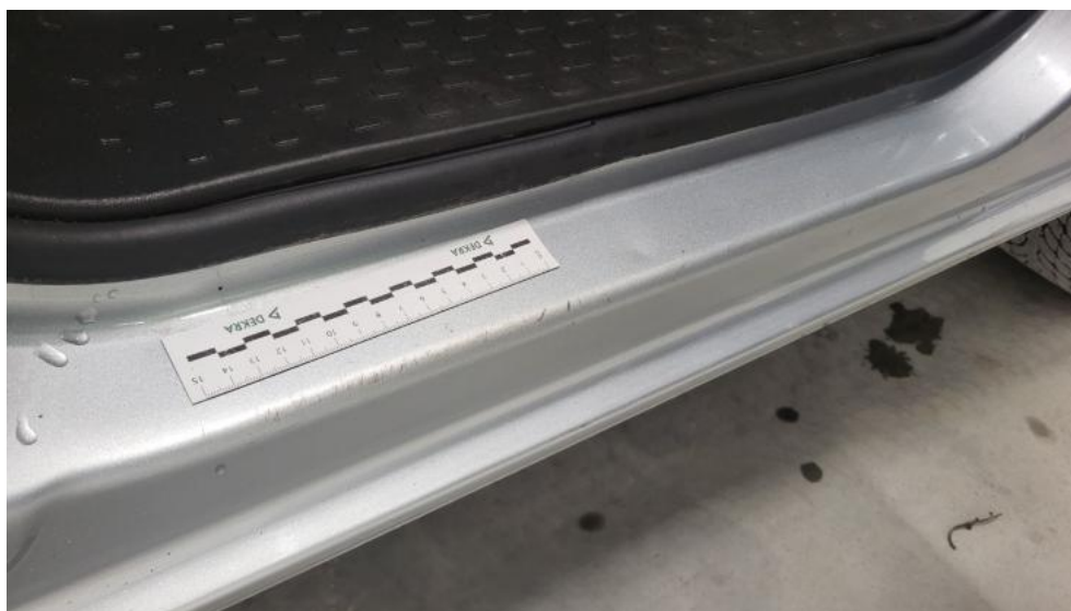
Fot. 41. Próg P - Rysa/odprysk 1
