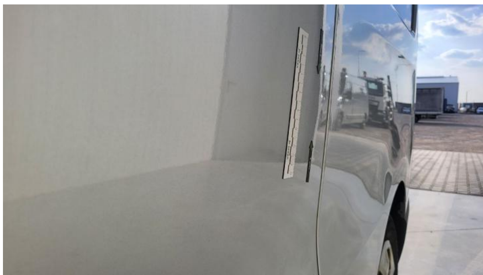
Fot. 52. Błotnik tylny L / Ściana boczna L - Wgniecenie/odkształcenie 2
