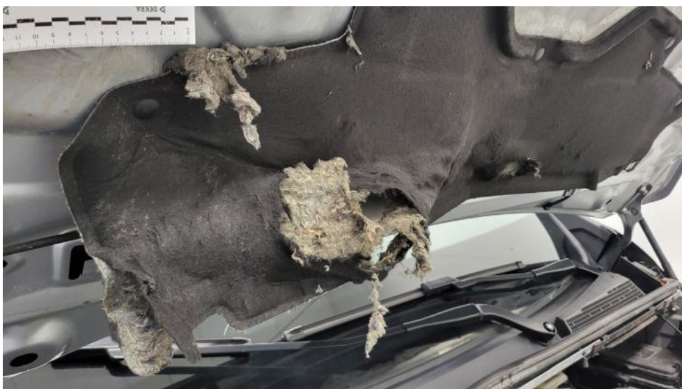
Fot. 37. Wykładzina pokrywy komory silnika - Pęknięcie/rozerwanie 1
