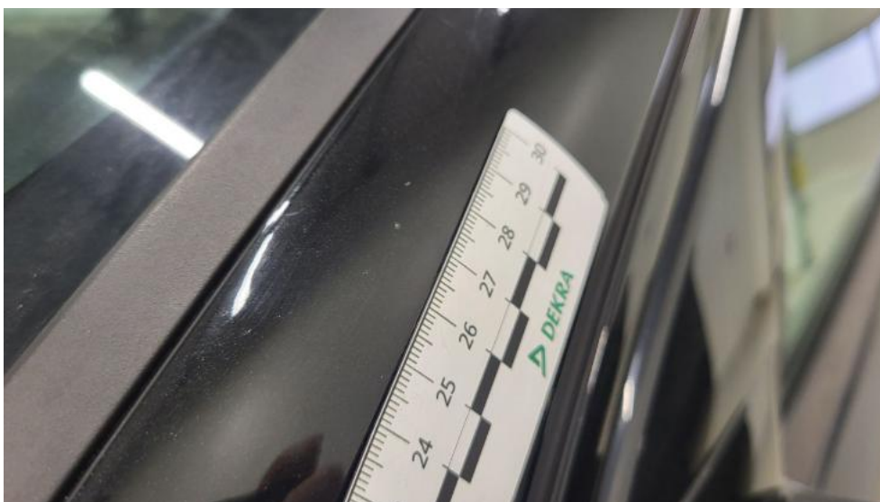
Fot. 58. Słupek przedni L - Rysa/odprysk 1
