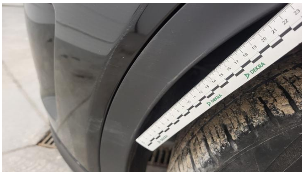
Fot. 62. Listwa błotnika przedniego L - Rysa/odprysk 1
