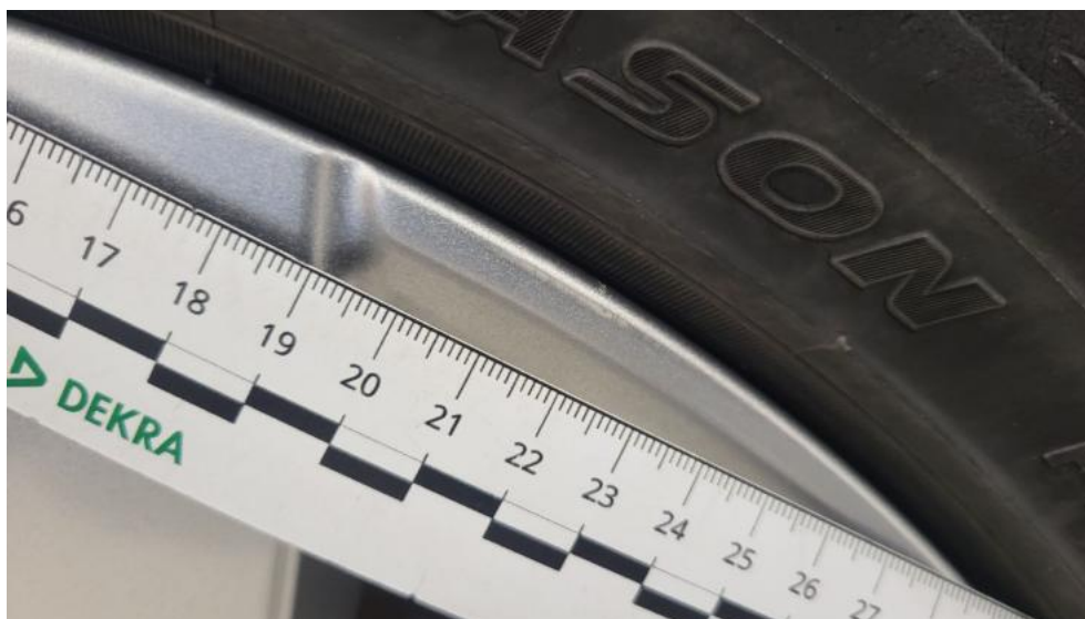
Fot. 61. Felga Aluminiowa przednia L - Rysa/odprysk 1
