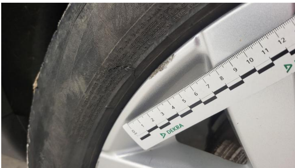
Fot. 40. Felga aluminiowa przednia P - Rysa/odprysk 1
