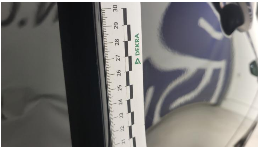
Fot. 43. Drzwi tylne P - Rysa/odprysk 1
