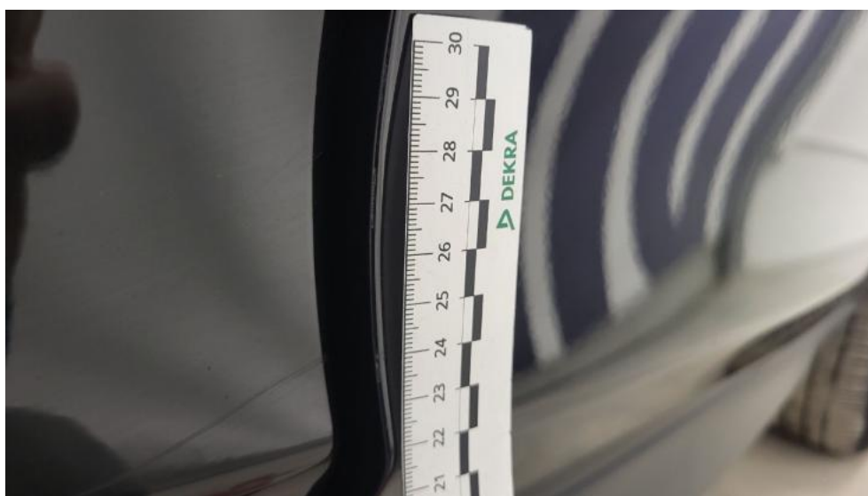
Fot. 42. Drzwi przednie P - Rysa/odprysk 1
