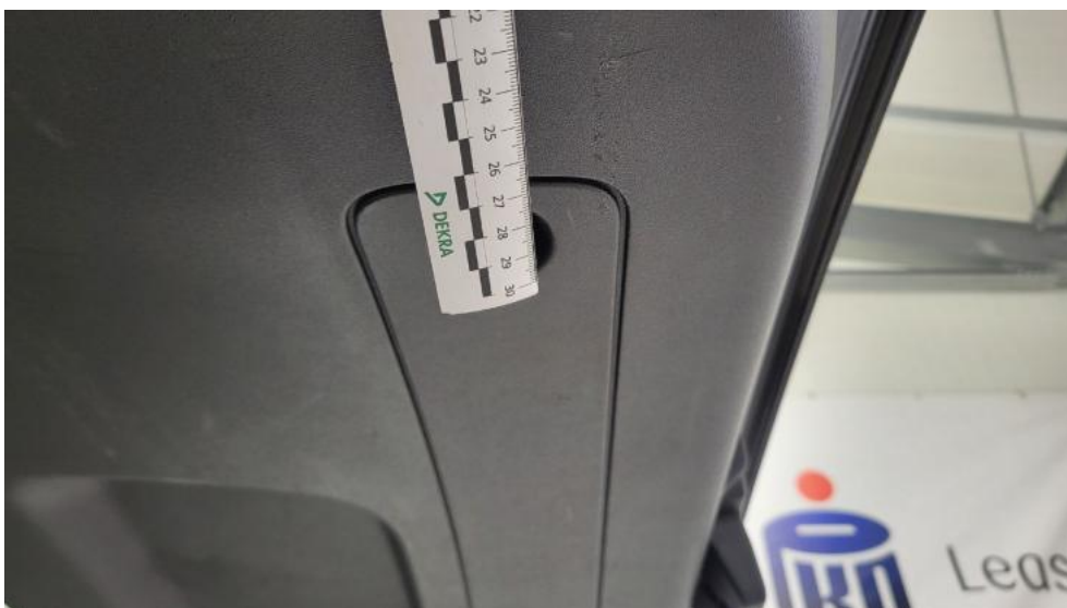
Fot. 68. Wykładzina pokrywy tylnej - Rysa/odprysk 1
