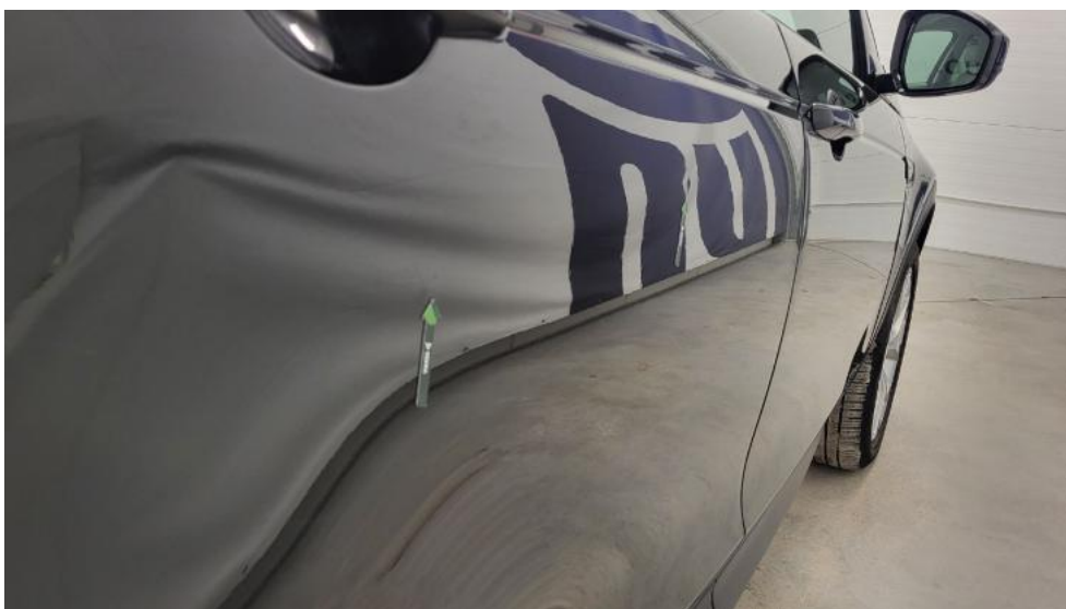
Fot. 44. Drzwi tylne P - Wgniecenie/odkształcenie 1
