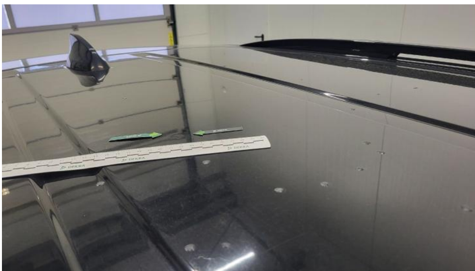
Fot. 49. Dach - Wgniecenie/odkształcenie 1
