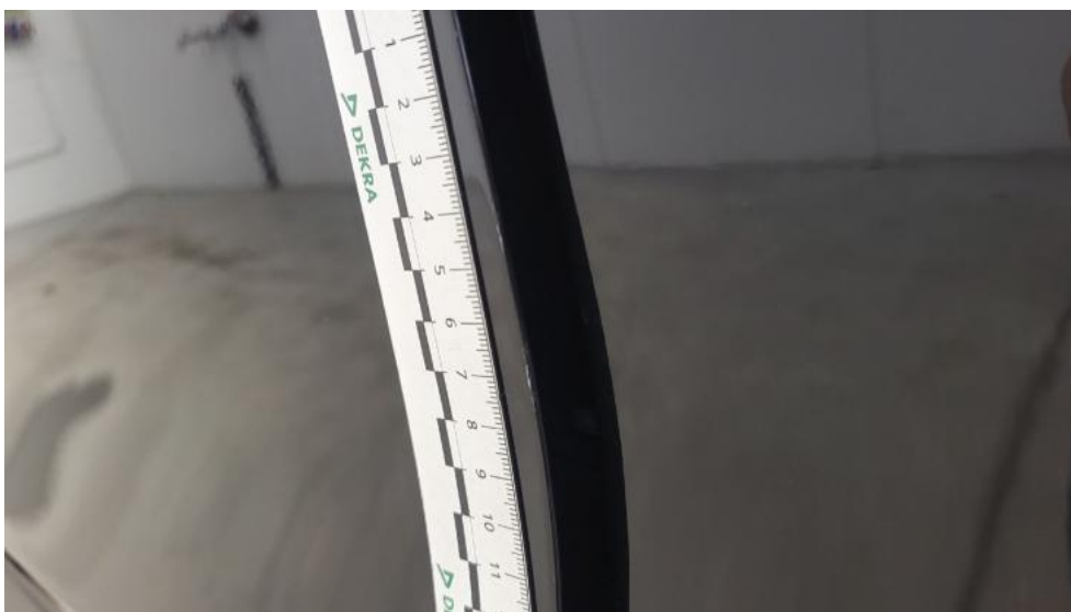
Fot. 54. Drzwi przed L - Rysa/odprysk 1
