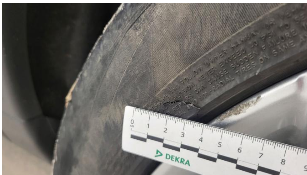
Fot. 41. Opona przednia P - Pęknięcie/rozerwanie 1
