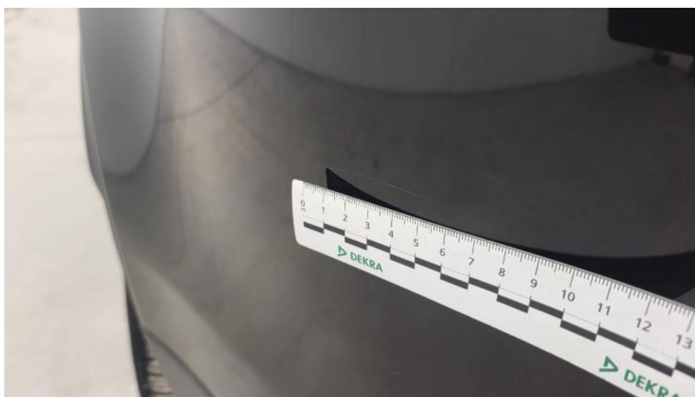
Fot. 46. Zderzak tylny - Rysa/odprysk 1
