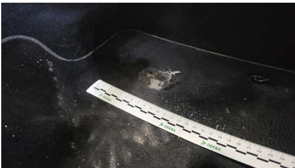
Fot. 66. Dywanik prze L - Pęknięcie/rozerwanie 1
