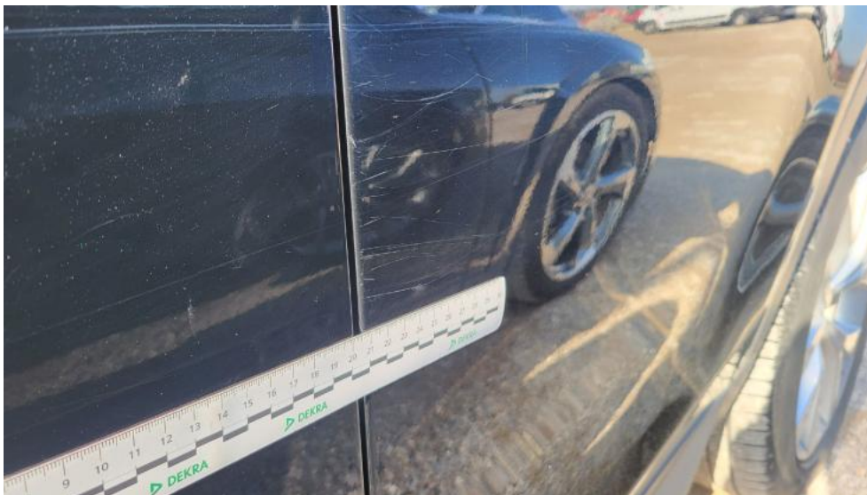
Fot. 57. Drzwi tylne L - Rysa/odprysk 1
