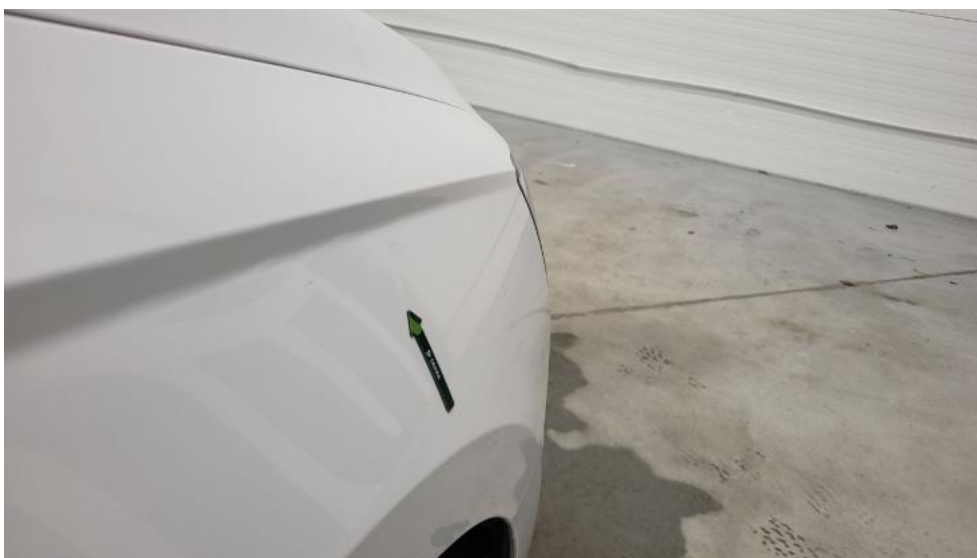
Fot. 44. Błotnik przedni P - Wgniecenie/odkształcenie 1
