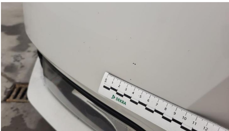
Fot. 43. Zderzak - Rysa/odprysk 1
