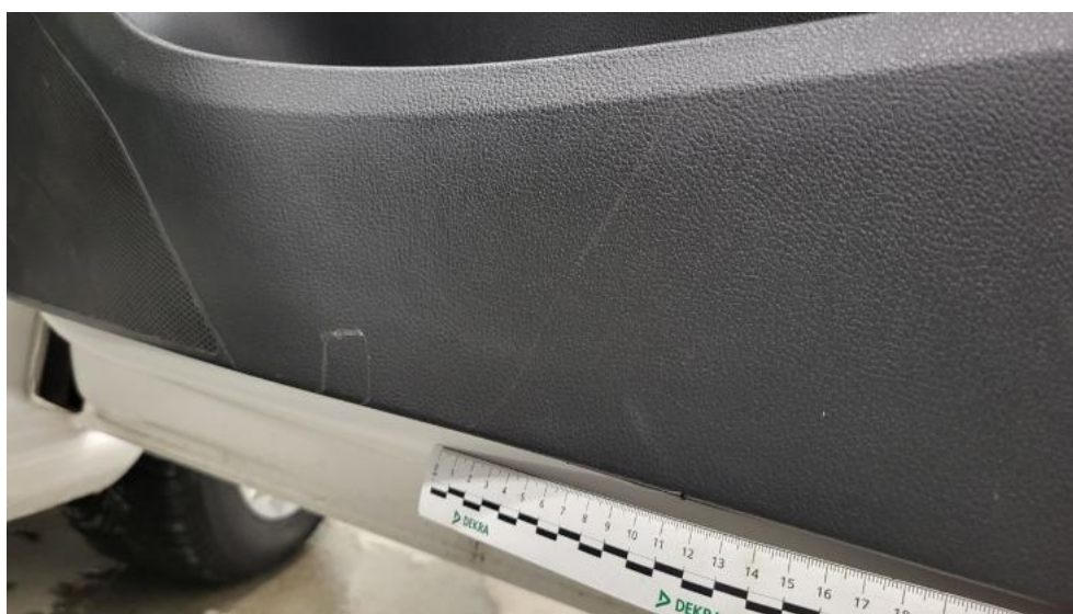
Fot. 78. Tapicerka drzwi przednich P - Rysa/odprysk 1
