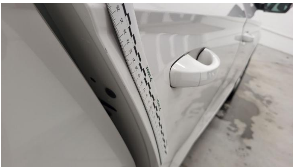
Fot. 48. Drzwi tylne P - Rysa/odprysk 2
