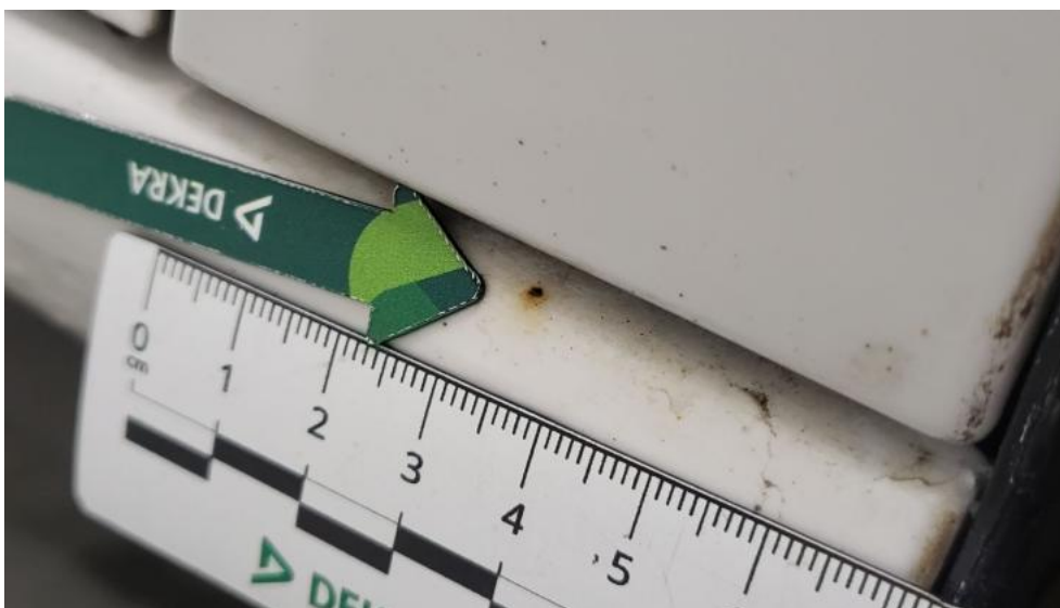
Fot. 51. Próg P - Wgniecenie/odkształcenie 1
