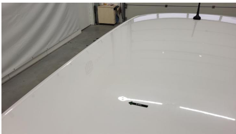
Fot. 62. Dach - Wgniecenie/odkształcenie 1
