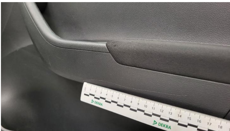
Fot. 80. Uchwyt drzwi prze P - Rysa/odprysk 1
