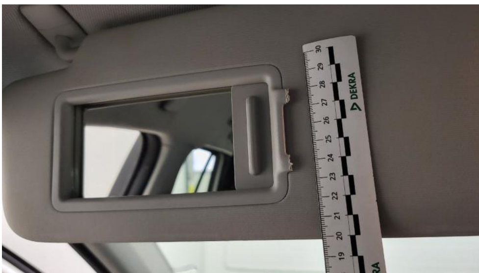
Fot. 82. Osłona p/słoneczna lewa - Pęknięcie/rozerwanie 1
