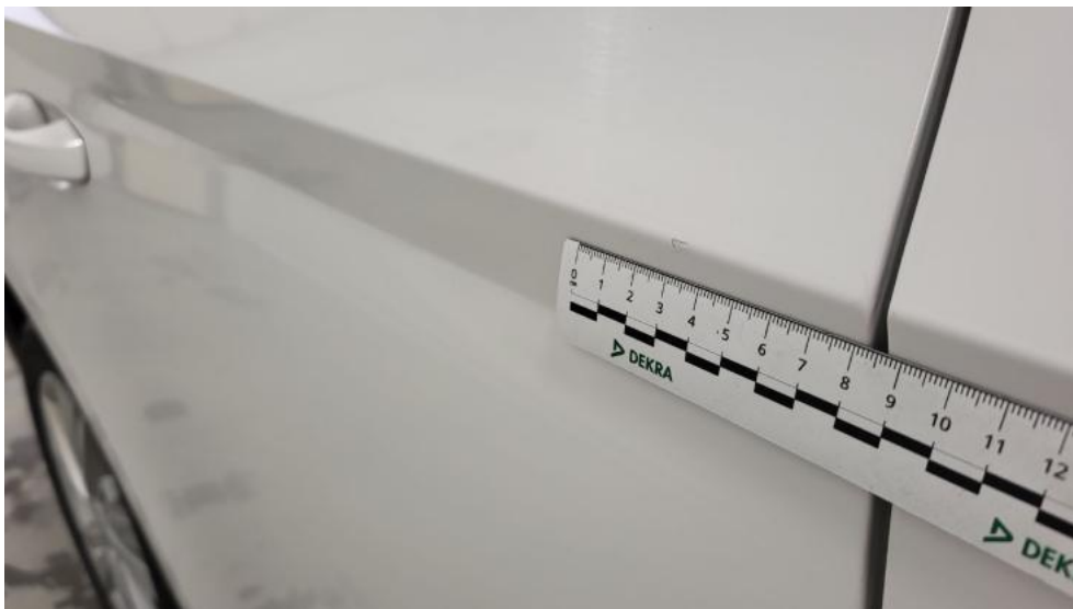
Fot. 47. Drzwi tylne P - Rysa/odprysk 1
