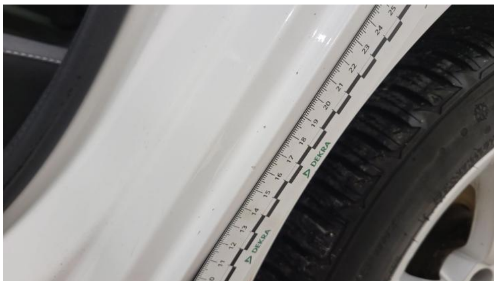
Fot. 64. Błotnik tylny L / Ściana boczna L - Rysa/odprysk 1
