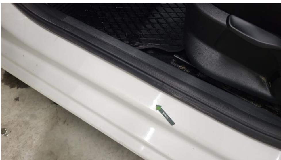
Fot. 71. Próg L - Wgniecenie/odkształcenie 1
