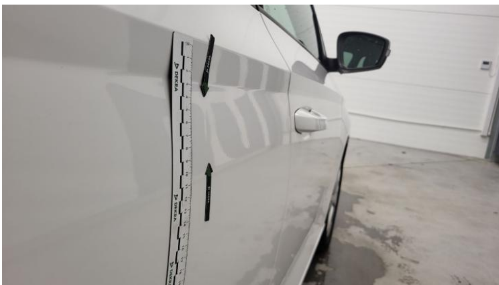
Fot. 49. Drzwi tylne P - Wgniecenie/odkształcenie 1
