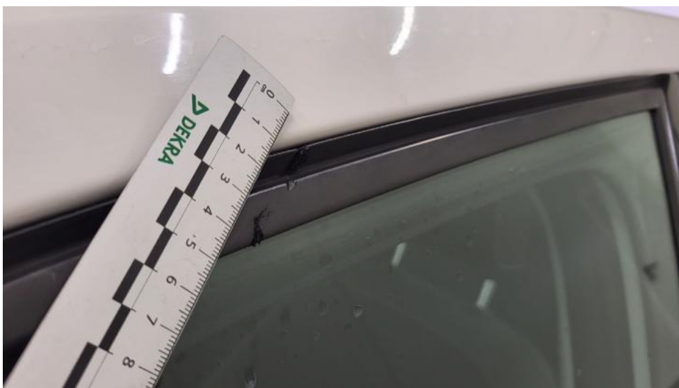
Fot. 73. Uszczelka szyby bocznej prz L - Rysa/odprysk 1
