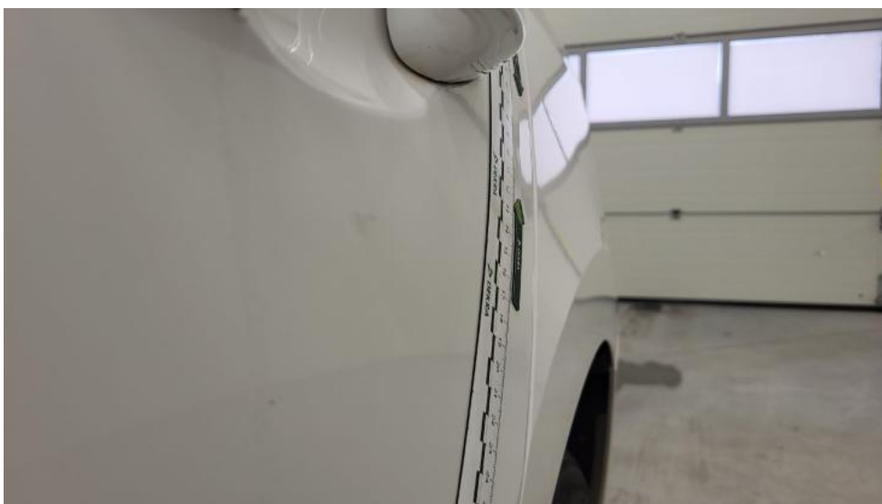
Fot. 69. Drzwi tylne L - Wgniecenie/odkształcenie 1
