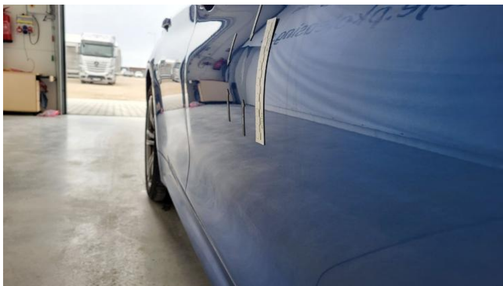
Fot. 52. Drzwi przednie P - Wgniecenie/odkształcenie 1
