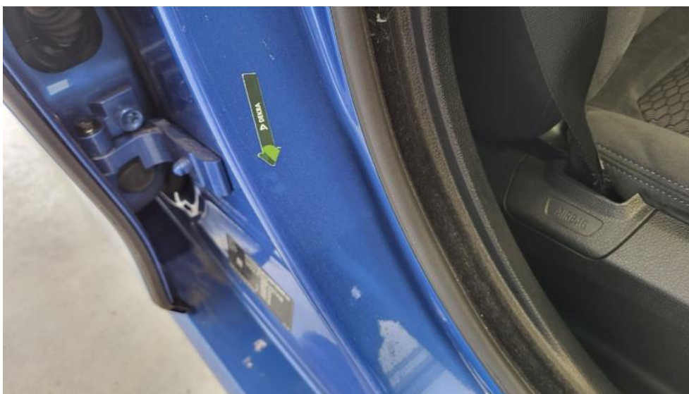
Fot. 53. Słupek środkowy P - Wgniecenie/odkształcenie 1
