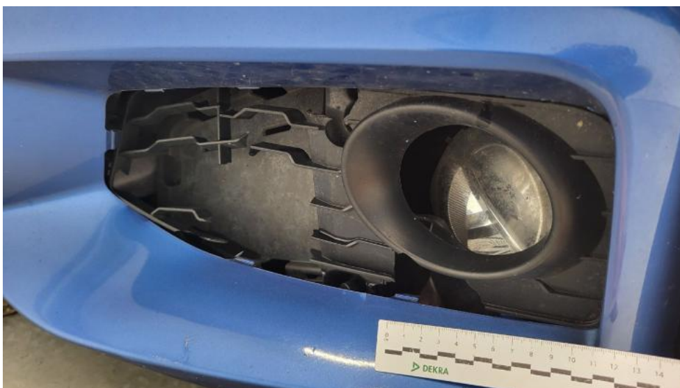
Fot. 44. Kratka zderzaka prz. - Pęknięcie/rozerwanie 1
