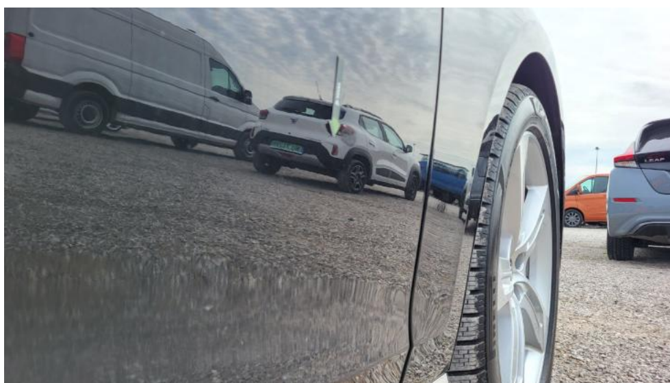
Fot. 56. Drzwi przednie P - Wgniecenie/odkształcenie 1
