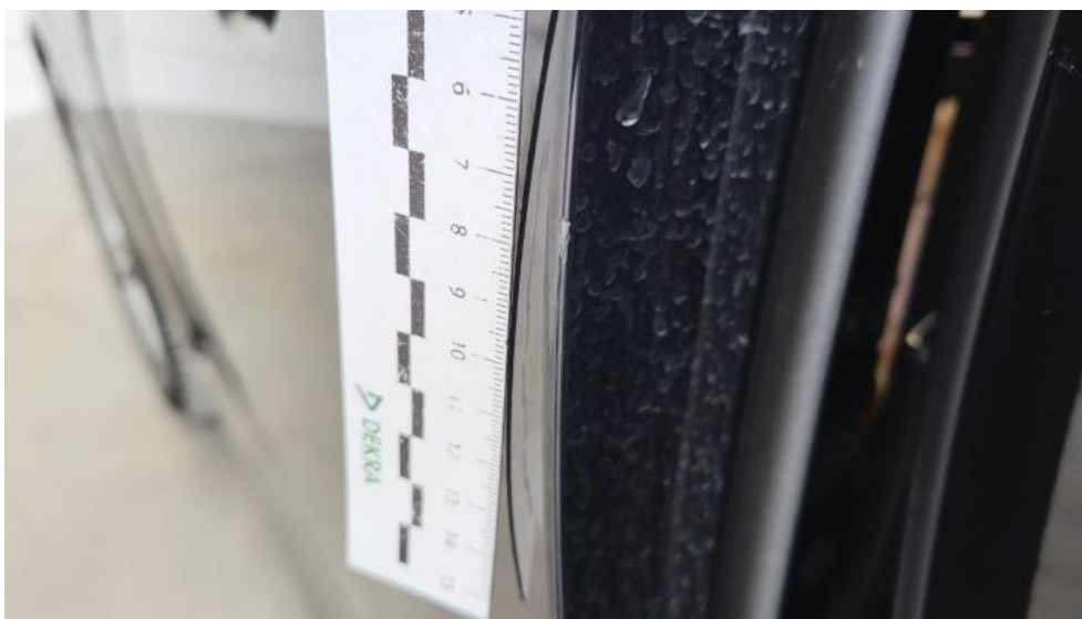
Fot. 65. Drzwi przed L - Rysa/odprysk 1
