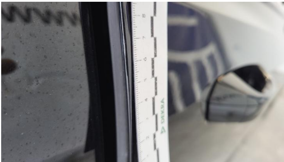
Fot. 57. Drzwi tylne P - Rysa/odprysk 1
