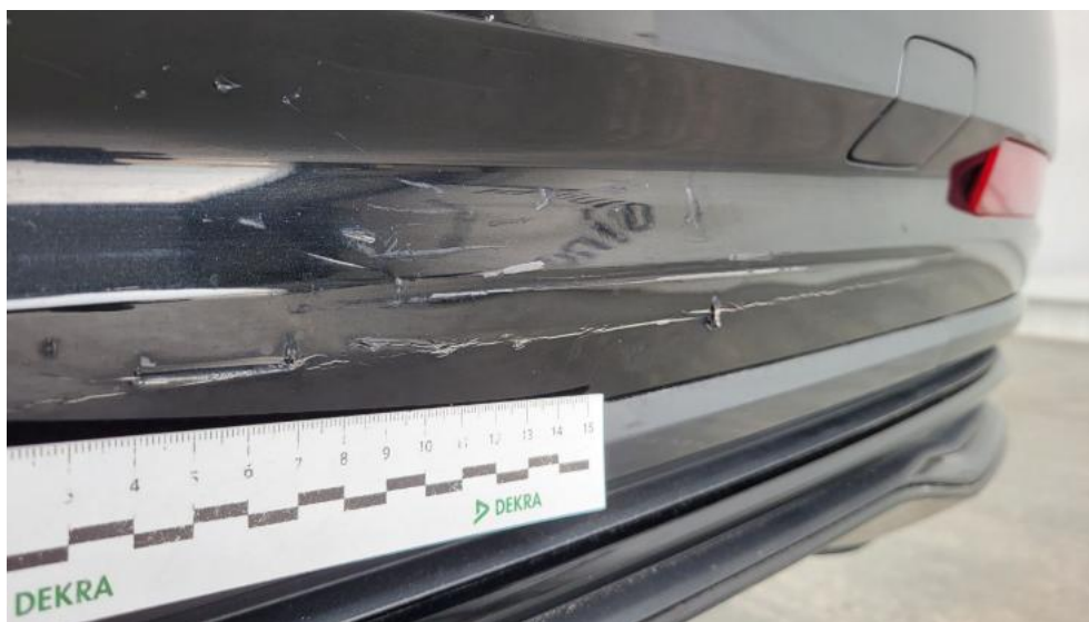
Fot. 63. Zderzak tylny - Pęknięcie/rozerwanie 2
