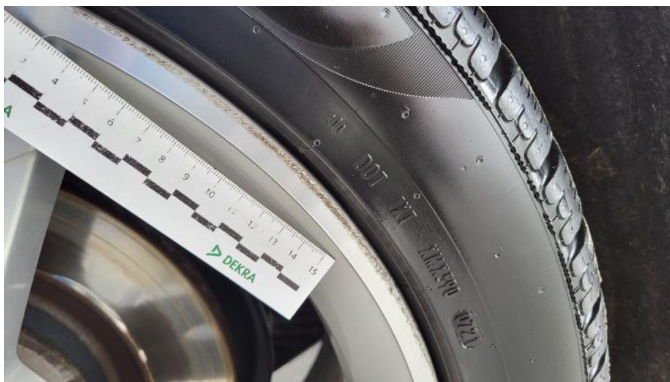
Fot. 64. Felga aluminiowa tylna L - Rysa/odprysk 1
