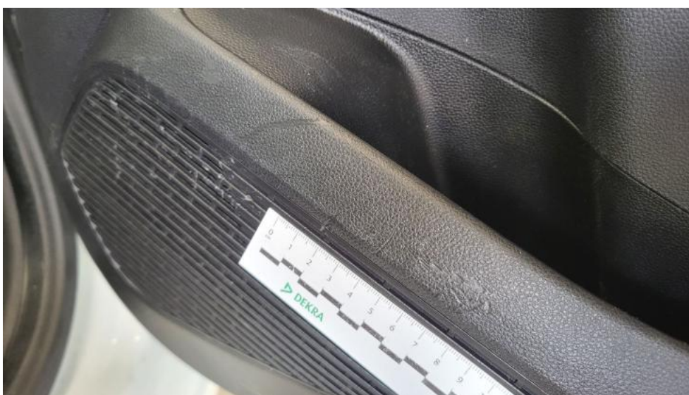
Photo 80. Tapicerka drzwi przednich P - Rysa/odprysk 1
