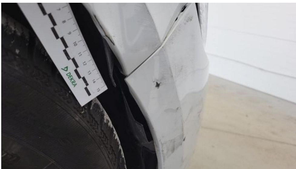
Photo 52. Nadkole przednie P - Wgniecenie/odkształcenie 1
