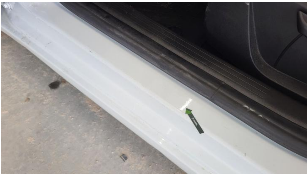
Photo 73. Próg L - Wgniecenie/odkształcenie 1
