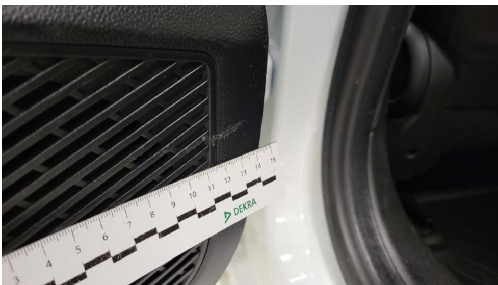
Photo 81. Tapicerka drzwi tylnych L - Rysa/odprysk 1
