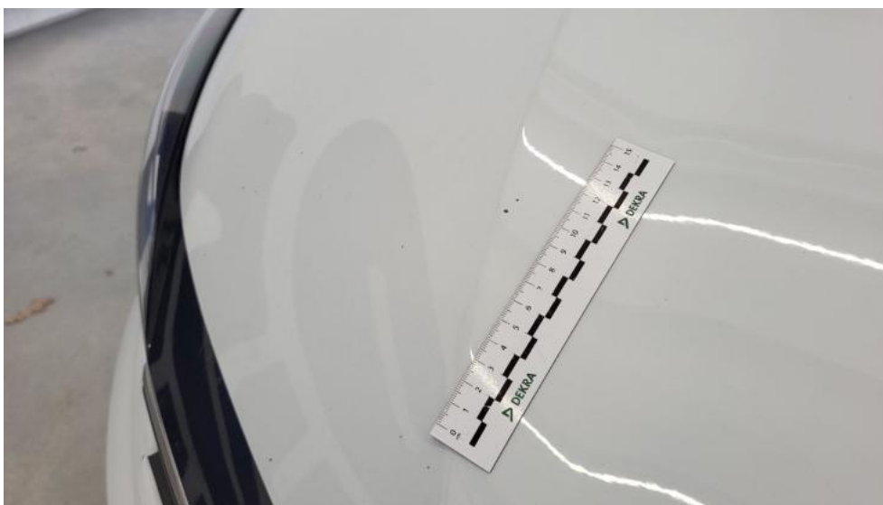
Photo 37. Pokrywa komory silnika - Rysa/odprysk 1
