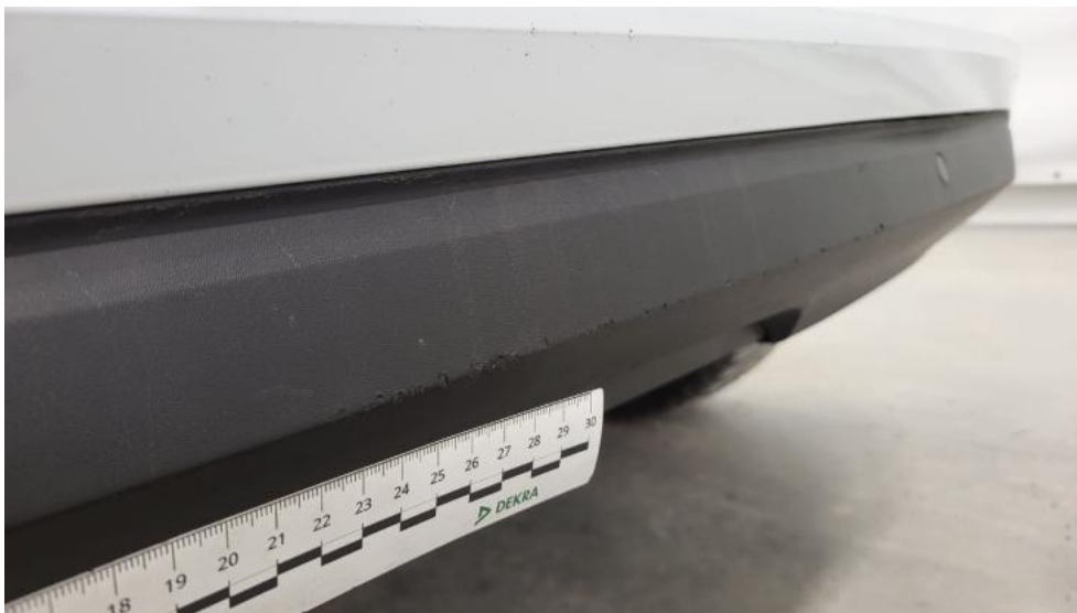
Photo 57. Spojler zderzaka tylnego - Rysa/odprysk 1
