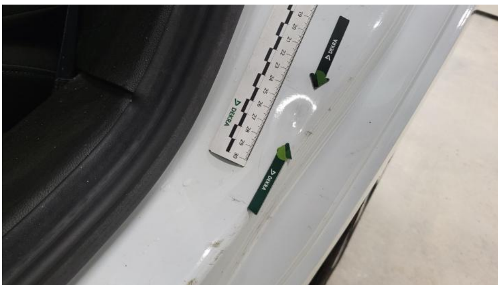
Photo 59. Błotnik tylny L / Ściana boczna L - Wgniecenie/odkształcenie 1
