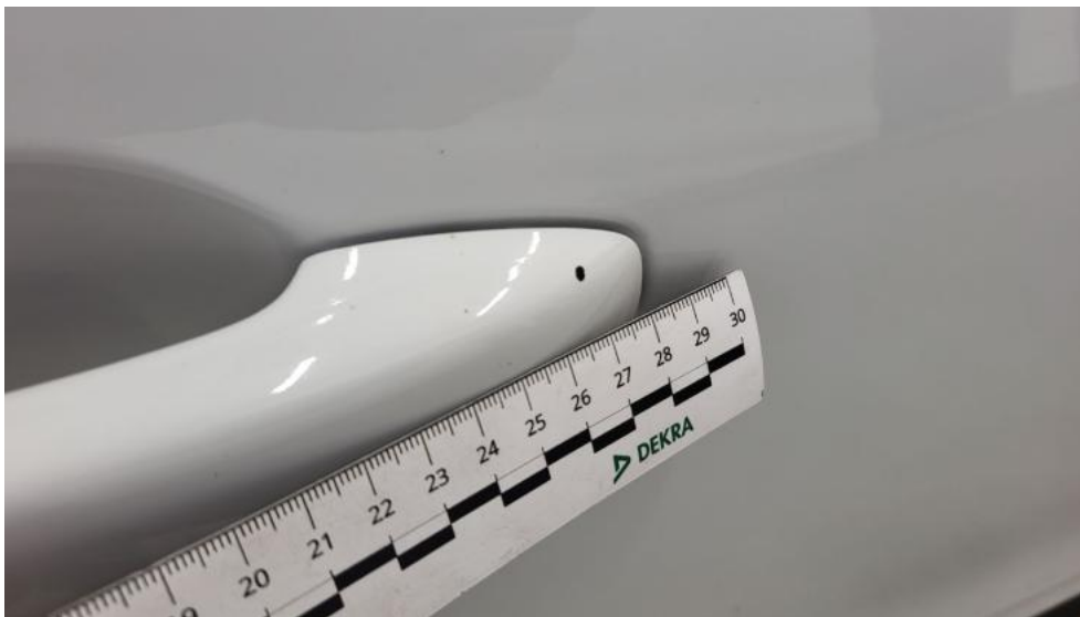
Photo 51. Klamka drzwi prz P - Rysa/odprysk 1
