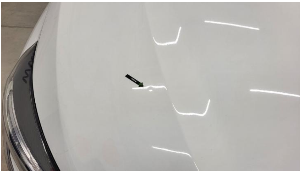
Photo 41. Pokrywa komory silnika - Wgniecenie/odkształcenie 1
