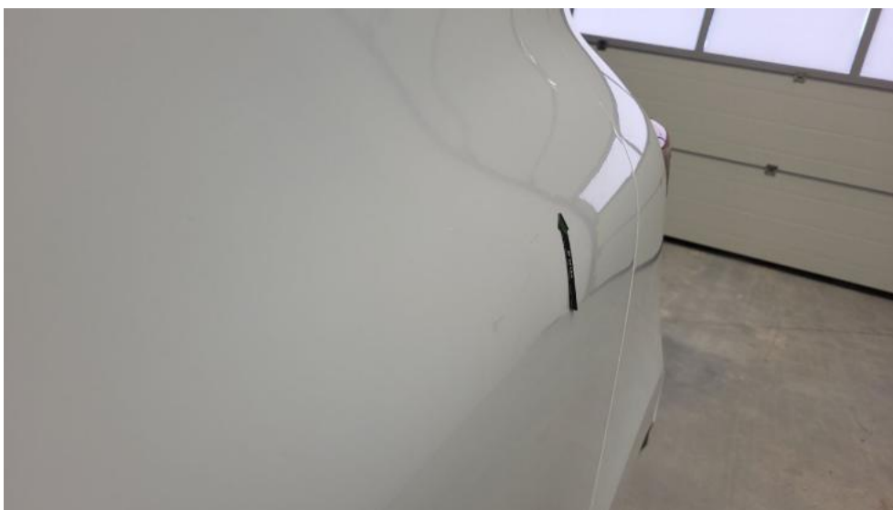
Photo 64. Drzwi tylne L - Wgniecenie/odkształcenie 1
