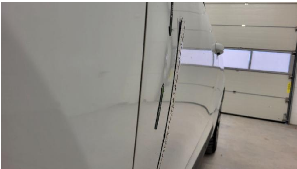
Photo 61. Drzwi przed L - Wgniecenie/odkształcenie 1
