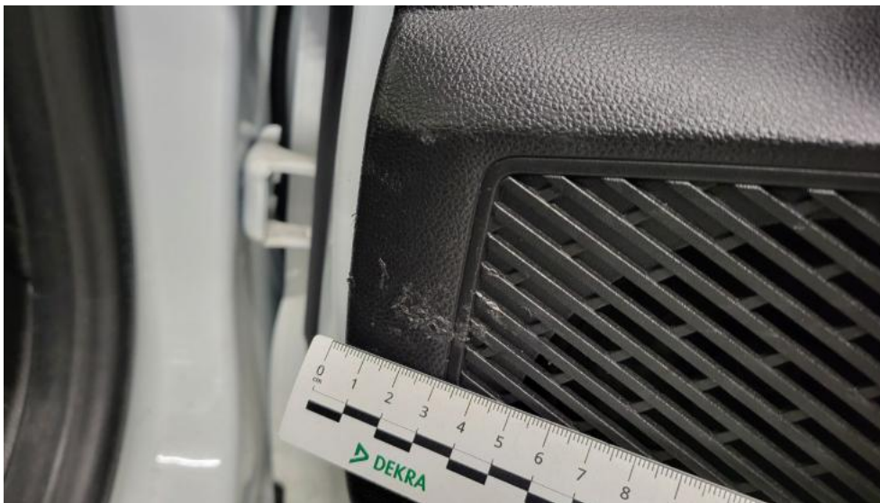
Photo 69. Tapicerka drzwi tylnych P - Rysa/odprysk 1
