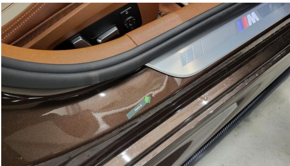
Fot. 55. Próg P - Wgniecenie/odkształcenie 1
