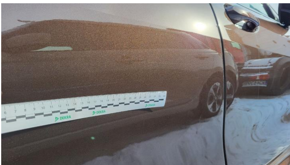
Fot. 54. Drzwi tylne P - Rysa/odprysk 2
