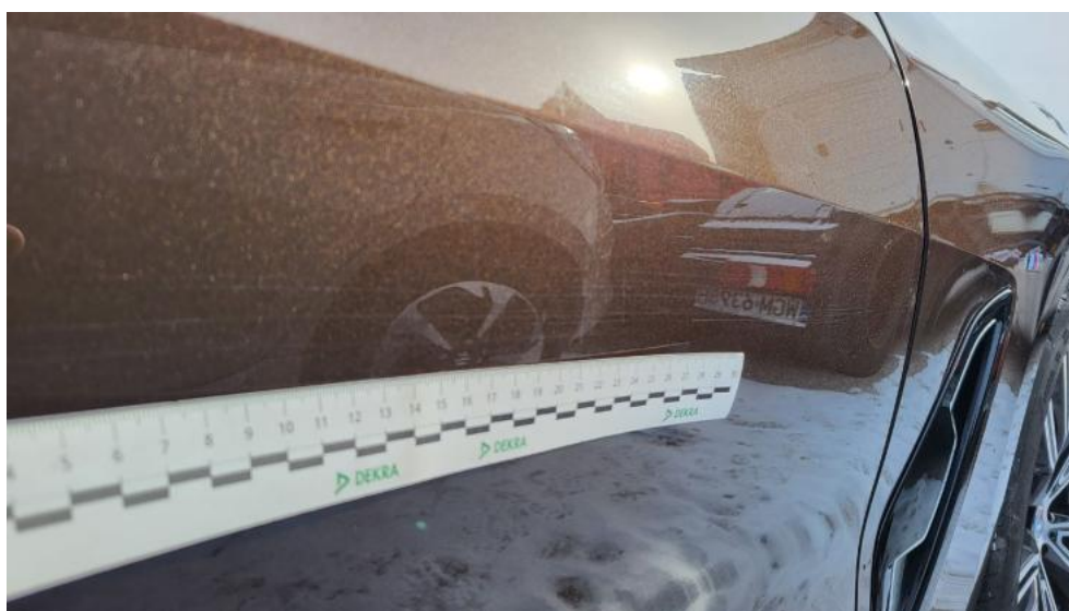
Fot. 52. Drzwi przednie P() - Rysa/odprysk 3
