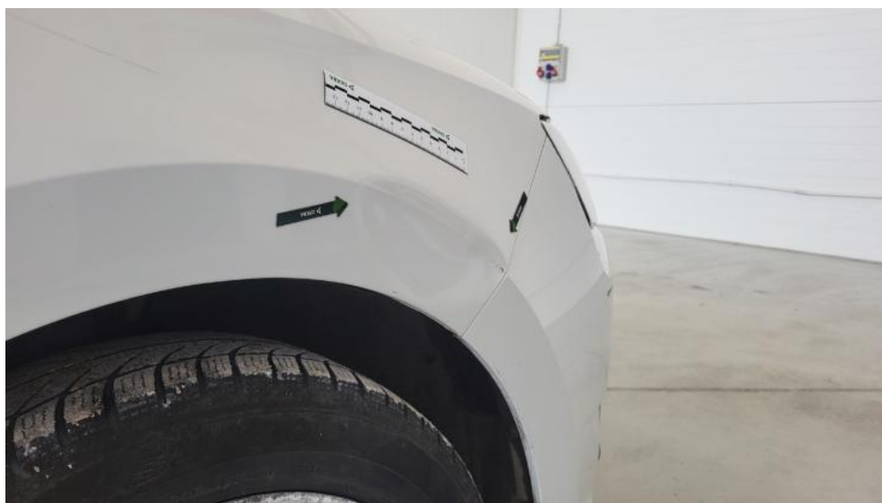
Fot. 52. Błotnik przedni P - Wgniecenie/odkształcenie 1
