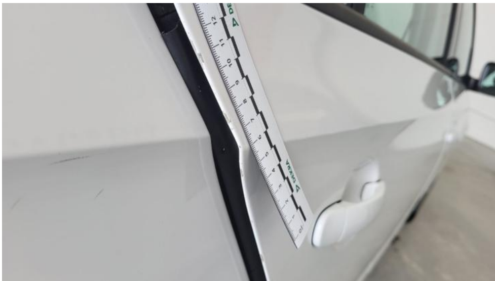
Fot. 55. Drzwi tylne P - Rysa/odprysk 1
