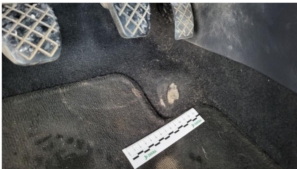
Fot. 110. Wykładzina podłogi - Pęknięcie/rozerwanie 1
