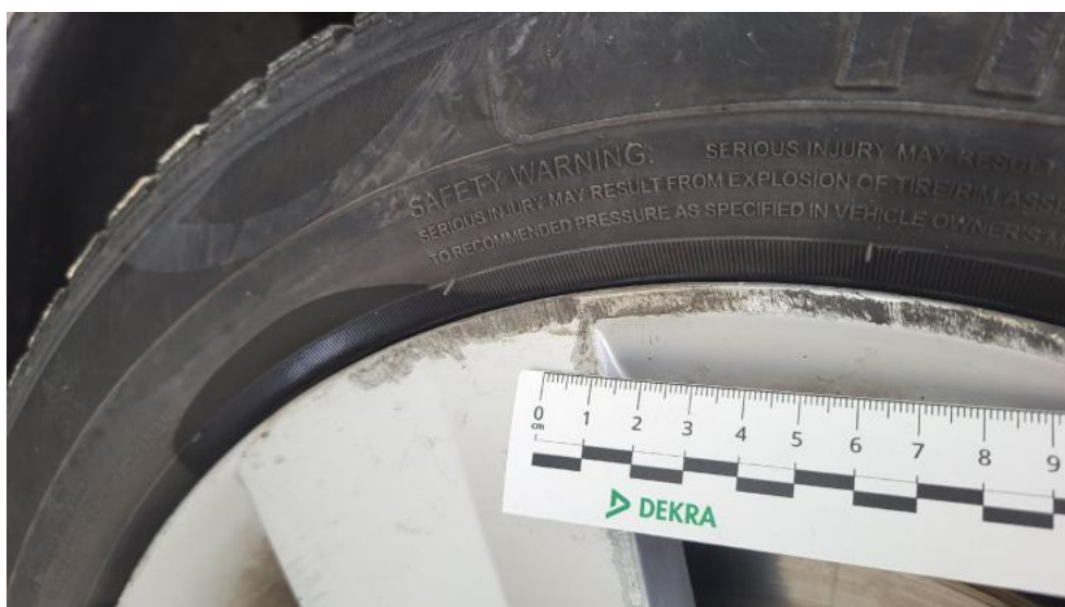
Fot. 92. Felga Aluminiowa przednia L - Rysa/odprysk 1
