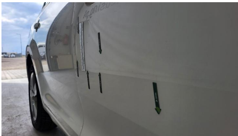
Fot. 54. Drzwi przednie P - Wgniecenie/odkształcenie 1
