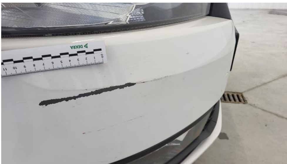
Fot. 49. Zderzak - Rysa/odprysk 2
