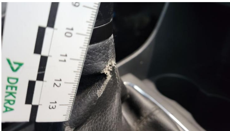
Fot. 97. Gałka dźwigni zmiany biegów - Pęknięcie/rozerwanie 1
