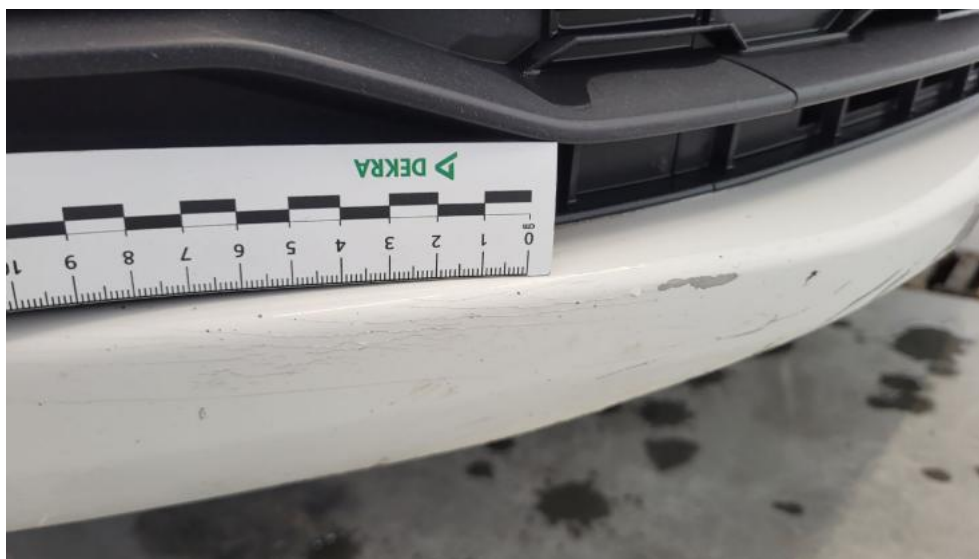
Fot. 51. Zderzak - Pęknięcie/rozerwanie 1
