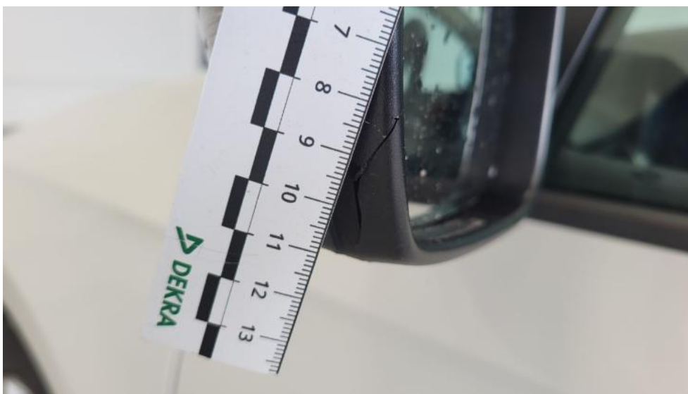
Fot. 87. Lusterko zew L - Pęknięcie/rozerwanie 1
