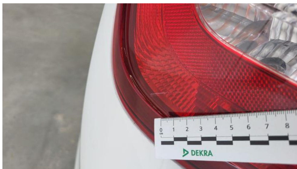
Fot. 82. Lampa tylna zew L - Rysa/odprysk 1
