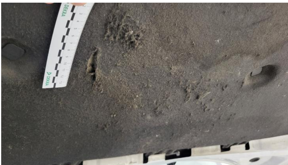
Fot. 47. Wykładzina pokrywy komory silnika - Pęknięcie/rozerwanie 1
