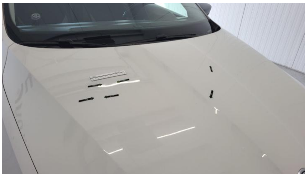
Fot. 45. Pokrywa komory silnika - Wgniecenie/odkształcenie 1
