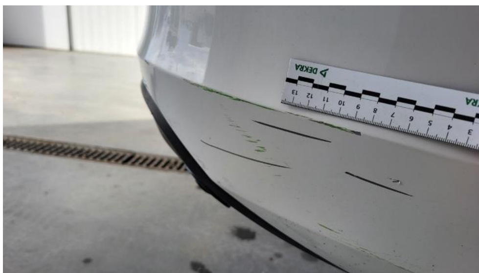
Fot. 70. Zderzak tylny - Rysa/odprysk 1
