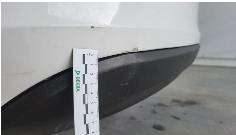
Fot. 77. Zderzak tylny cz dolna - Wgniecenie/odkształcenie 1
