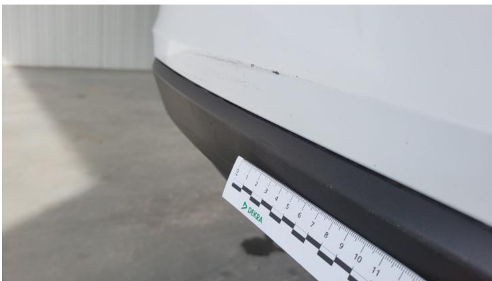
Fot. 78. Zderzak tylny cz dolna - Wgniecenie/odkształcenie 2
