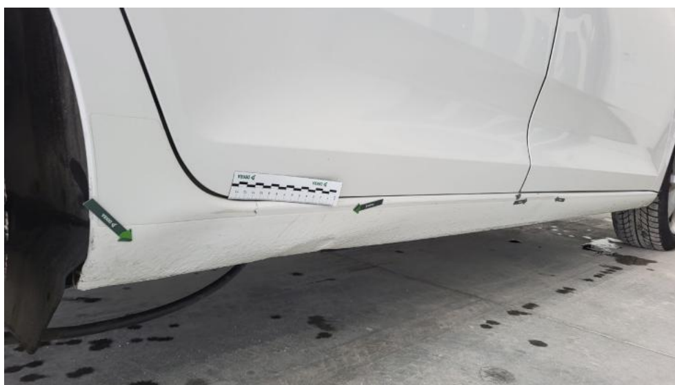
Fot. 60. Próg P - Wgniecenie/odkształcenie 2
