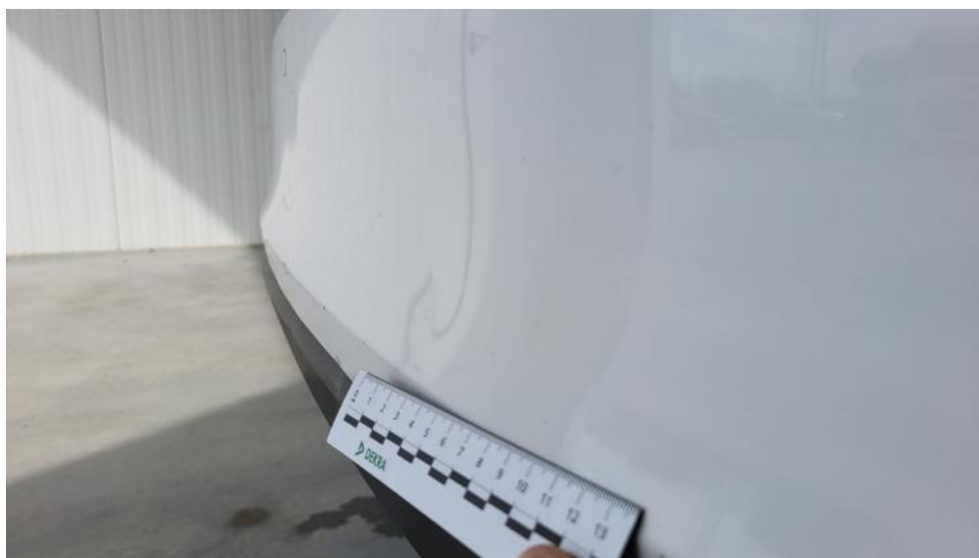
Fot. 74. Zderzak tylny() - Wgniecenie/odkształcenie 3
