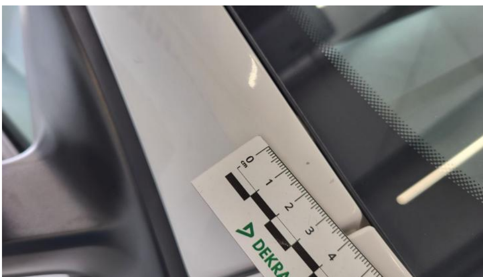
Fot. 62. Słupek przedni P - Rysa/odprysk 1
