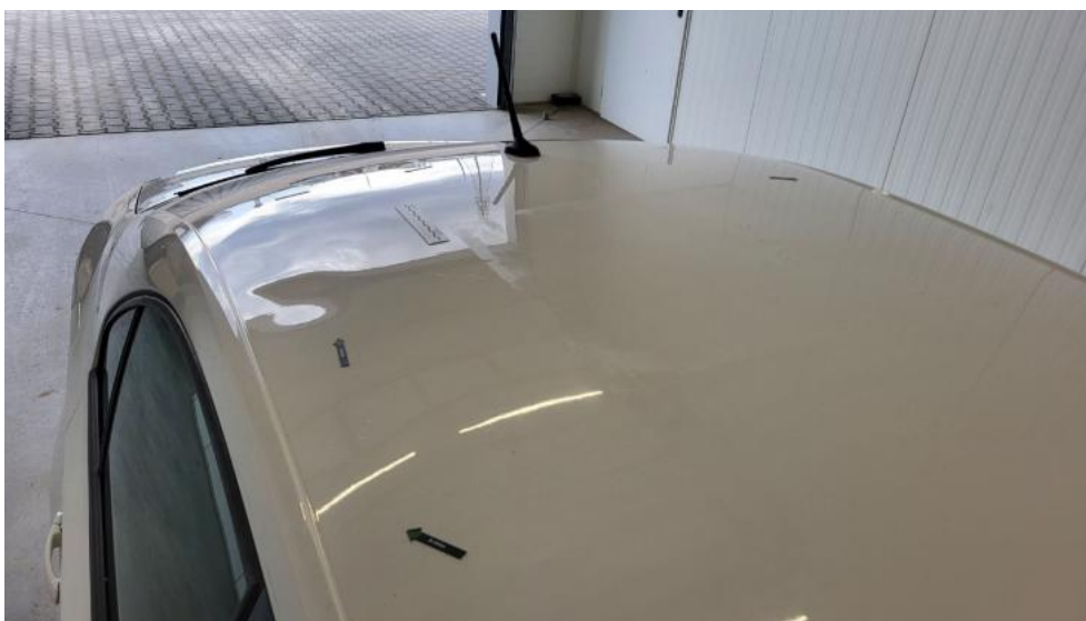
Fot. 79. Dach - Wgniecenie/odkształcenie 1
