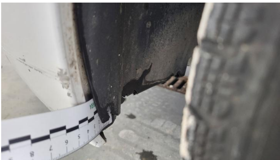
Fot. 93. Nadkole przednie L - Pęknięcie/rozerwanie 1
