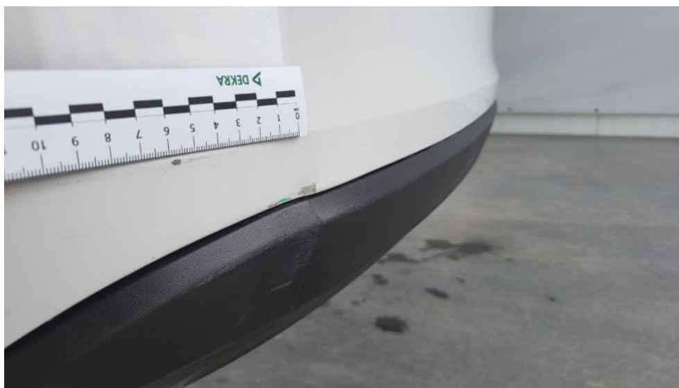
Fot. 73. Zderzak tylny - Wgniecenie/odkształcenie 2
