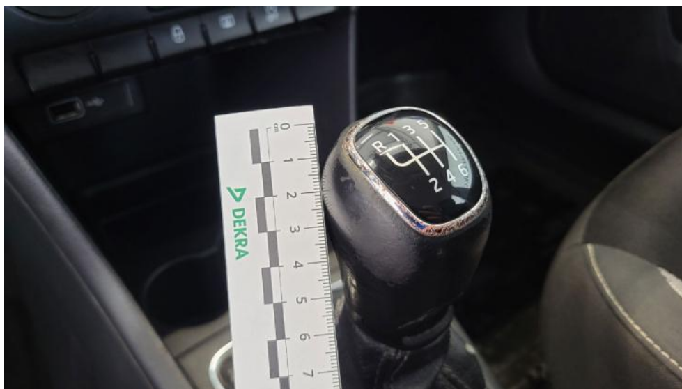
Fot. 96. Gałka dźwigni zmiany biegów - Rysa/odprysk 1
