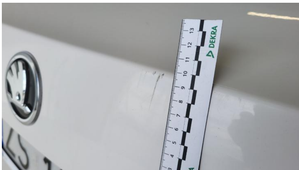
Fot. 68. Pokrywy bagażnika - Rysa/odprysk 1
