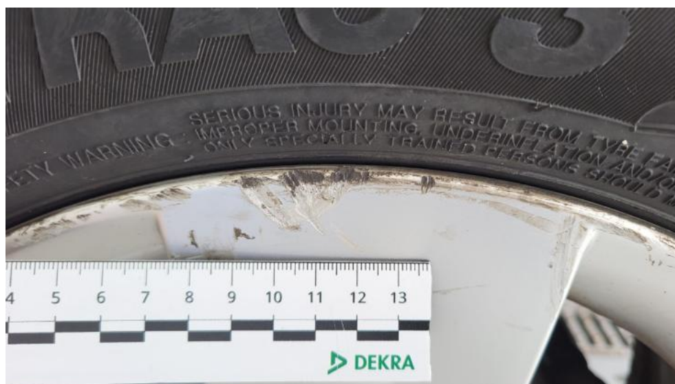
Fot. 81. Felga aluminiowa tylna L - Rysa/odprysk 1
