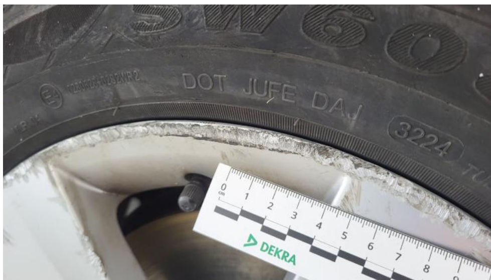
Fot. 53. Felga aluminiowa przednia P - Rysa/odprysk 1
