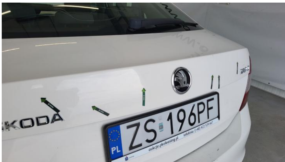
Fot. 69. Pokrywy bagażnika - Wgniecenie/odkształcenie 1
