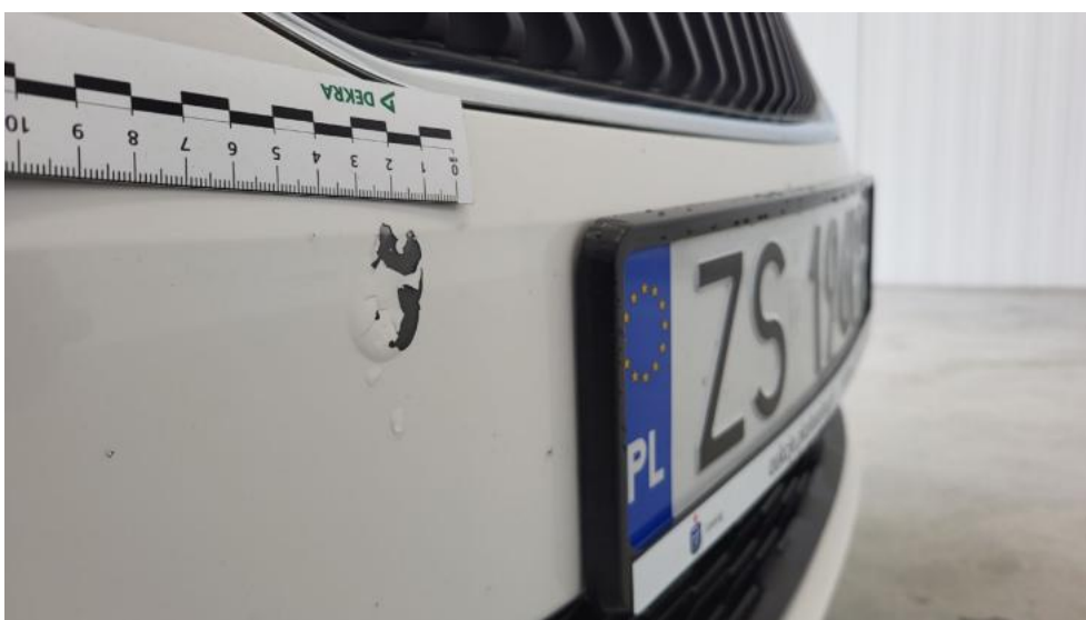
Fot. 50. Zderzak() - Rysa/odprysk 3
