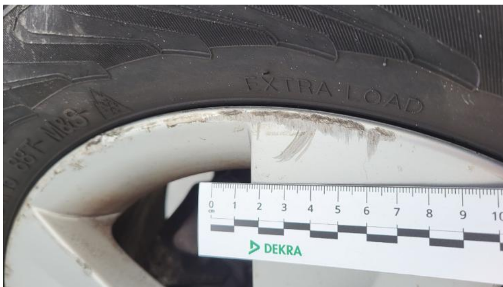
Fot. 67. Felga aluminiowa tylna P - Rysa/odprysk 1
