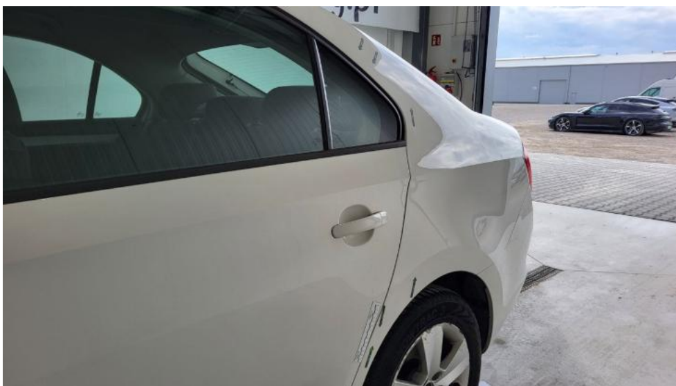
Fot. 80. Błotnik tylny L / Ściana boczna L - Wgniecenie/odkształcenie 1
