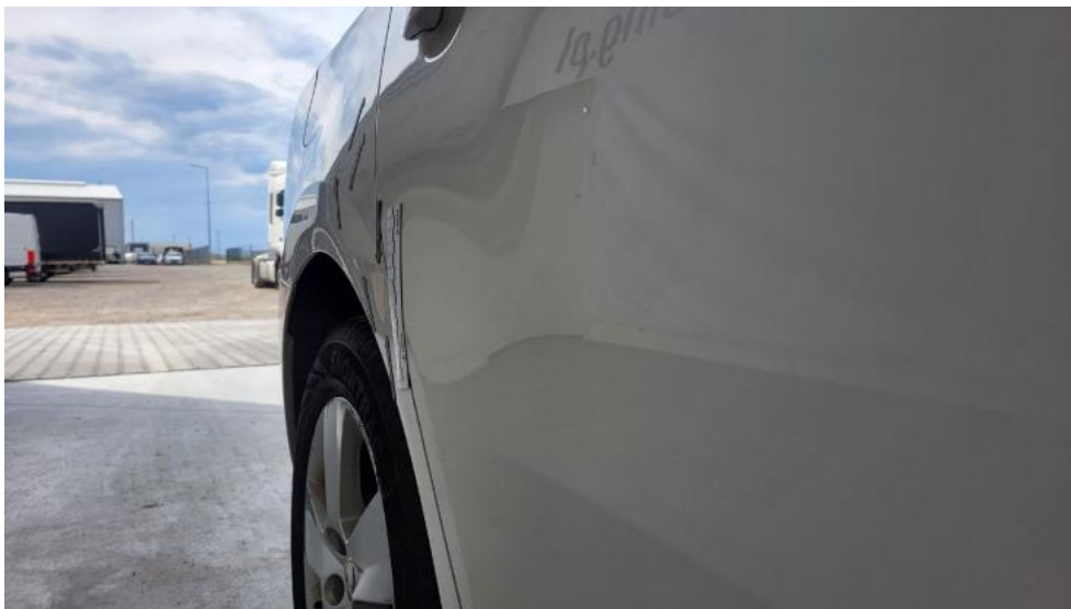
Fot. 65. Błotnik tylny P / Ściana boczna P - Wgniecenie/odkształcenie 2
