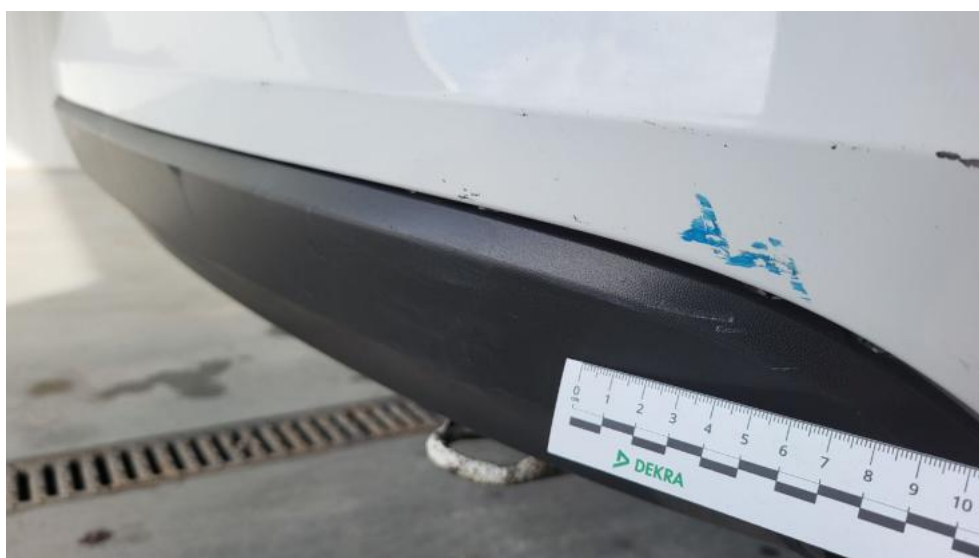
Fot. 76. Zderzak tylny cz dolna - Rysa/odprysk 1
