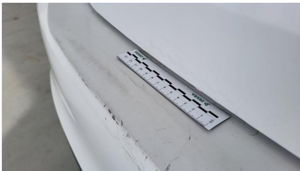
Fot. 75. Zderzak tylny - Pęknięcie/rozerwanie 1
