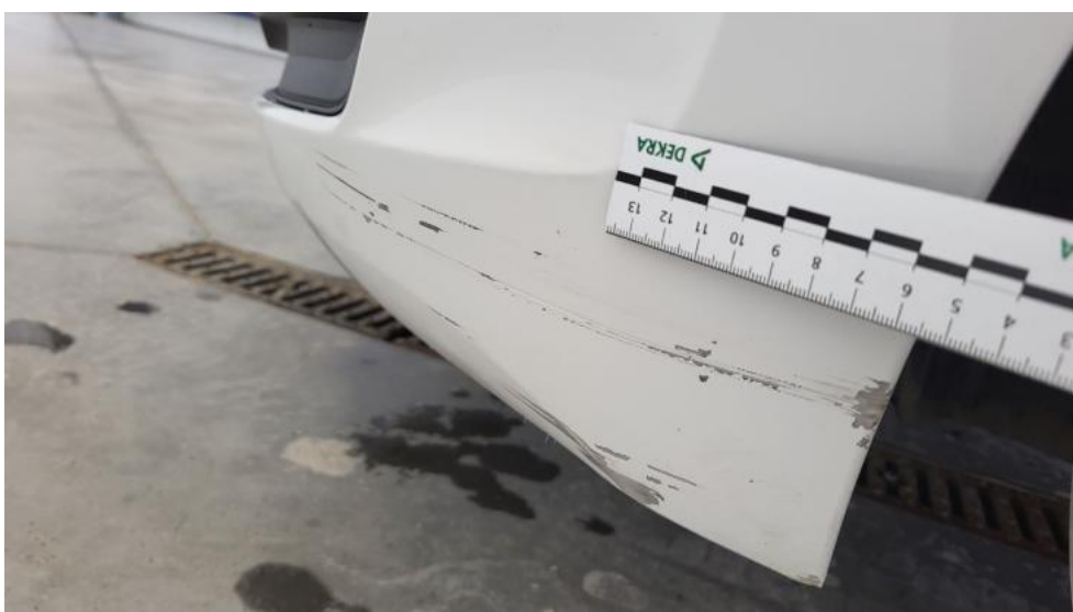
Fot. 48. Zderzak - Rysa/odprysk 1
