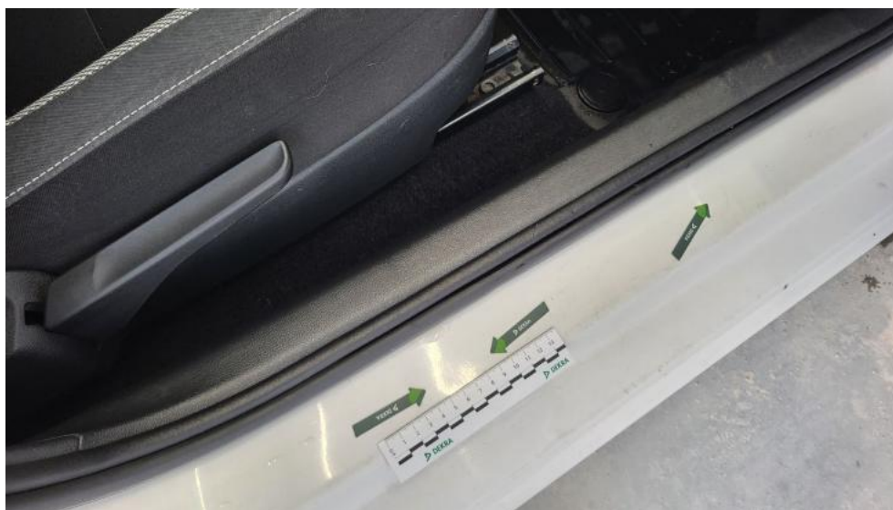
Fot. 59. Próg P - Wgniecenie/odkształcenie 1
