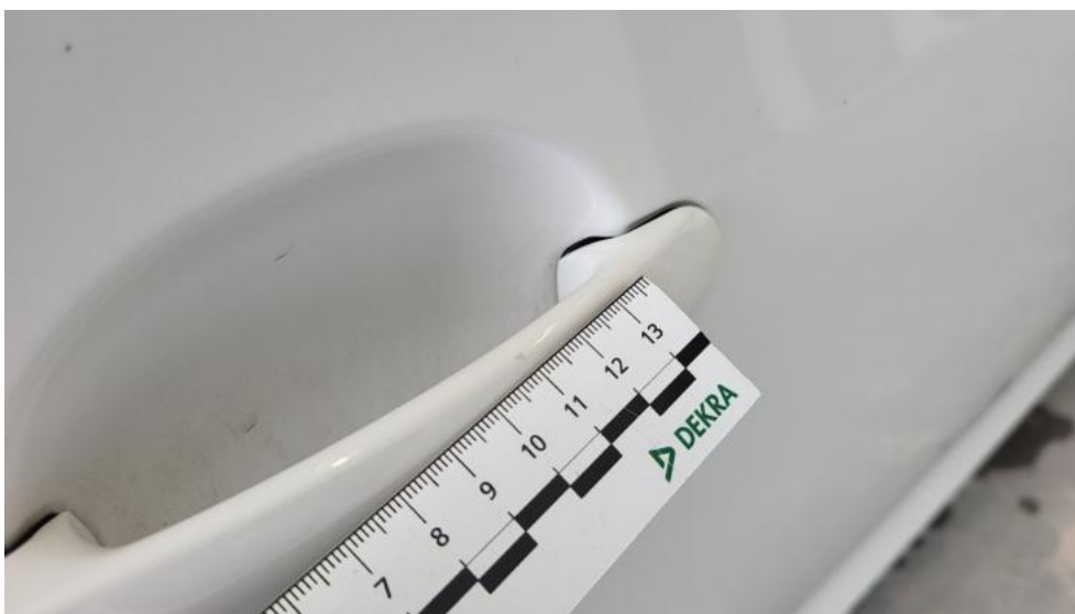
Fot. 56. Klamka drzwi prz P - Rysa/odprysk 1
