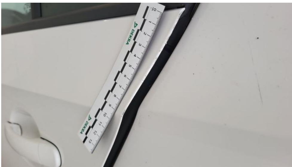
Fot. 85. Drzwi tylne L - Rysa/odprysk 1
