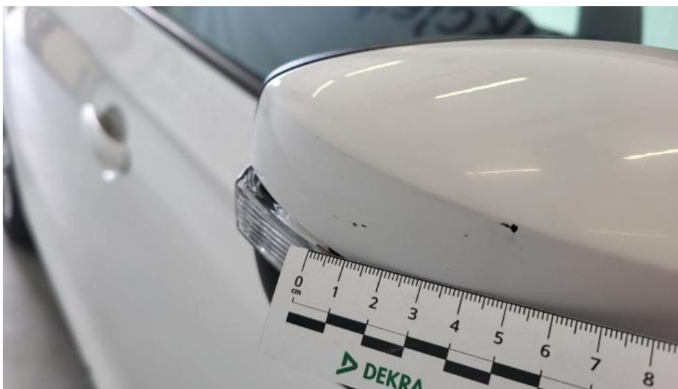
Fot. 57. Lusterko zew P - Rysa/odprysk 1
