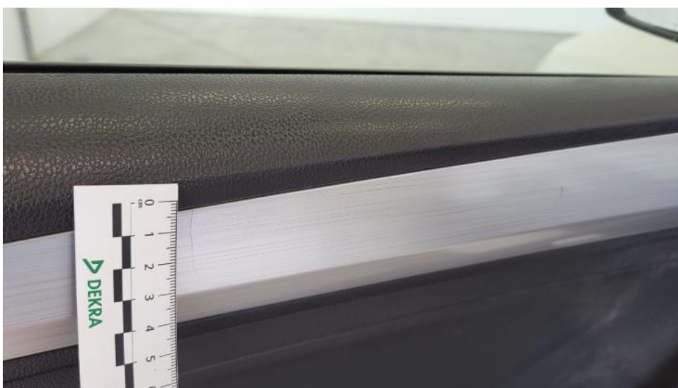
Fot. 104. Tapicerka drzwi przednich L - Pęknięcie/rozerwanie 1
