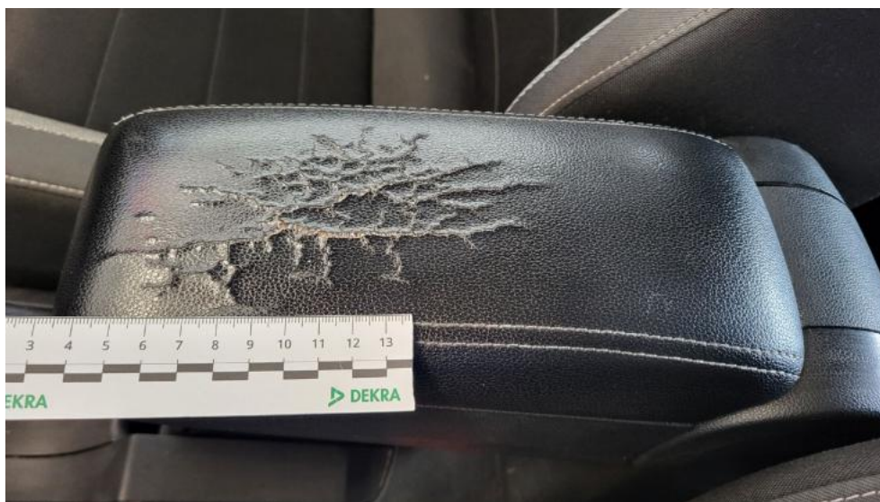
Fot. 99. Podłokietnik środkowy przedni - Pęknięcie/rozerwanie 1
