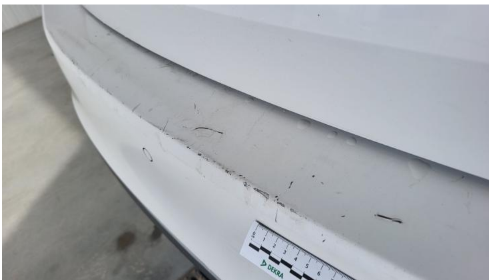
Fot. 71. Zderzak tylny - Rysa/odprysk 2
