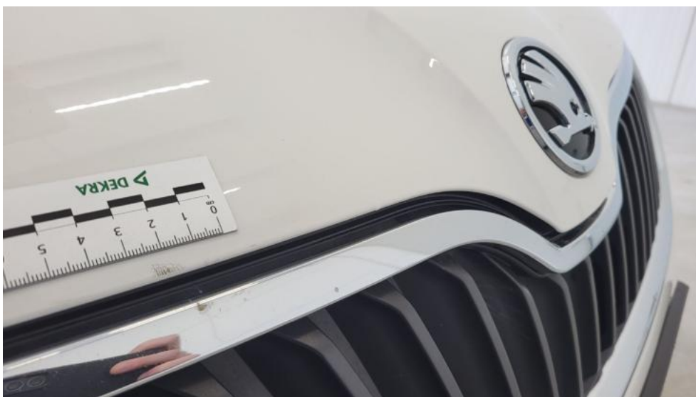
Fot. 44. Pokrywa komory silnika - Rysa/odprysk 1
