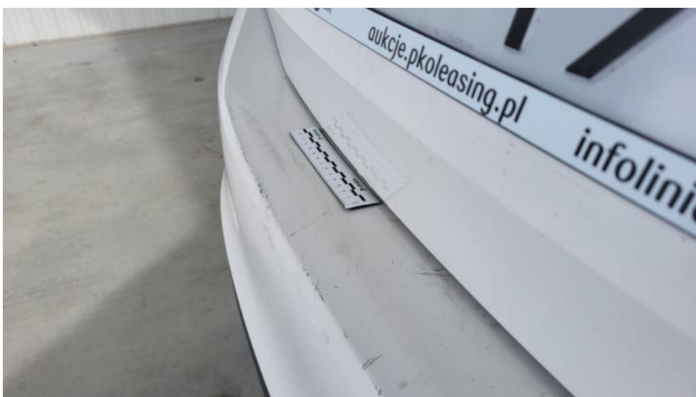
Fot. 72. Zderzak tylny - Wgniecenie/odkształcenie 1
