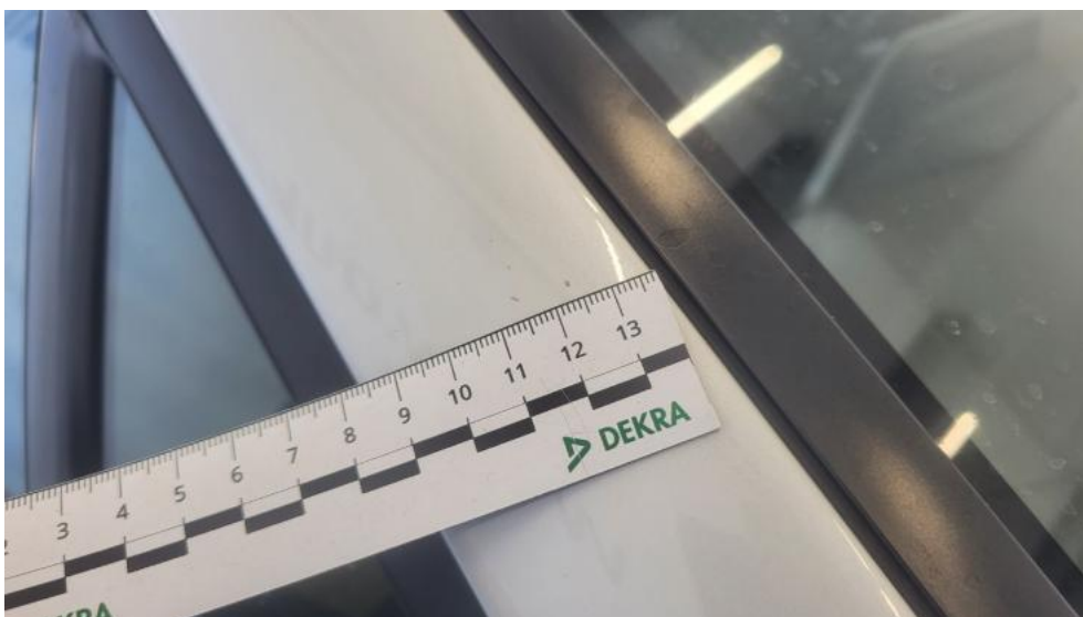
Fot. 60. Słupek przedni P - Rysa/odprysk 1
