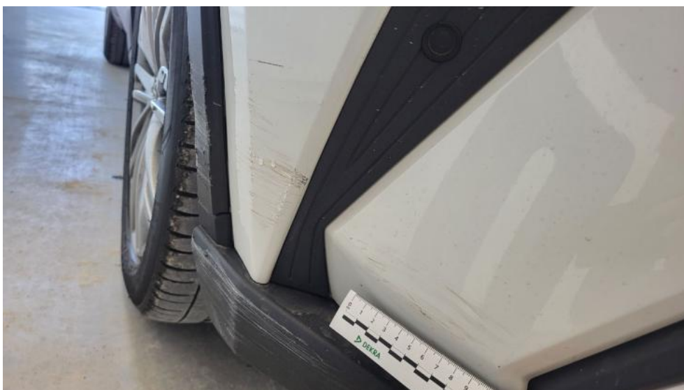
Fot. 46. Zderzak - Rysa/odprysk 1
