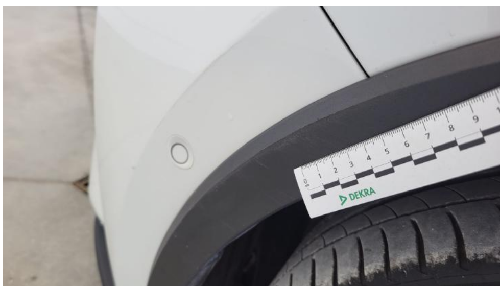
Fot. 76. Listwa krawędzi błotnika prz L - Rysa/odprysk 1
