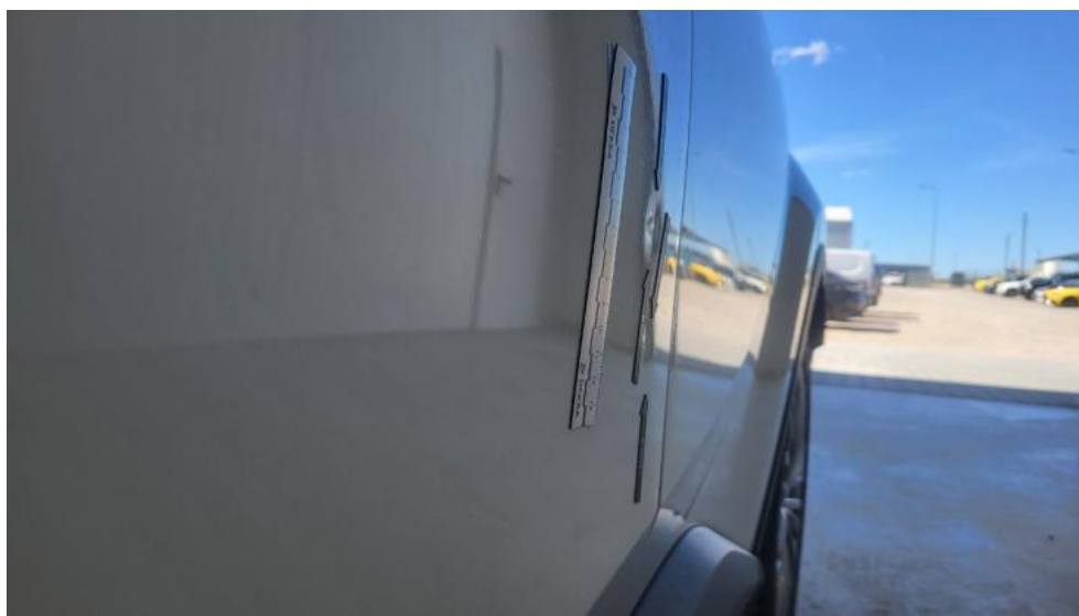
Fot. 71. Drzwi przed L - Wgniecenie/odkształcenie 1
