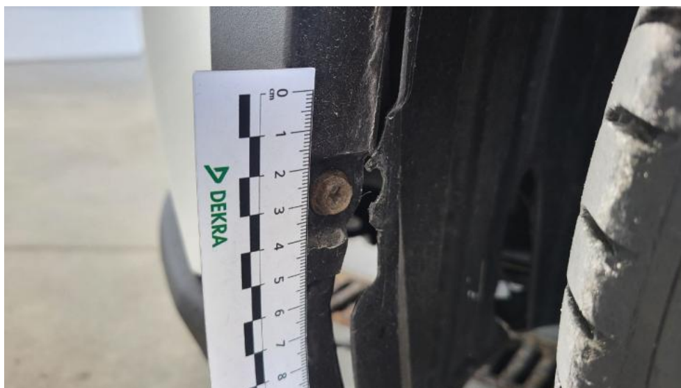
Fot. 77. Nadkole przednie L - Pęknięcie/rozerwanie 1
