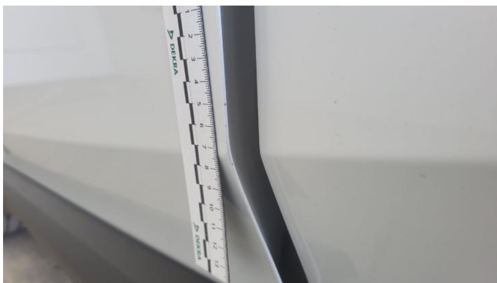
Fot. 70. Drzwi przed L - Rysa/odprysk 1
