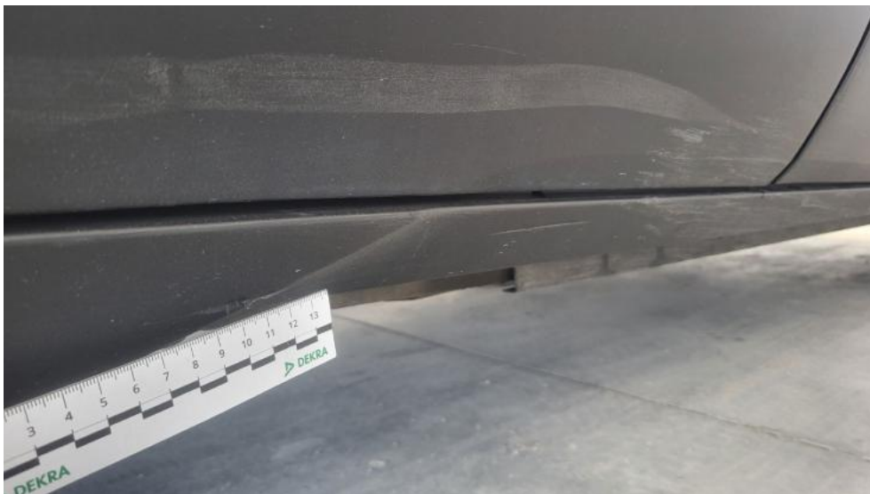
Fot. 59. Próg P - Rysa/odprysk 1
