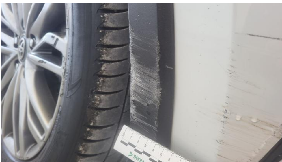
Fot. 54. Listwa krawędzi błotnika prz P - Rysa/odprysk 1
