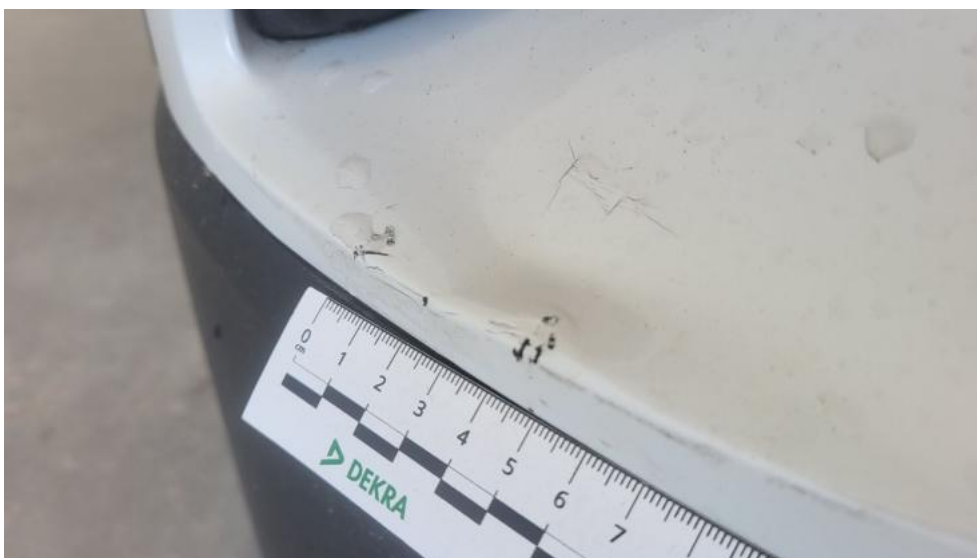
Fot. 66. Zderzak tylny - Pęknięcie/rozerwanie 1
