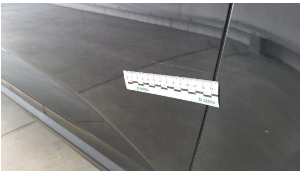
Fot. 50. Drzwi przednie P - Rysa/odprysk 1
