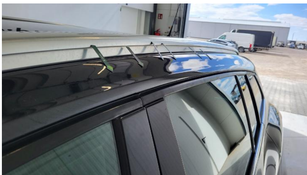
Fot. 70. Błotnik tylny L / Ściana boczna L - Wgniecenie/odkształcenie 1
