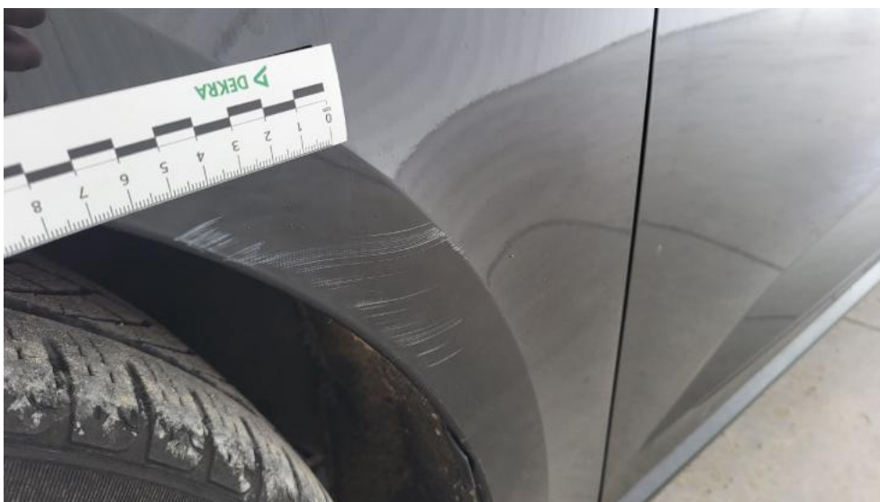
Fot. 84. Błotnik przedni L - Rysa/odprysk 1
