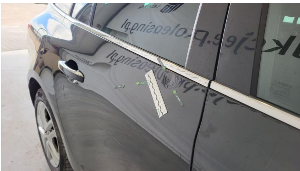
Fot. 55. Drzwi tylne P - Wgniecenie/odkształcenie 1
