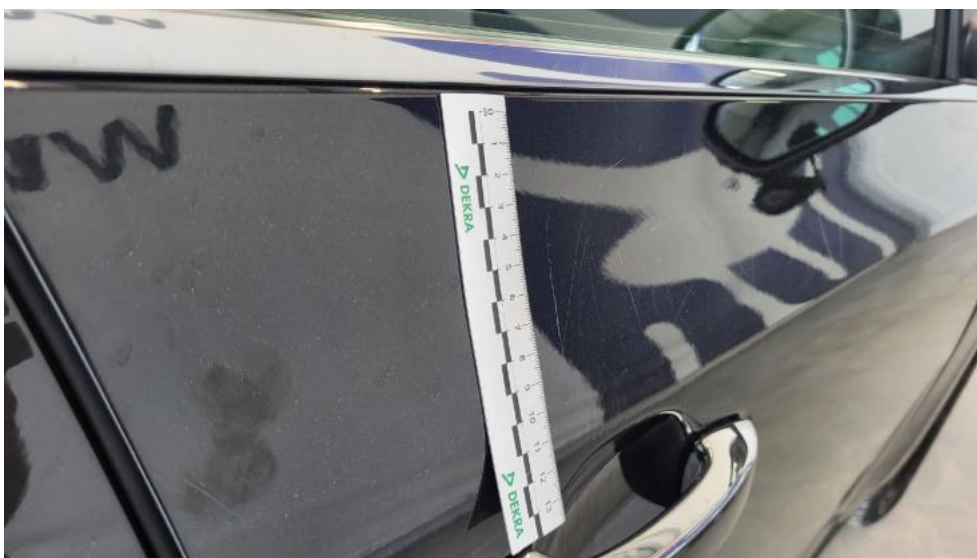
Fot. 52. Drzwi przednie P() - Rysa/odprysk 3
