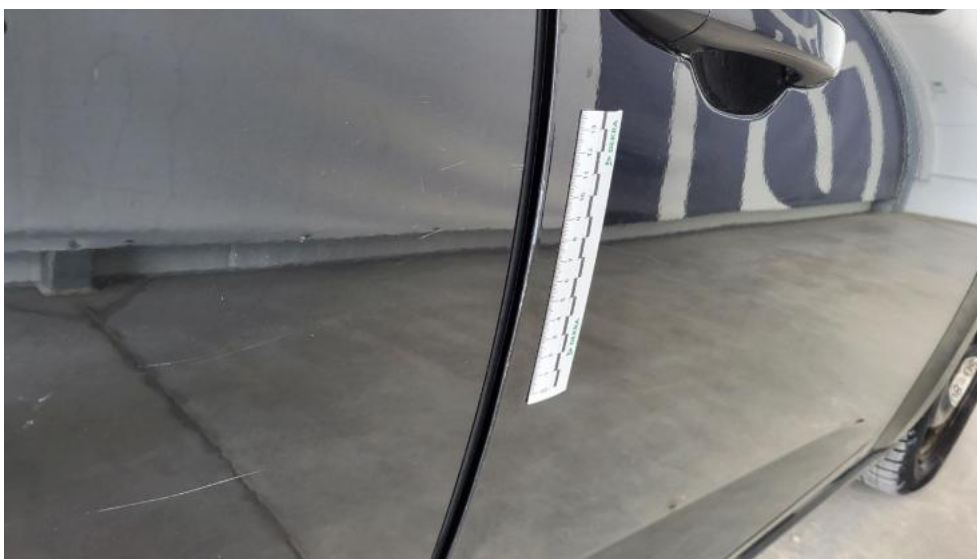
Fot. 51. Drzwi przednie P - Rysa/odprysk 2
