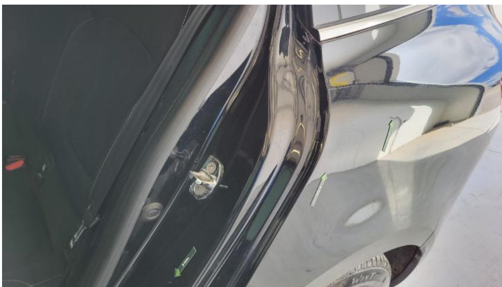
Fot. 72. Błotnik tylny L / Ściana boczna L() - Wgniecenie/odkształcenie 3
