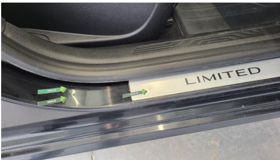
Fot. 56. Próg P - Wgniecenie/odkształcenie 1
