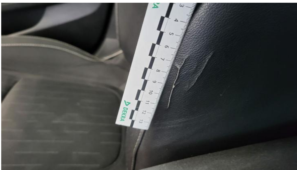
Fot. 91. Fotel prz. praw. - Pęknięcie/rozerwanie 1
