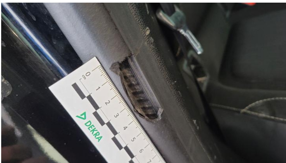
Fot. 96. Uszczelka drzwi tylnych P - Pęknięcie/rozerwanie 1
