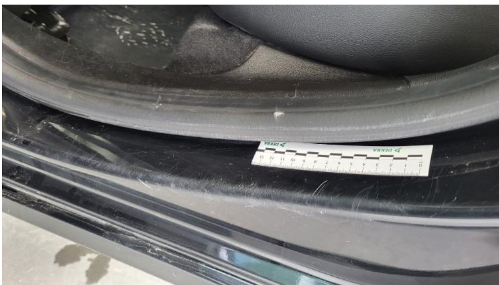
Fot. 81. Próg L - Rysa/odprysk 1
