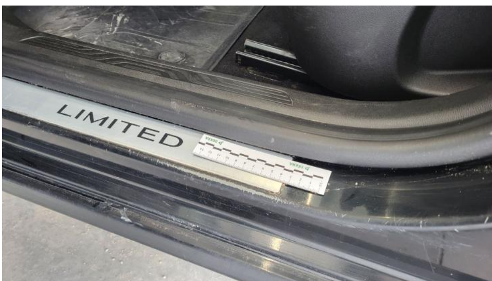
Fot. 82. Próg L - Rysa/odprysk 2
