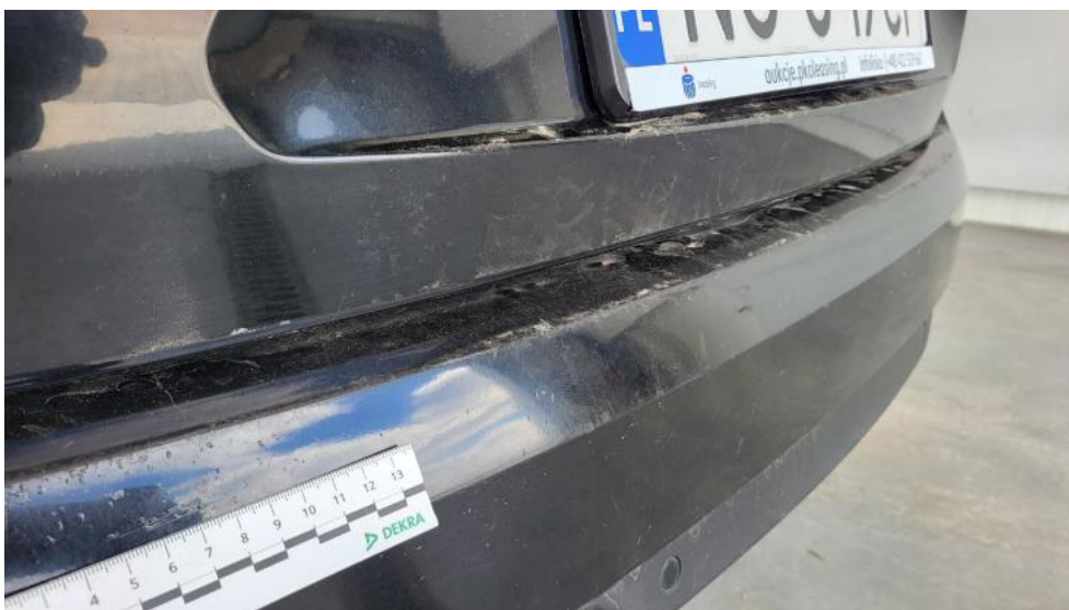
Fot. 66. Zderzak tylny - Rysa/odprysk 2
