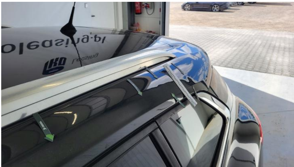
Fot. 71. Błotnik tylny L / Ściana boczna L - Wgniecenie/odkształcenie 2
