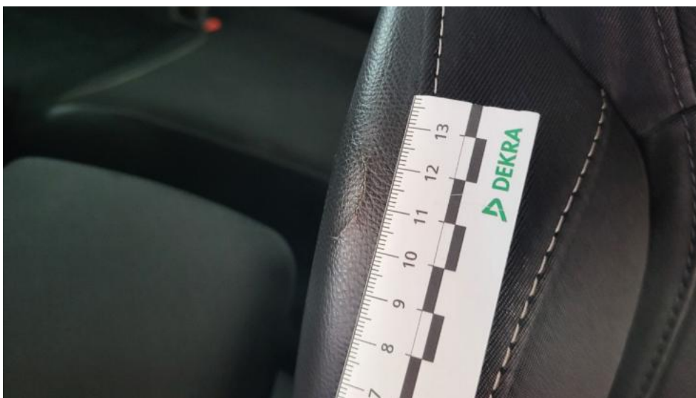
Fot. 89. Fotel prz. lew. - Pęknięcie/rozerwanie 1
