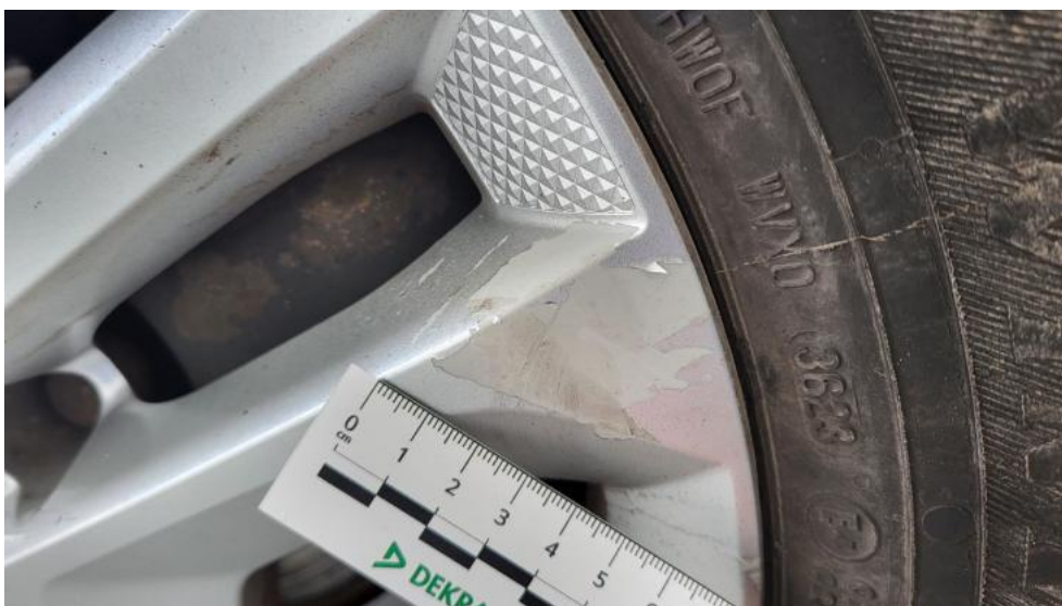
Fot. 60. Kołpak tylny P - Rysa/odprysk 1
