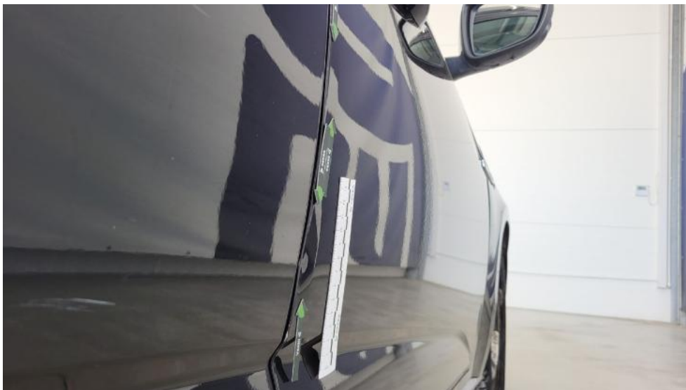
Fot. 53. Drzwi przednie P - Wgniecenie/odkształcenie 1
