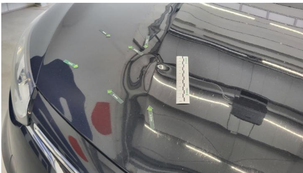
Fot. 39. Pokrywa komory silnika - Wgniecenie/odkształcenie 1
