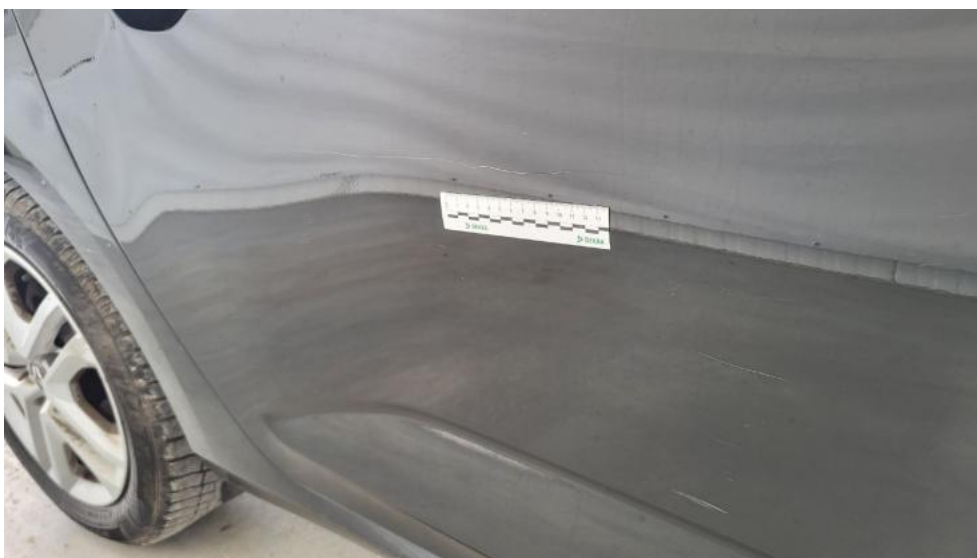
Fot. 54. Drzwi tylne P - Rysa/odprysk 1
