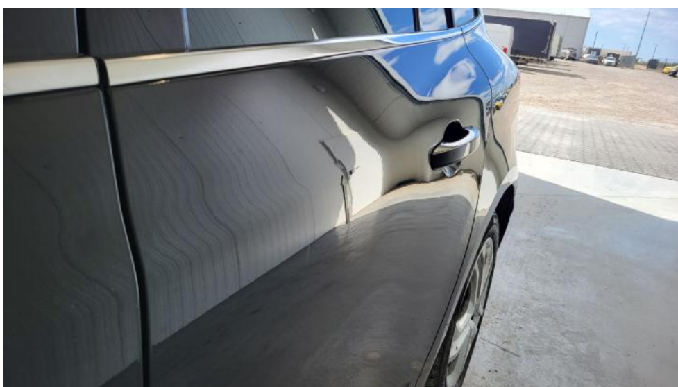
Fot. 80. Drzwi tylne L - Wgniecenie/odkształcenie 1
