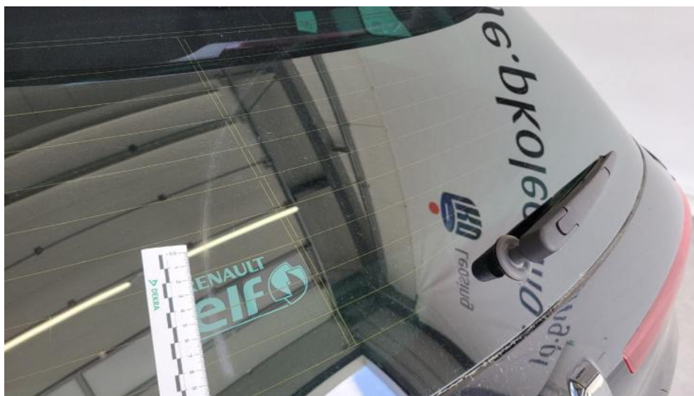
Fot. 63. Szyba tylna - Rysa/odprysk 1
