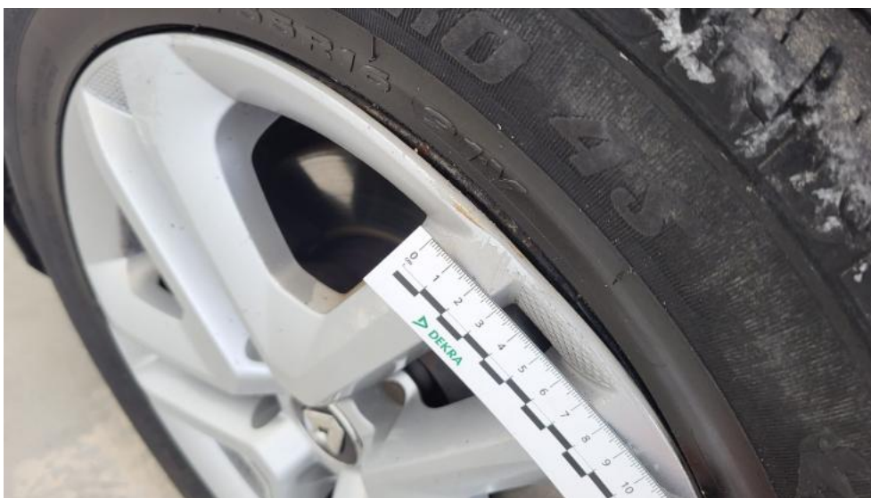
Fot. 85. Kołpak przedni L - Wgniecenie/odkształcenie 1
