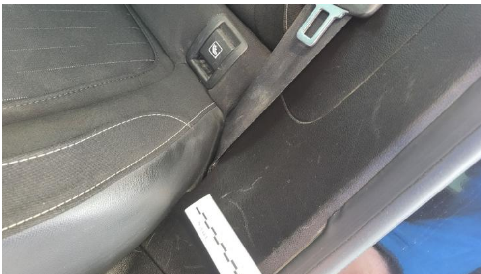
Fot. 100. Wykładzina(y) słupka tylnego L - Rysa/odprysk 1
