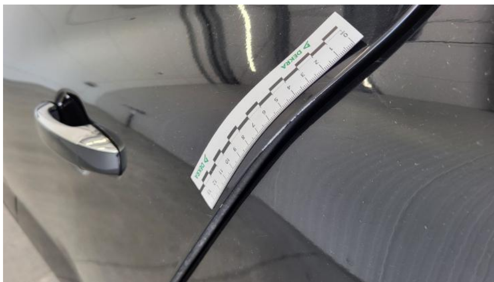
Fot. 78. Drzwi tylne L - Rysa/odprysk 1
