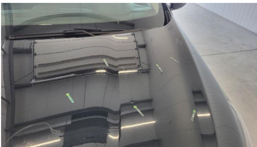
Fot. 40. Pokrywa komory silnika - Wgniecenie/odkształcenie 2
