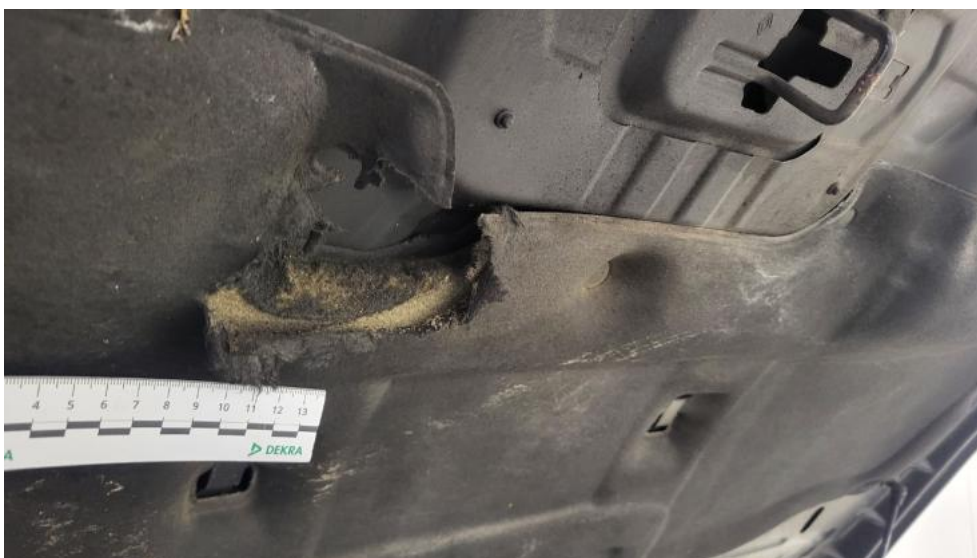
Fot. 42. Wykładzina pokrywy komory silnika - Pęknięcie/rozerwanie 1
