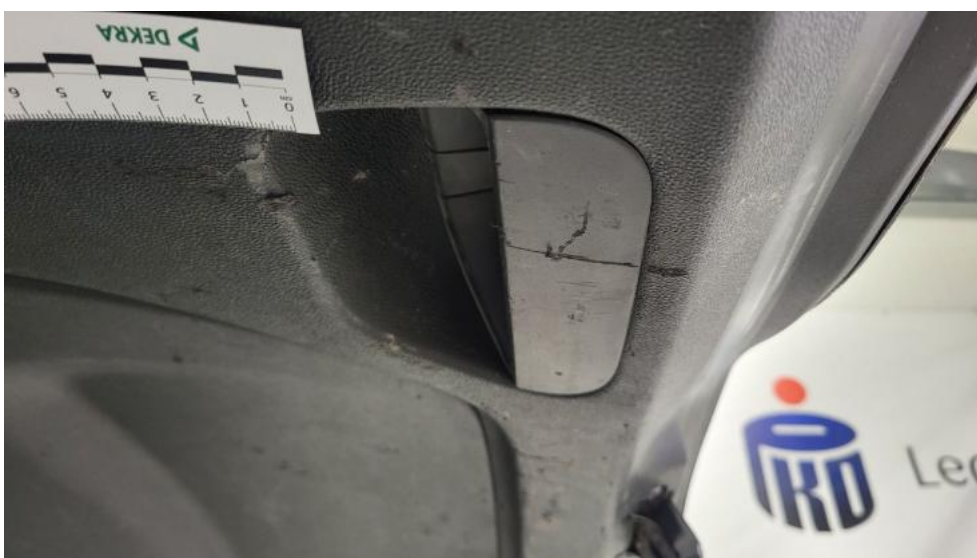
Fot. 108. Wykładzina pokrywy tylnej - Rysa/odprysk 1
