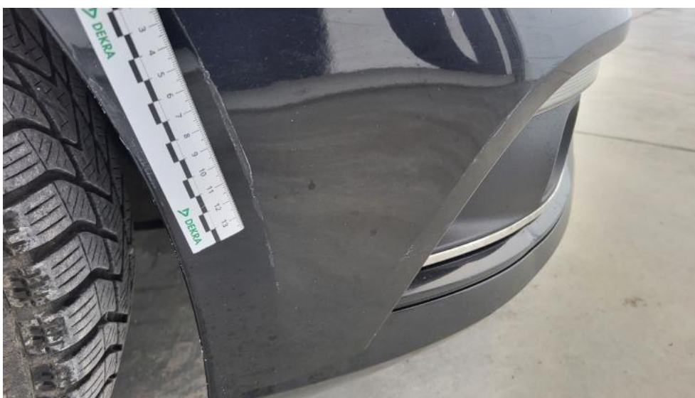
Fot. 44. Zderzak - Rysa/odprysk 2
