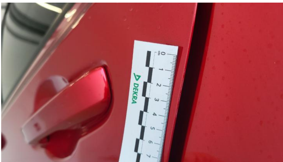
Fot. 45. Drzwi tylne L - Rysa/odprysk 1
