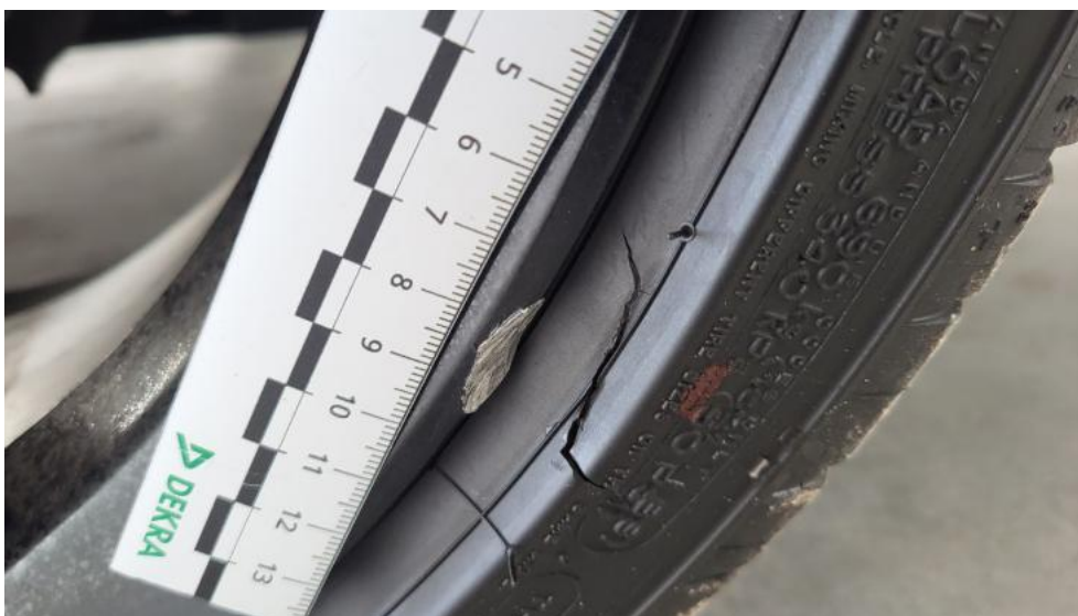
Fot. 41. Felga aluminiowa przednia P - Rysa/odprysk 1
