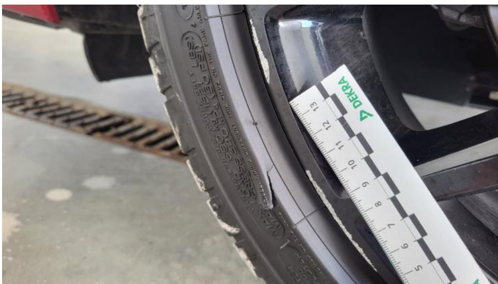
Fot. 46. Felga Aluminiowa przednia L - Rysa/odprysk 1
