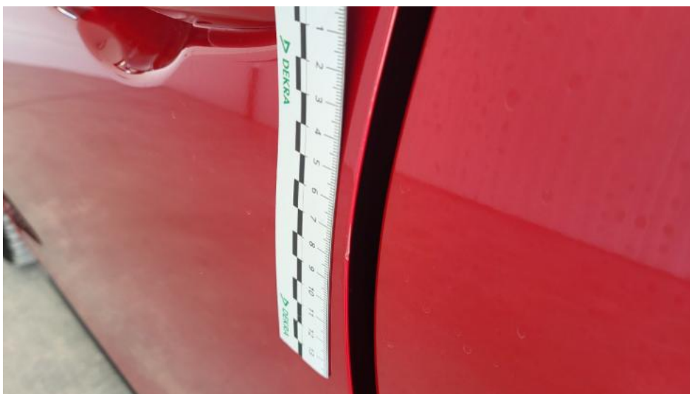
Fot. 44. Drzwi przed L - Rysa/odprysk 1
