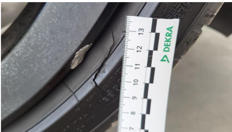
Fot. 42. Opona przednia P - Pęknięcie/rozerwanie 1
