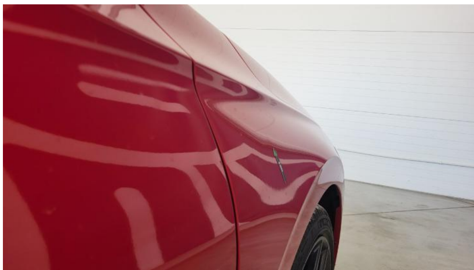
Fot. 40. Błotnik przedni P - Wgniecenie/odkształcenie 1
