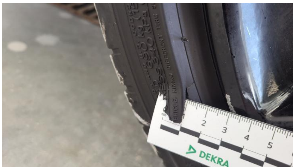
Fot. 47. Opona przednia L - Pęknięcie/rozerwanie 1
