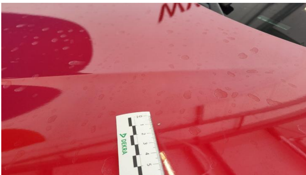
Fot. 36. Pokrywa komory silnika - Rysa/odprysk 1
