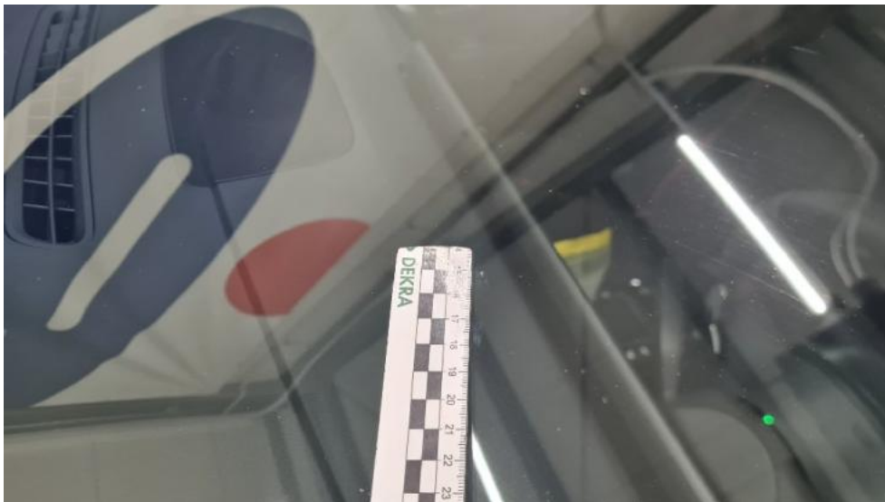
Fot. 25. Szyba czołowa (Rysa/Odprysk)
