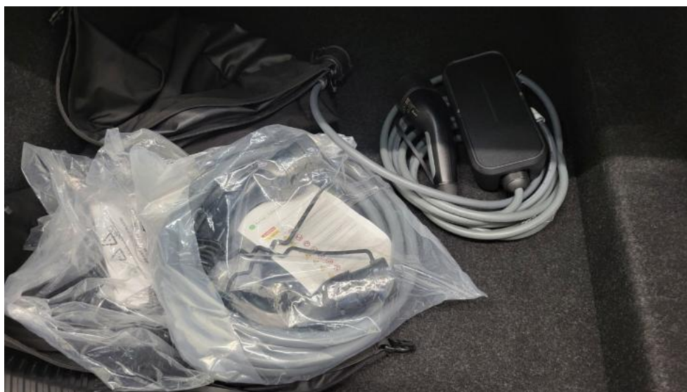
Fot. 34. Przewód ładowania baterii trakcyjnej
