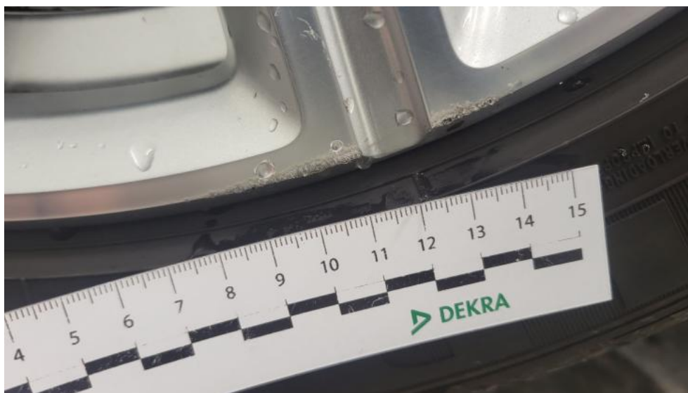
Fot. 67. Felga Aluminiowa przednia L - Rysa/odprysk 1
