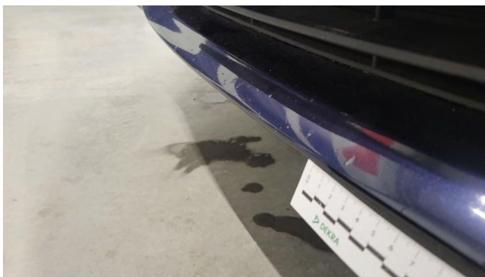
Fot. 46. Zderzak przedni cz dolna - Rysa/odprysk 1
