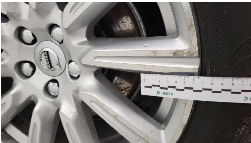
Fot. 61. Felga aluminiowa tylna L - Rysa/odprysk 1
