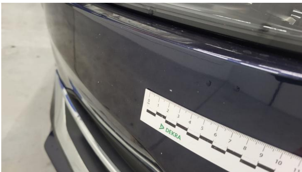
Fot. 44. Zderzak - Rysa/odprysk 1
