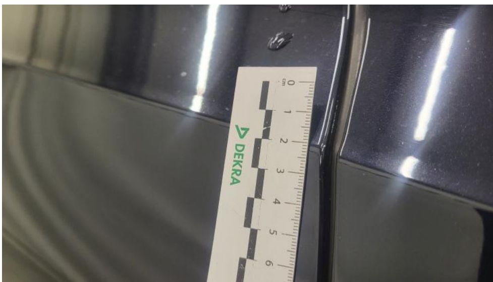
Fot. 53. Drzwi tylne P - Rysa/odprysk 1
