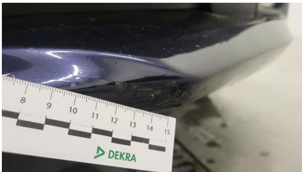
Fot. 49. Zderzak przedni cz dolna - Pęknięcie/rozerwanie 1
