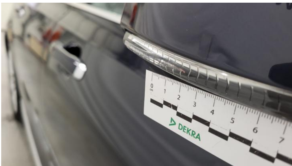
Fot. 54. Lusterko zew P - Rysa/odprysk 1
