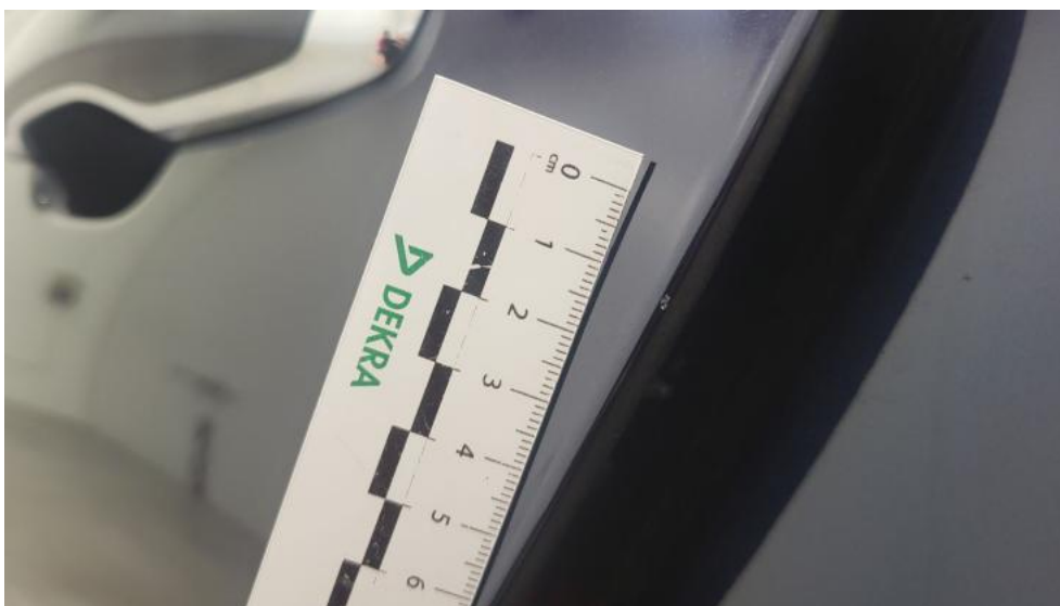
Fot. 65. Drzwi tylne L - Rysa/odprysk 1
