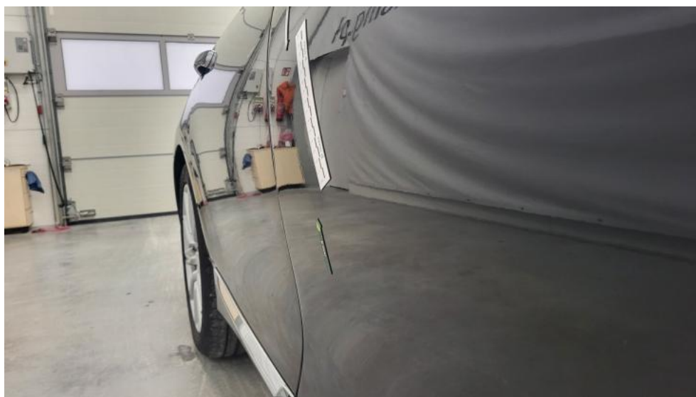
Fot. 52. Drzwi przednie P - Wgniecenie/odkształcenie 1
