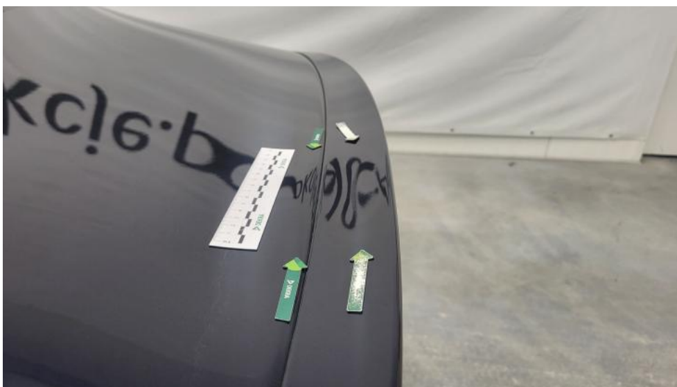
Fot. 60. Pokrywy bagażnika - Wgniecenie/odkształcenie 1
