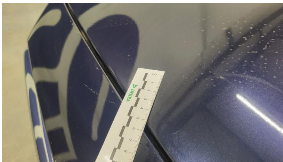
Fot. 42. Pokrywa komory silnika - Rysa/odprysk 1
