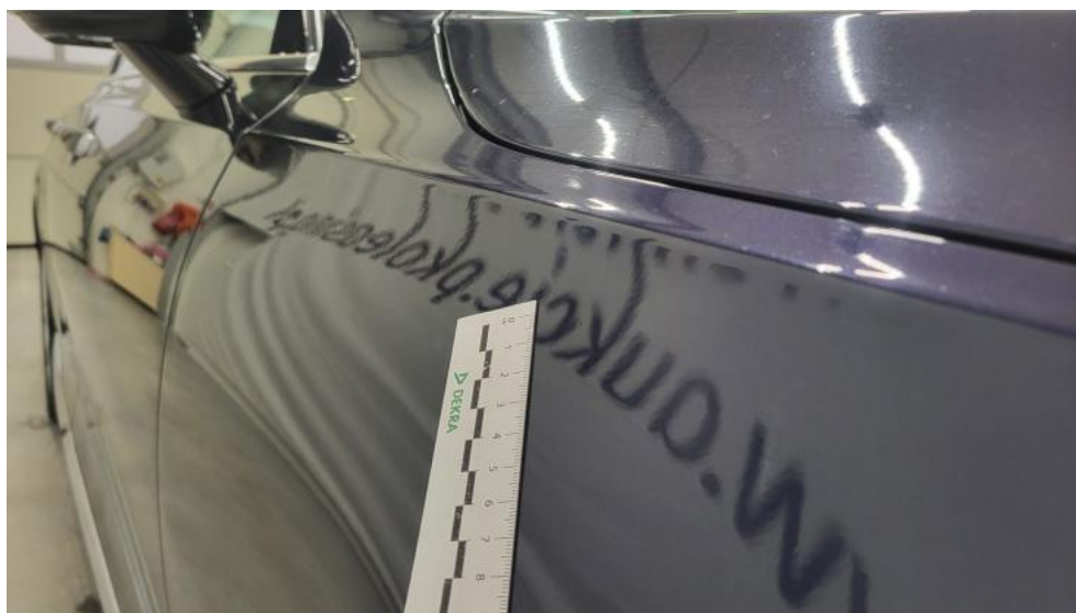
Fot. 50. Błotnik przedni P - Wgniecenie/odkształcenie 1
