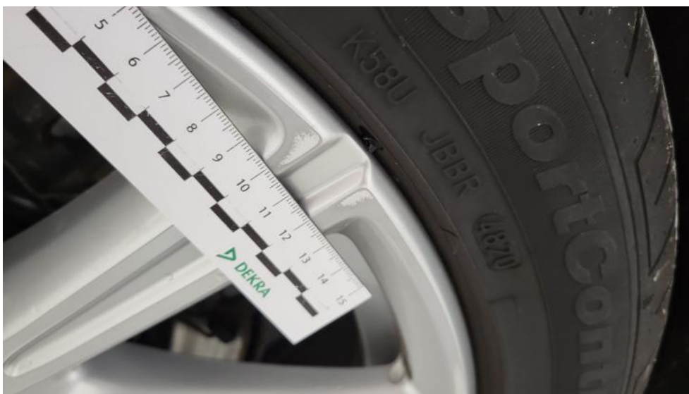
Fot. 59. Felga aluminiowa tylna P - Rysa/odprysk 1
