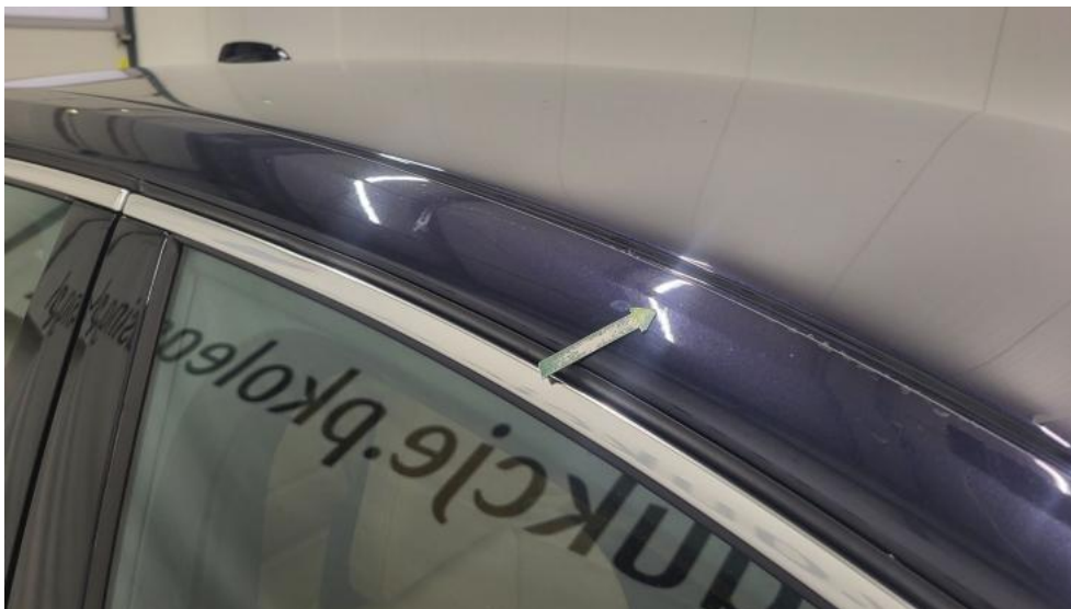
Fot. 55. Stupek przedni P - Wgniecenie/odkształcenie 1
