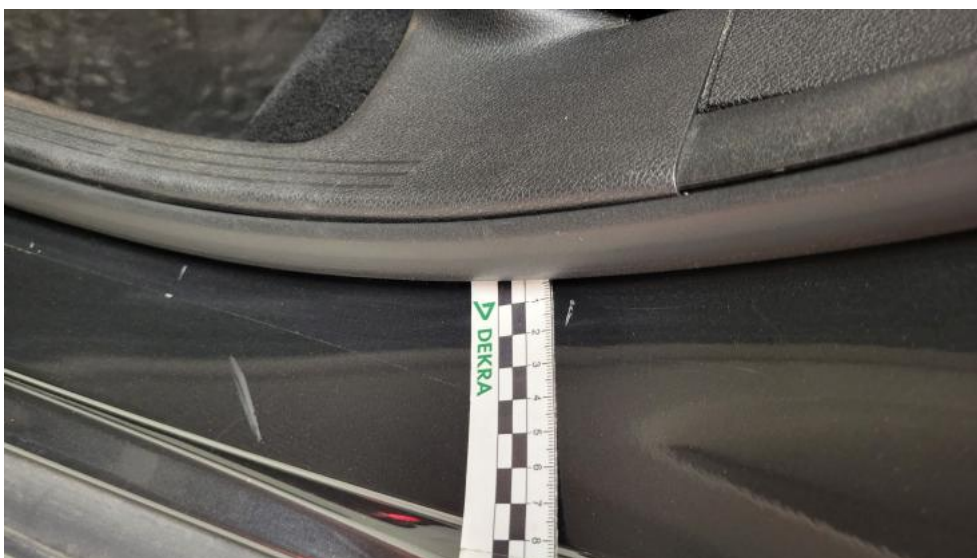
Fot. 60. Próg L - Rysa/odprysk 1
