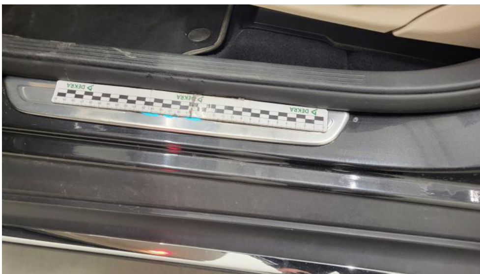
Fot. 61. Próg L - Rysa/odprysk 2
