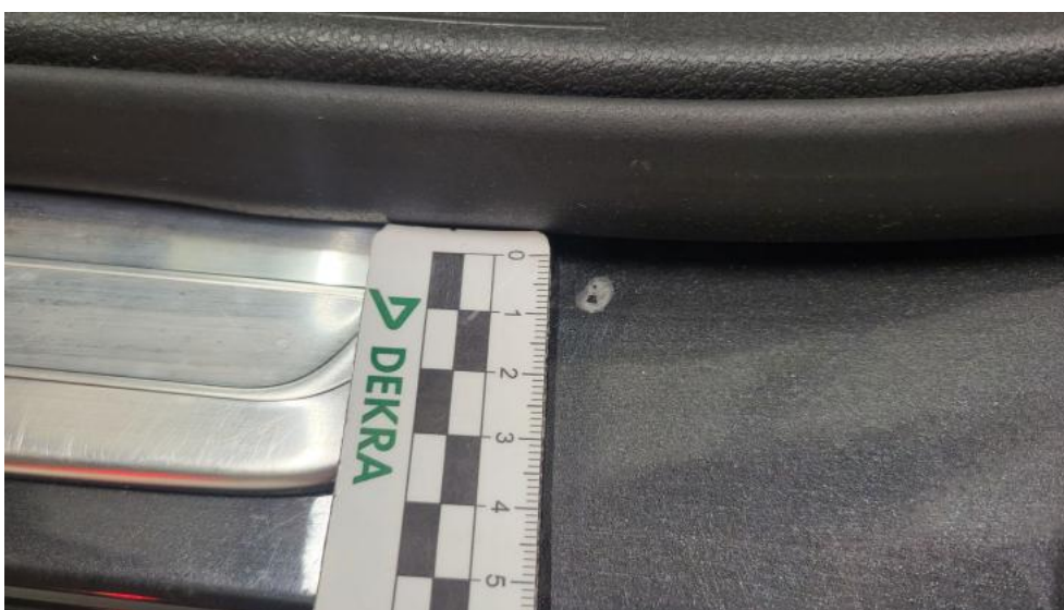
Fot. 62. Próg L() - Rysa/odprysk 3
